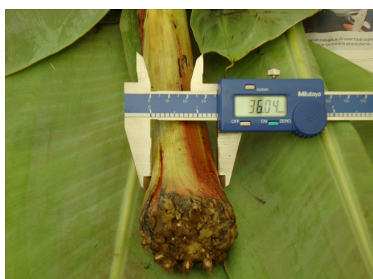
Fotos 11 y 12. Medición de diámetro de pseudotallo y partición de plantas para su secado
