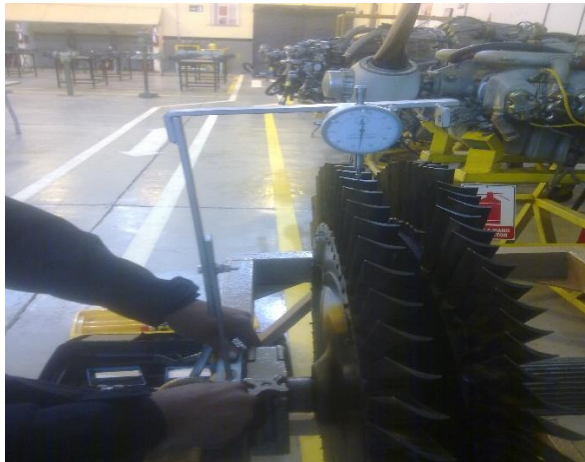
Figura 16. Comprobación de los Parámetros y Tolerancias en elongación.
