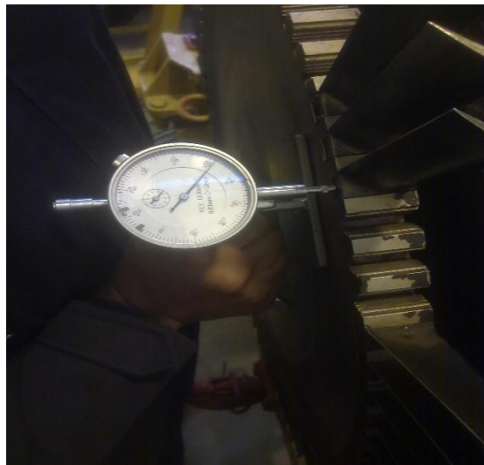
Figura 15. Comprobación de los Parámetros y Tolerancias en posición o juego axial.
