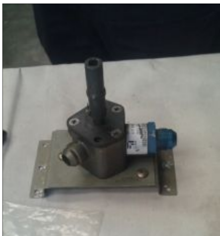
Figura 29. Limpieza válvula selectora.
