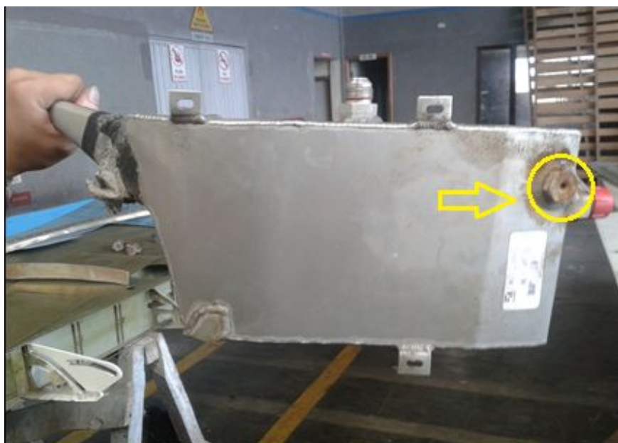
Figura 51. Estado de las válvulas de drenaje.
