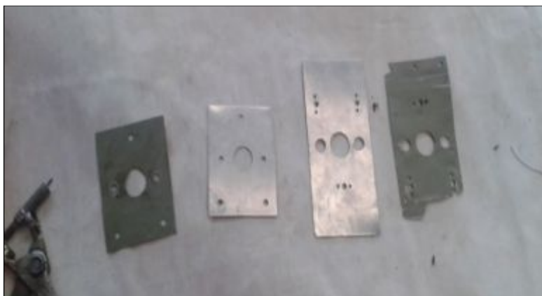
Figura 55. Acabados de la nueva base de válvula selector.
