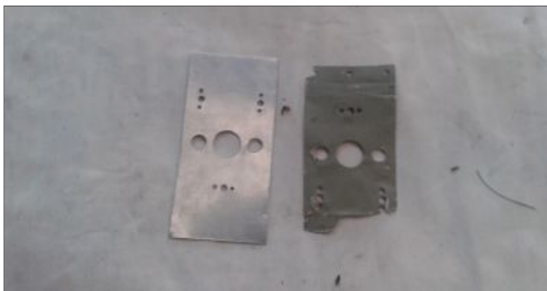
Figura 54. Construcción de la base de la válvula selector de combustible.
