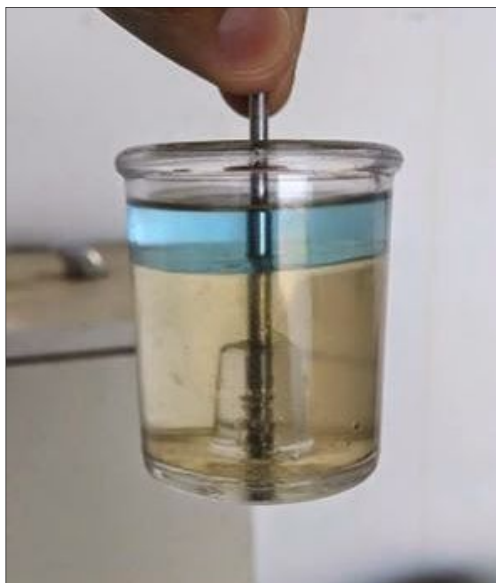
Figura 17. Combustible contaminado con agua.
