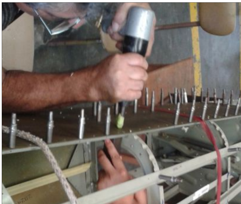
Figura 47. Remachado de las Láminas.
