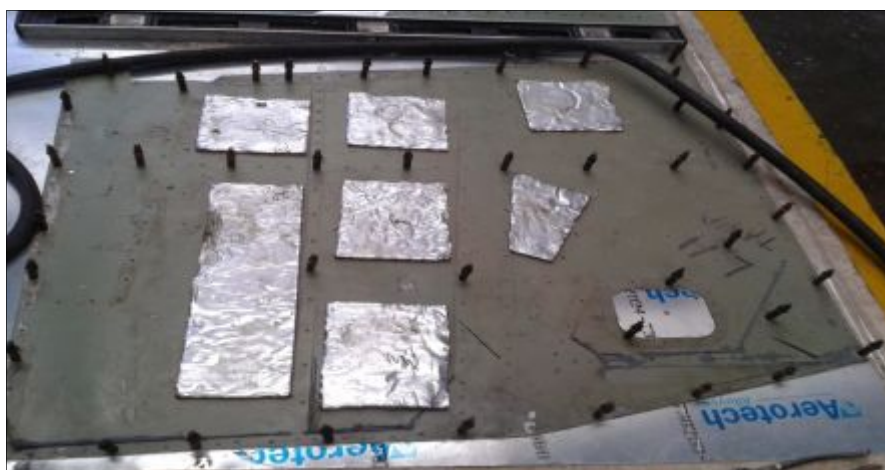
Figura 40. Perforación y puesta de glicos.
