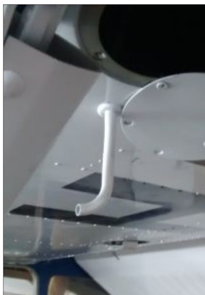
Figura 58. Ducto de ventilación.
