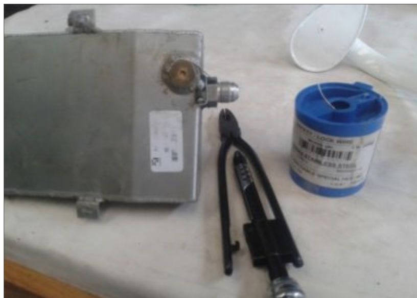
Figura 52. Frenado de las válvulas de drenaje.
