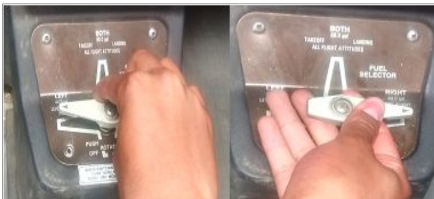
Figura 68. Verificación de funcionamiento de válvula selectora.
