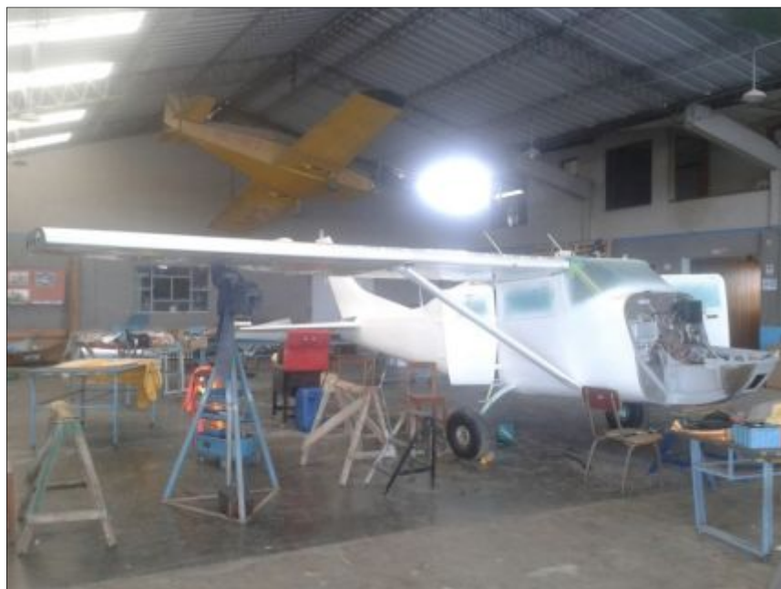
Figura 62. Instalación del ala y strut.
