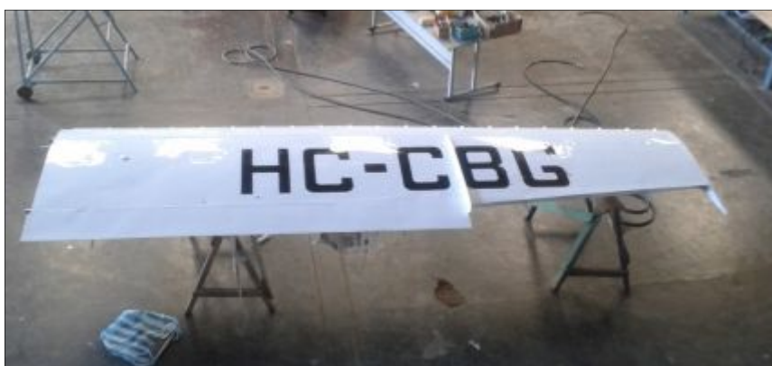
Figura 48. Reparación finalizada del tanque derecho.
