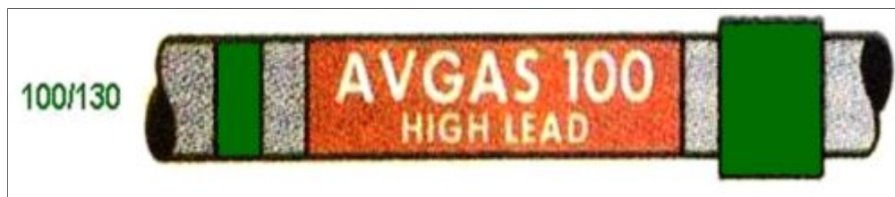
Figura 19. Especificación del combustible en cañerías.
