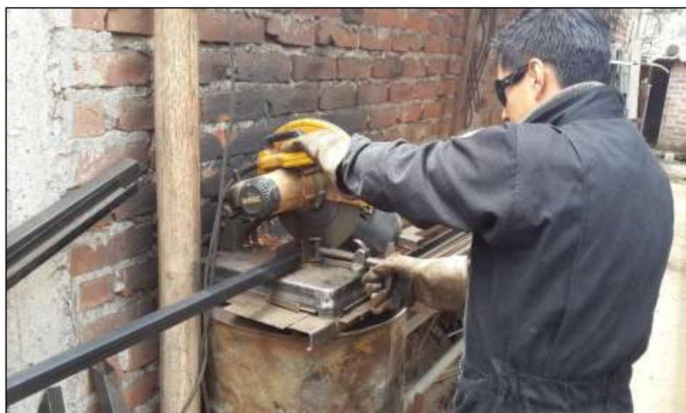
**Figura 33.** Corte de tubo para soporte
