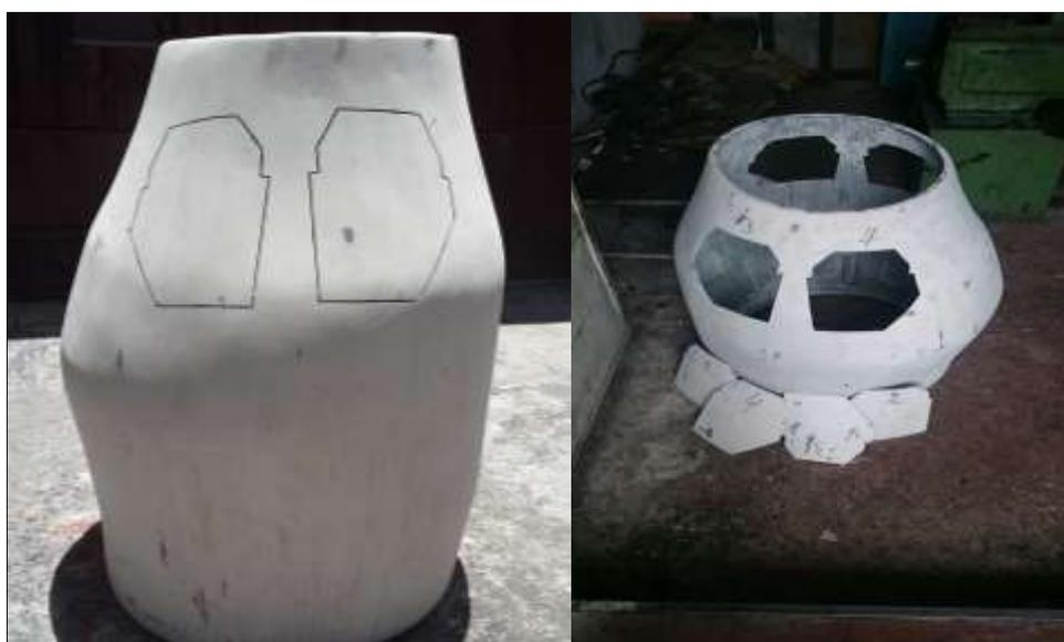
**Figura 23.** Compuertas marcadas y cortadas
