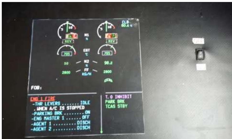
**Figura 40.** Luz de indicación de la reversa
