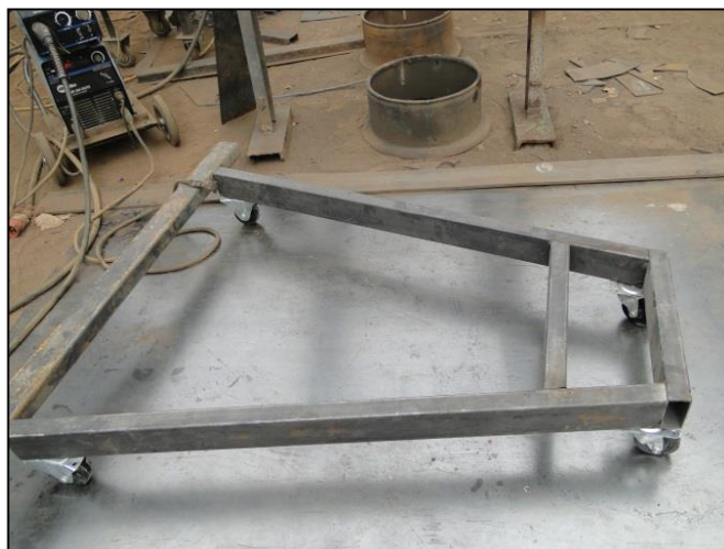
Figura 39. Base del brazo hidráulico terminado
