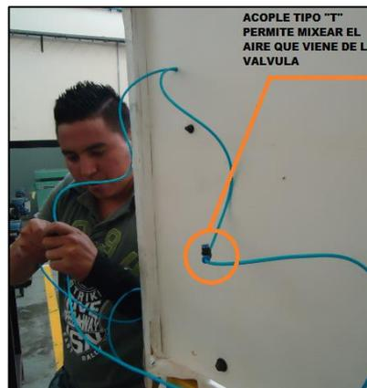
**Figura 56.** Referencia de posición del acople tipo t.
