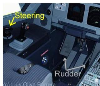
**Figura 29.** Posición del Steering en la cabina.
