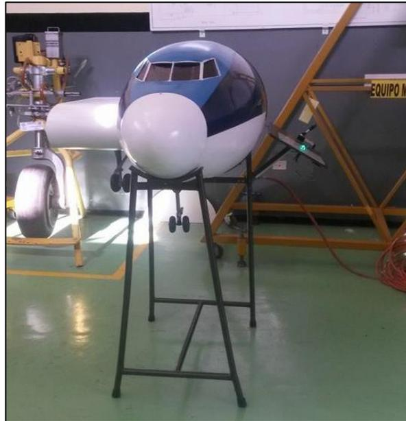
**Figura 42.** Maqueta de retracción y extensión del avión EMBRAER 190.
