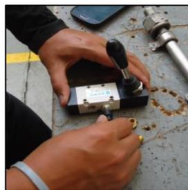
**Figura 55.** Válvula de control 5/2.
