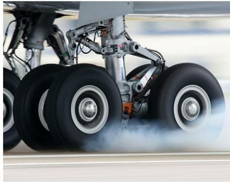
**Figura 27.** Neumáticos de un tren de aterrizaje.
