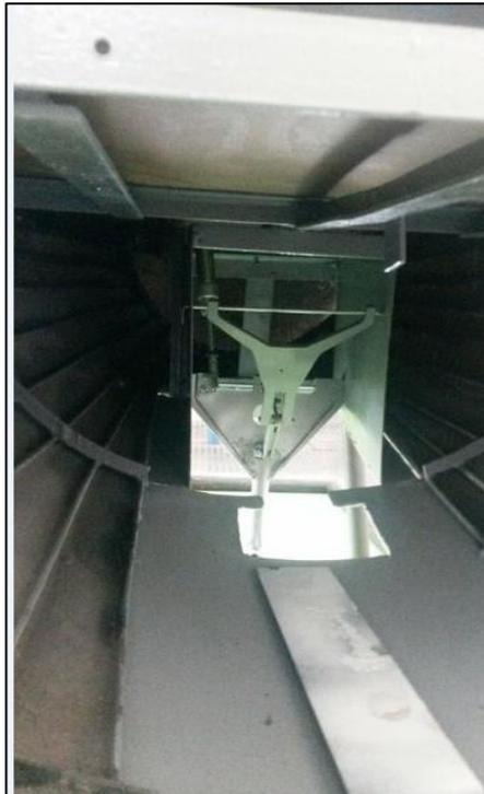
**Figura 59.** Conexión del tren de nariz al actuador.
