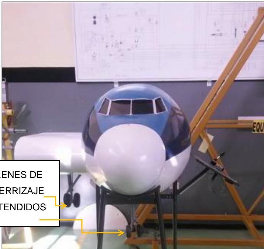
3.2 Determinar si el sistema neumático está alimentado, o se encuentra conectado, este sistema posee un conjunto de limitadores de flujo en las válvulas de doble efecto por ello no necesitan poseer manómetro, mientras éstas no sean manipuladas, ésta puede ser operada en cualquier entrada neumática que posee como mínimo 40 PSI. Si el sistema está desconectado aliméntelo mediante el FITTING NEUMÁTICO que se encuentra en la parte posterior del equipo. Observe la imagen
