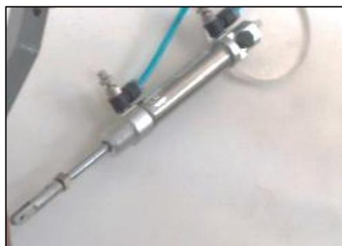
**Figura 54.** Cilindro doble efecto que actúa el sistema de trenes.
