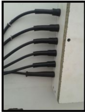
Figura. 68 Conexión de la magneto a los pernos
