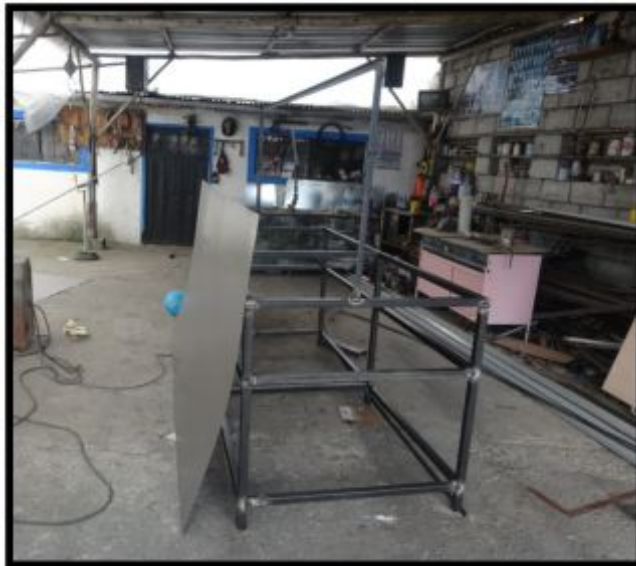
Figura. 49 Banco de prueba terminado el proceso de soldadura
