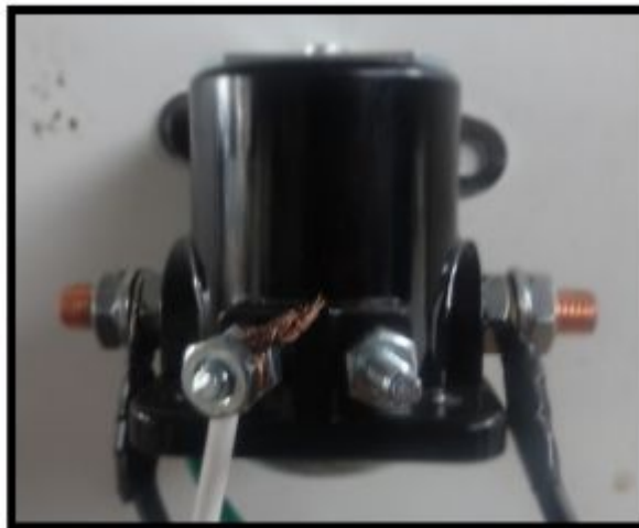
Figura. 79 Instalación del automático de arranque
