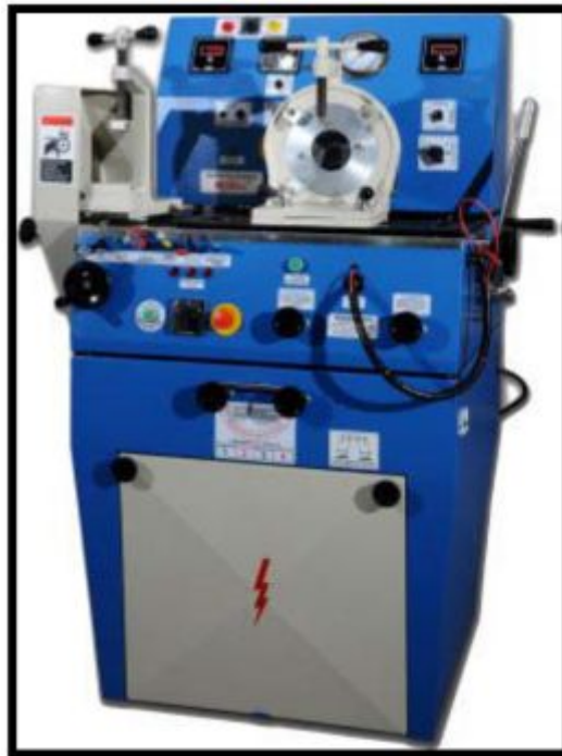
Figura. 46 Banco de pruebas doble alternador y motor de arranque serie AR5
