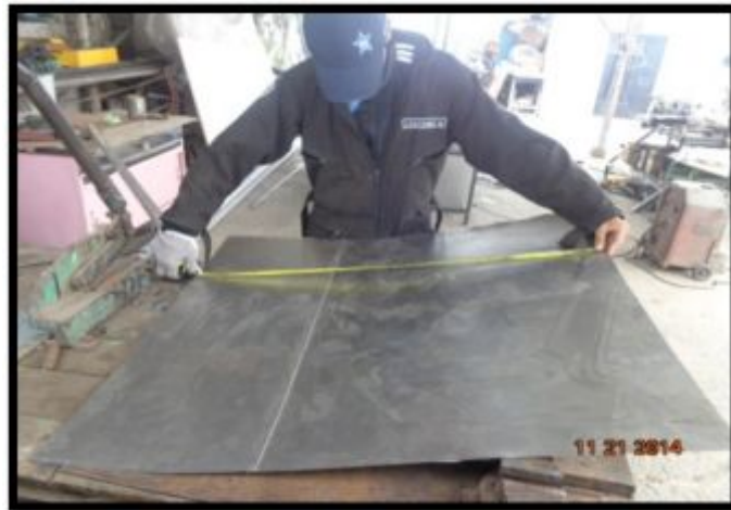
Figura. 51 Medición de la placa de tol
