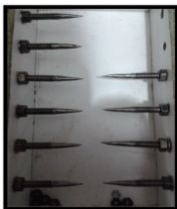
Figura. 67 Pernos limados acoplados a la base
