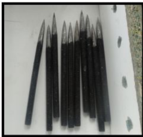
Figura. 66 Pernos limados para la transmisión de la chipa
