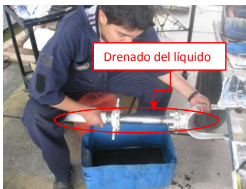
Figura 45. Drenado del líquido hidráulico del amortiguador.
