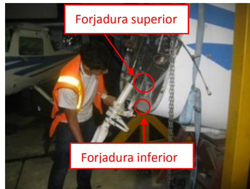
Figura 70. Montaje del amortiguador del tren de nariz, cessna 182.
