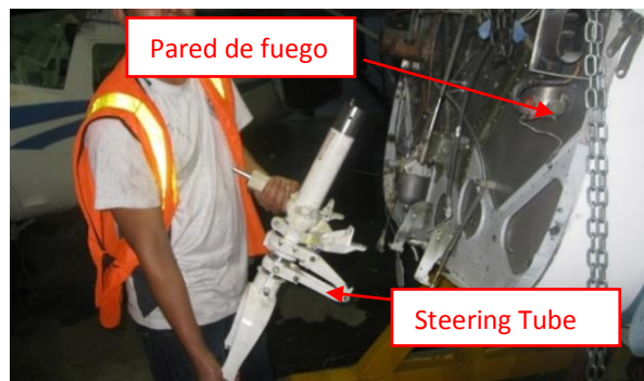
Figura 40. Desmontaje del amortiguador del tren de nariz.
