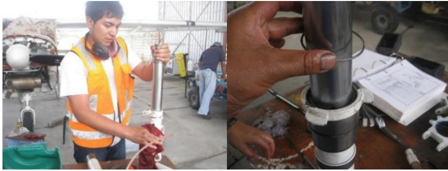
Figura 54. Servicio del amortiguador del tren de nariz.
