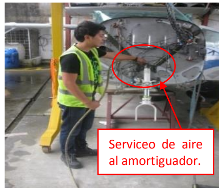
Figura 56. Servicio de aire al amortiguador.
