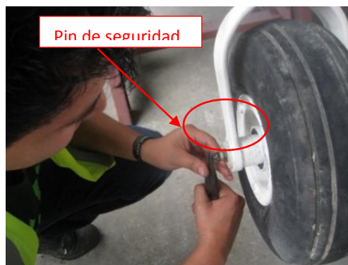
Figura 71. Montaje de la rueda de tren de nariz.
