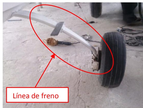
Figura 33. Desmontaje de líneas de freno.
