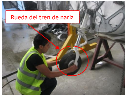
Figura 38. Desmontaje de la rueda del tren de nariz, cessna 182.
