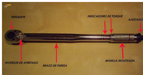
Figura 5. Descripción de llave dinamométrica.
