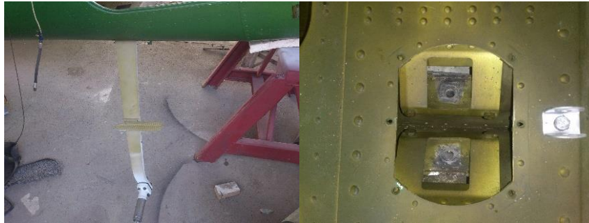
Figura 58. Montaje del soporte del tren de aterrizaje principal.
