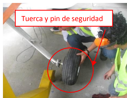
Figura 59. Montaje de rueda del tren principal.
