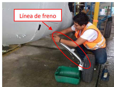
Figura 60. Montaje de línea de freno.
