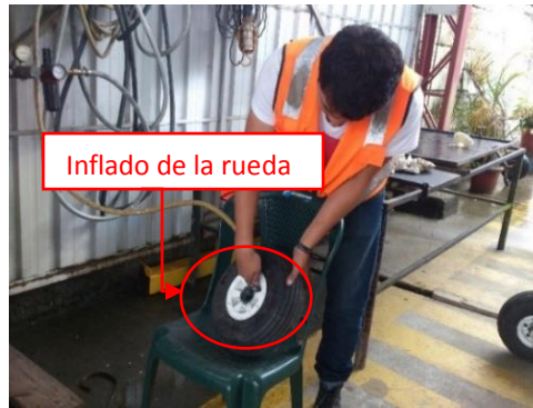
Figura 43. Servicio del inflado de la rueda del tren principal.
