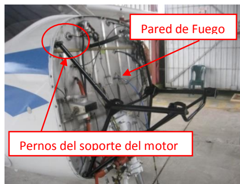
Figura 62. Montaje del soporte del motor.
