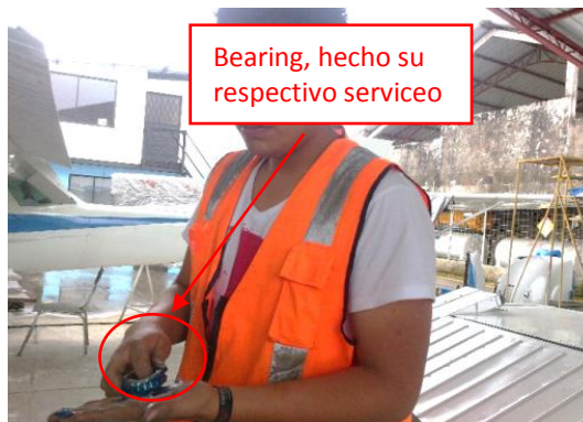
Figura 49. Servicio del cojinete de la rueda del tren principal.
