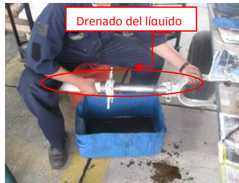
Figura 52. Drenado del líquido hidráulico del amortiguador.
