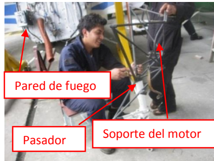
Figura 30. Castillo o soporte del motor.
