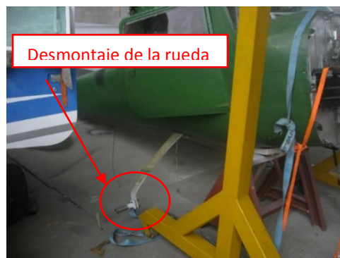
Figura 24. Desmontaje de la rueda del tren principal.
