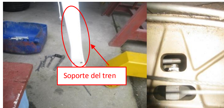
Figura 36. Desmontaje del soporte del tren de aterrizaje principal.
