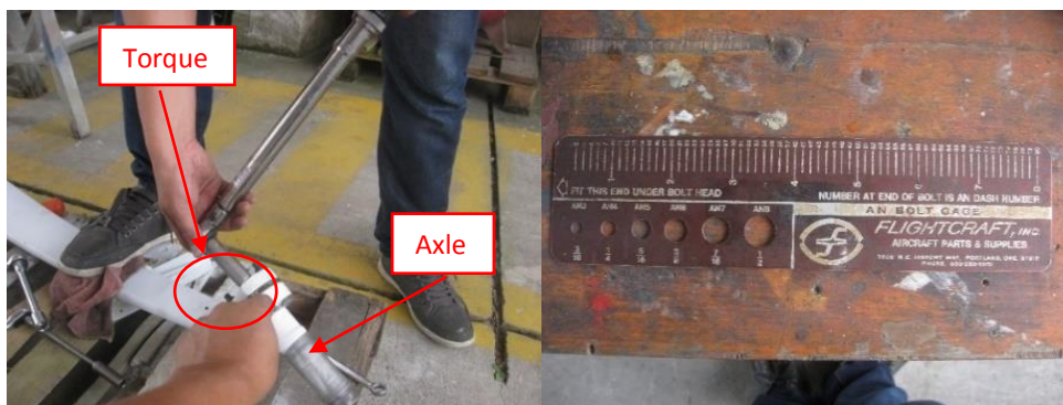
Figura 57. Torque al soporte del tren de aterrizaje principal, cessna 150.
