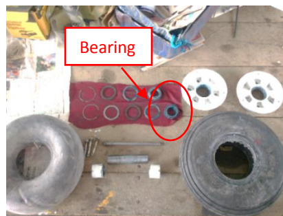
Figura 42. Serviceo de los componentes de la rueda del tren principal.
