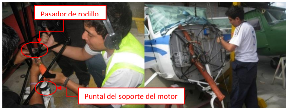
Figura 63. Montaje del amortiguador del tren de nariz.
