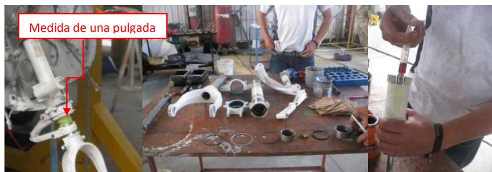
Figura 55. Llenado del líquido hidráulico en el amortiguador.
