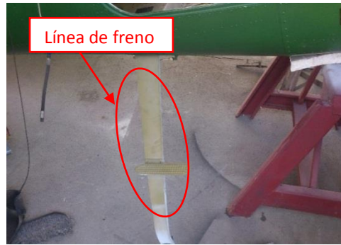
Figura 23. Desmontaje de líneas de freno.
