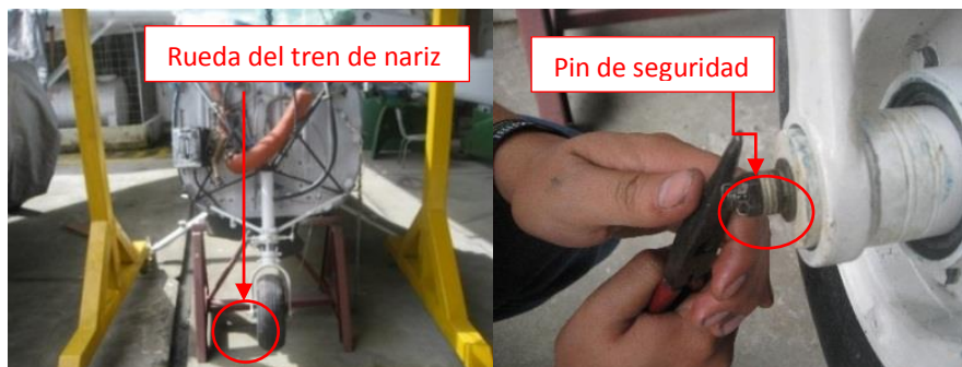
Figura 64. Montaje de la rueda de tren de nariz.
