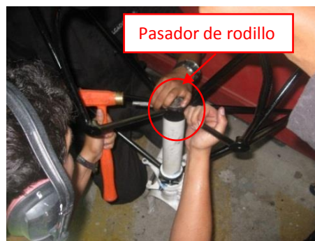
Figura 31. Desmontaje del amortiguador del tren de nariz.
