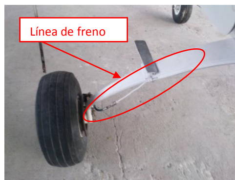
Figura 68. Montaje de la cámara de freno.
