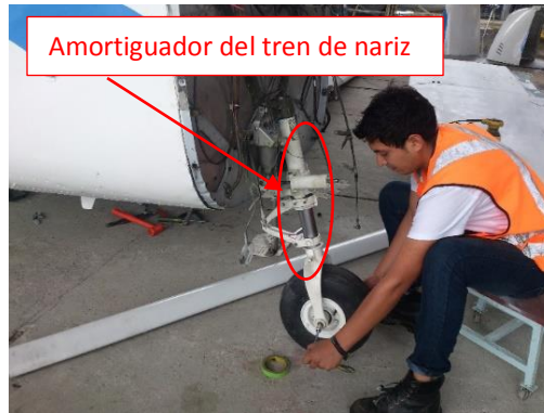
Figura 28. Desmontaje de la rueda del tren de nariz, cessna 150.
