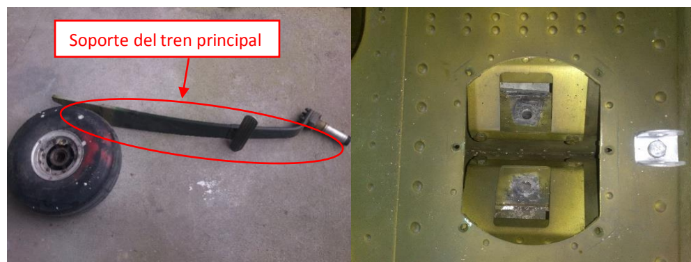
Figura 26. Desmontaje del soporte del tren de aterrizaje principal.
