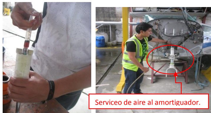
Figura 47. Serviceo del shimmy dampener.
