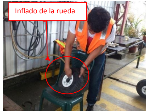
Figura 50. Servicio del inflado de la rueda del tren principal.
