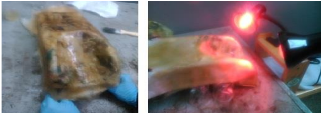
Figura 23: Molde recubierto (fibra de vidrio y mezcla), secado del molde con luz roja
