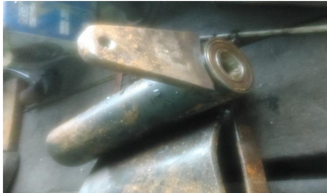
Figura 28: Perno soldado para la varilla de freno igual al pedal original
