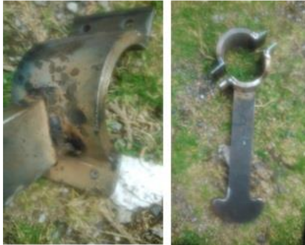
Figura 30: Unión del bocín con el cuerpo del contra peso
