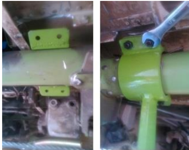
Figura 38: Implementación y ajuste de la contrapesa izquierda
