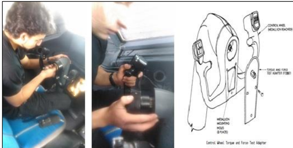
Figura 33: Colocación de la cabrilla
