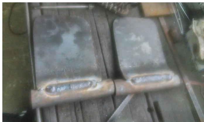
Figura 25: Lámina soldada al tubo de 2"
