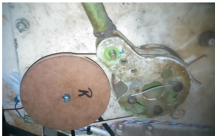
Figura 48: Punto de anclaje al potenciómetro del control del Rudder
