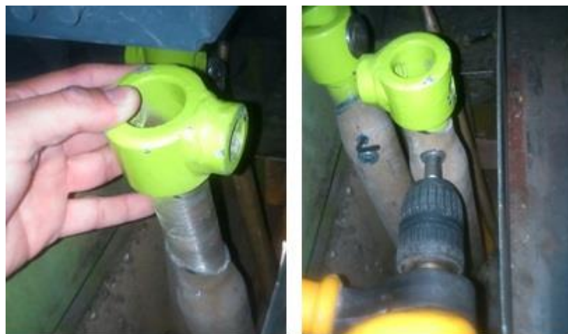
Figura 34: Acoples de los pedales del primer oficial
