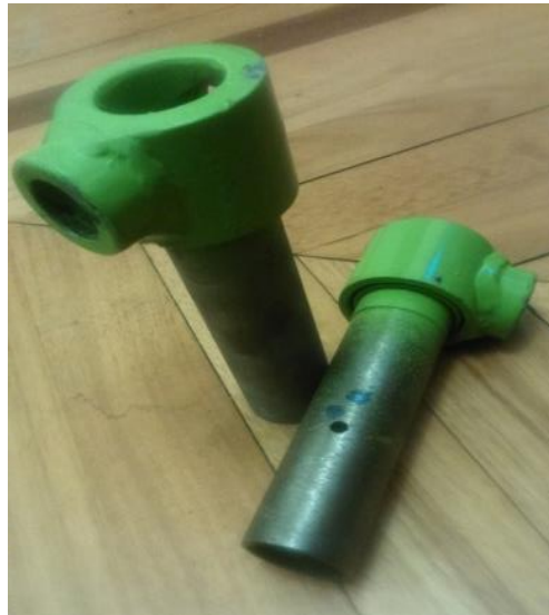
Figura 32: Acoples de los pedales del primer oficial
