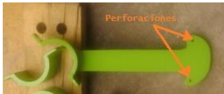
Figura 40: Perforaciones para el cable de acero de los contrapesos de la columna de control
