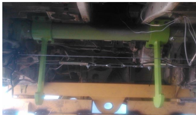
Figura 39: Contrapesas sujetadas al tubo de torque del control de los elevadores
