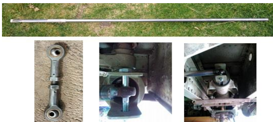
Figura 20: Tubo de torque implementación al brazo de control del rudder
