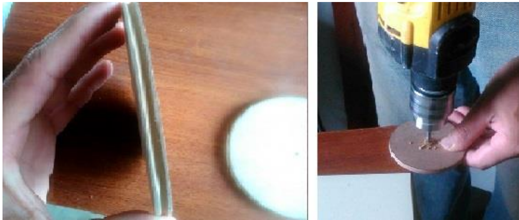
Figura 43: Fabricación de las poleas
