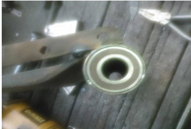
Figura 26: Rulimanes dentro del tubo de 2"
