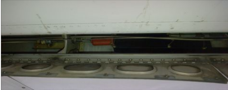
Figura 22. Panel abierto del circuito asimétrico
