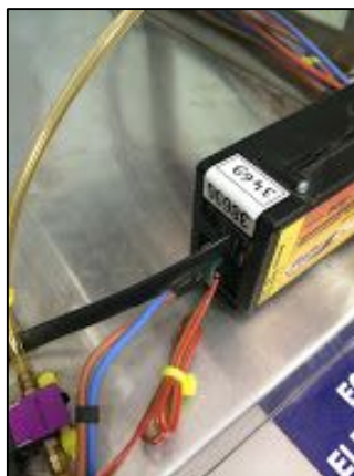
Figura 69. Posición del plug de la válvula shut-off de paso de combustible.
