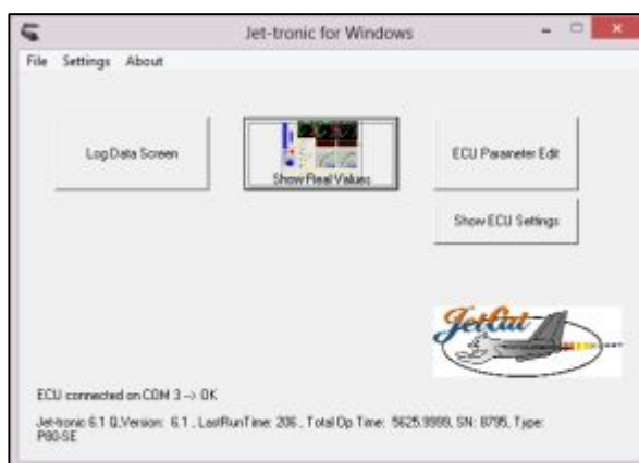
Figura 55. Mensaje de sincronización entre ordenador y motor.
