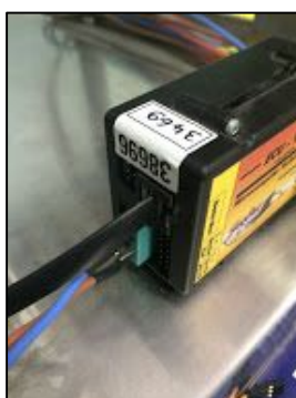
Figura 68. Posición del plug de transferencia de datos entre el ECU y el Tablero LED I/O.
