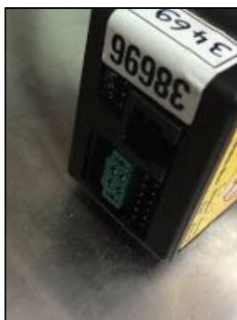
Figura 66. Disposición de puertos de la cara izquierda del ECU.
