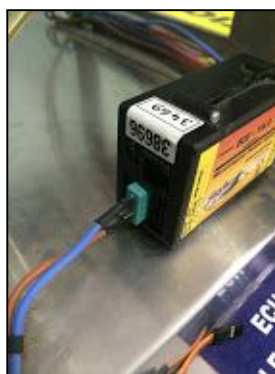
Figura 67. Posición del plug de la bomba de combustible.
