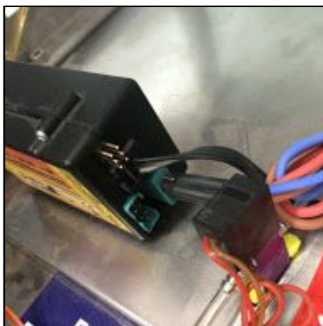
Figura 63. Posición del plug tipo RJ de transferencia de datos entre la turbina y el ECU
