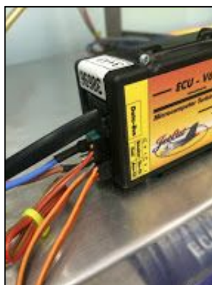
Figura 70. Posición de los plugs de throttle y auxiliar.
