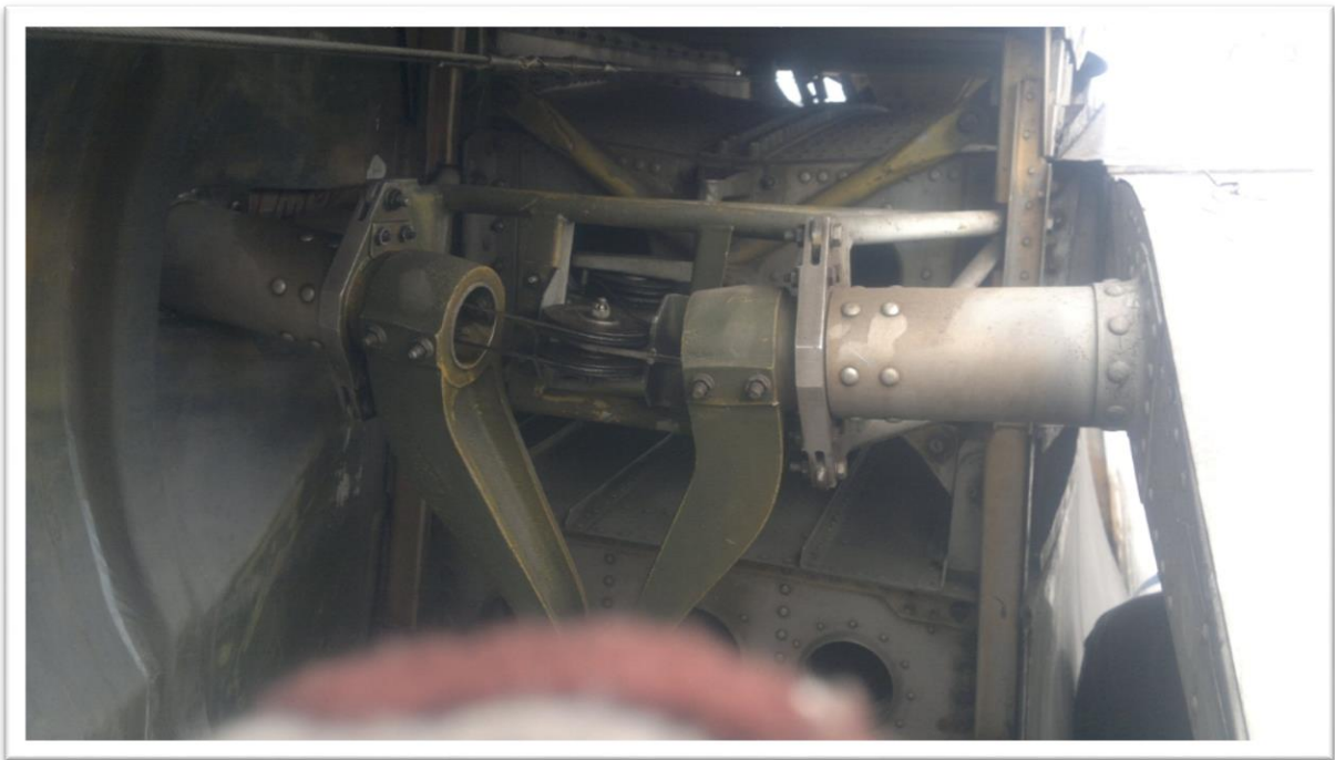
Figura 3.13 Cables y poleas de la aleta compensadora que deben ser removidos
