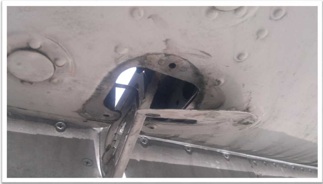
Figura 3.15 Tapa de una de las articulaciones y cable de puesta a masa
