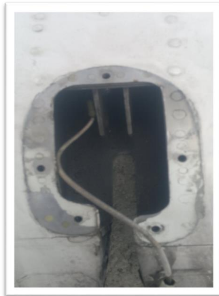
Figura 3.16 Articulación luego que fue removida la tapa y el perno de sujeción.
