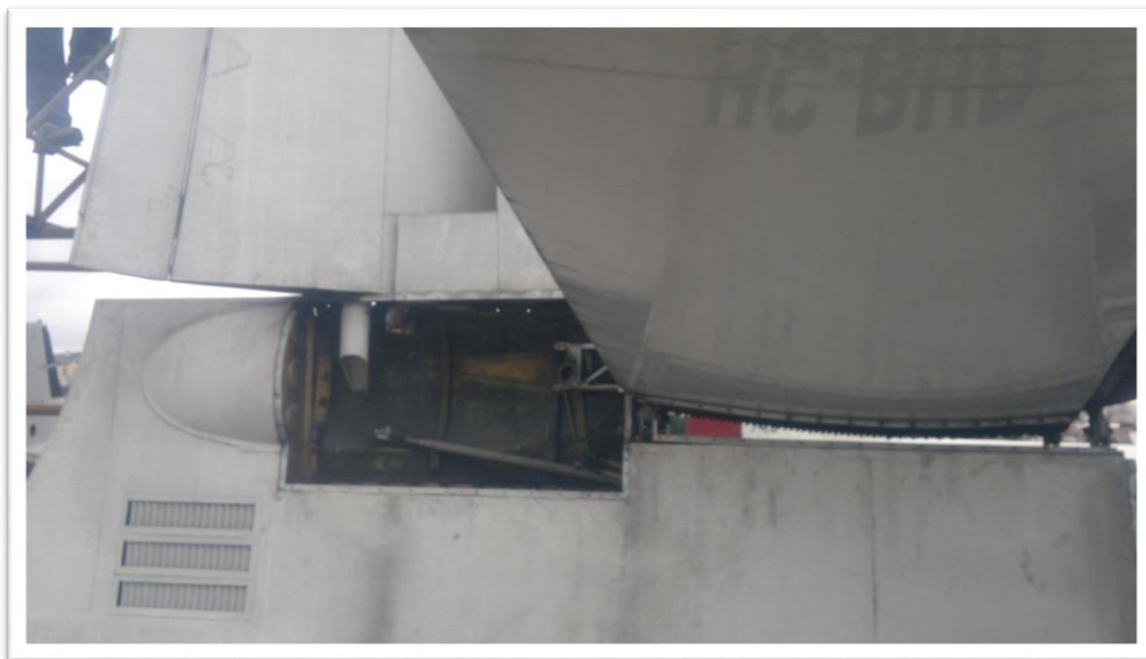
Figura 3.12 Panel trasero del estabilizador luego de haber sido removido el carenaje.
