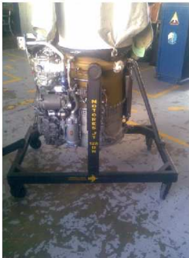
Motor apoyado verticalmente con la ayuda de un tubo
