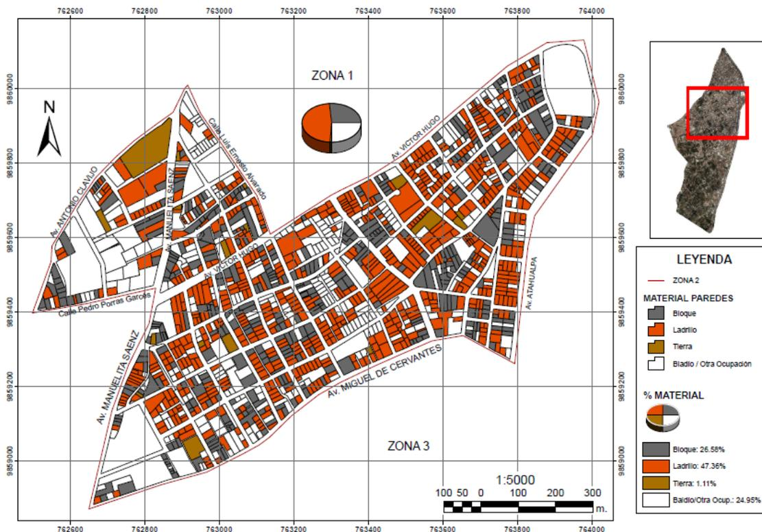
De la Figura 19, se determina que del total de viviendas el 26.58% tiene paredes con mampostería de bloque, el 47.36% tiene mampostería de ladrillo y el 1.11% tiene paredes de tierra (adobe).
