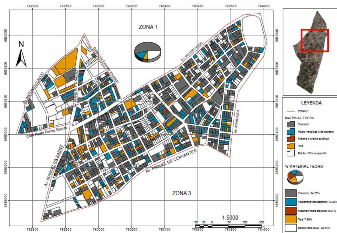
De la Figura 18, se determina que del total de viviendas el 54.27% tienen techo de concreto, el 12.83% techo de hojas metálicas o asbesto, el 0.07% el techo de madera y el 7.88% tienen el techo de teja.
