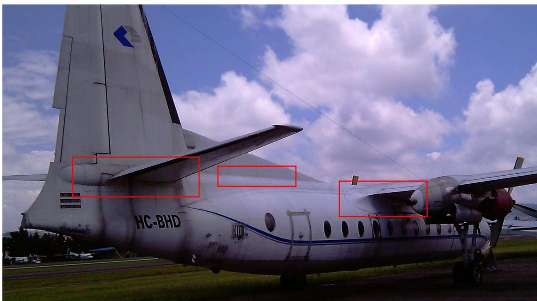
**Figura 3.4:** Carenajes a ser removidas para el desmontaje
