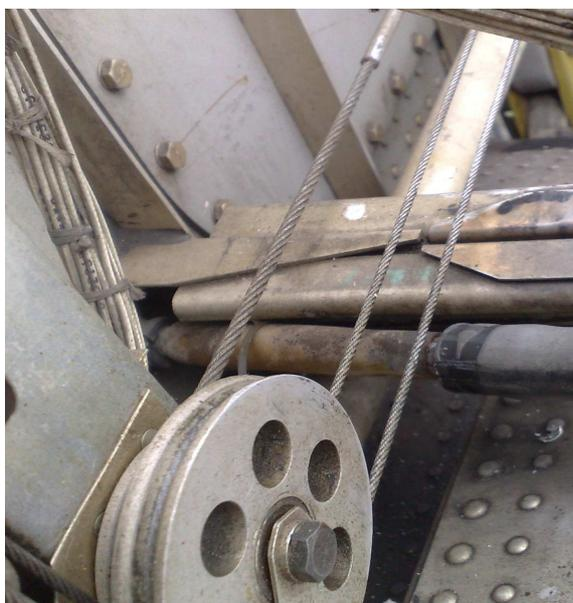
**Figura 3.9:** Poleas y a cables de controles de vuelo del ala derecha
