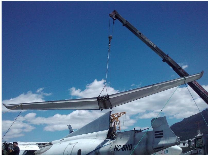
**Figura 3.32:** Izamiento del estabilizador horizontal
