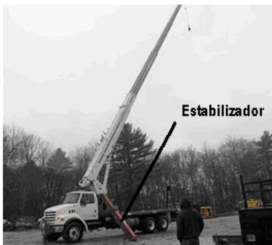
**Figura 2.17:** Grúa telescópica sobre camión con su estabilizador
