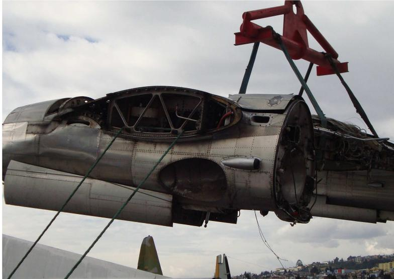
**Figura 3.35:** Elevación del Ala central
