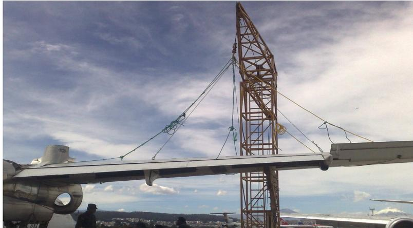
**Figura 3.22:** Eslinga tensionada con el tecle, atizada con cabos
