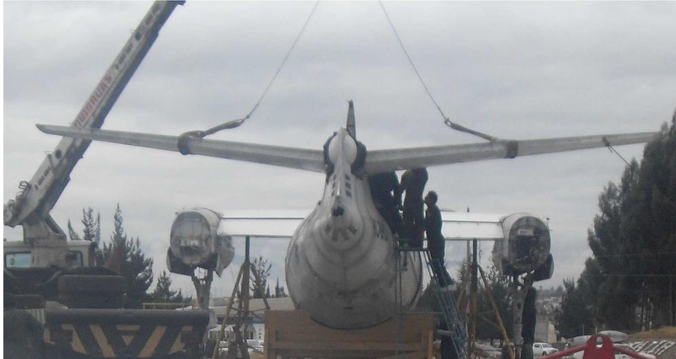
**Figura 3.38:** Izado y armado del estabilizador Horizontal
