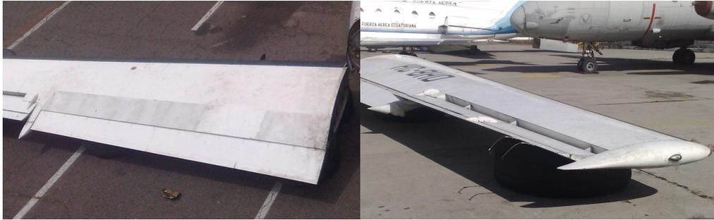
**Figura 3.25:** Alas externa desmontadas
