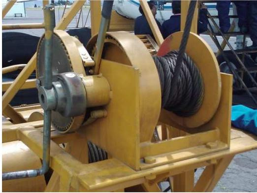
**Figura 3.23:** Mecanismo de movimiento del tecla
