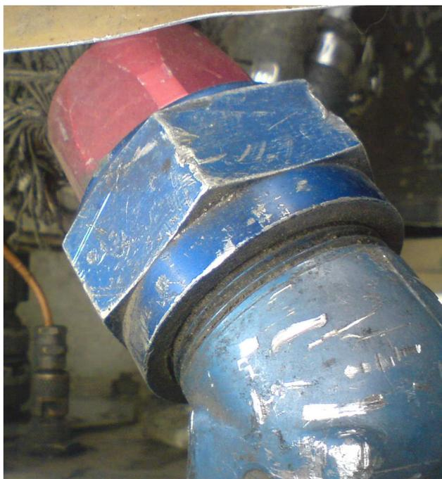
**Figura 3.8:** Cañería principal de combustible a desconectar
