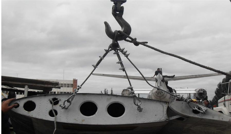
**Figura 3.39:** Sujeción de la eslinga al estabilizador vertical
