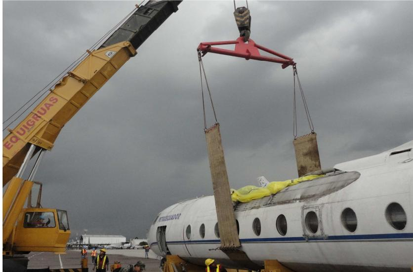
**Figura 3.36:** Colocación de eslinga tipo faja y pórtico elevación estación 347.619
