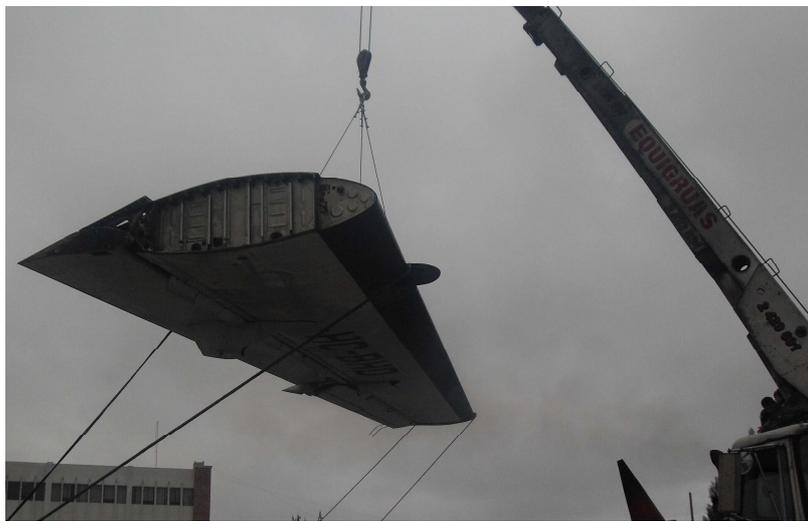
**Figura 3.40:** Elevación del ala externa izquierda para su armado
