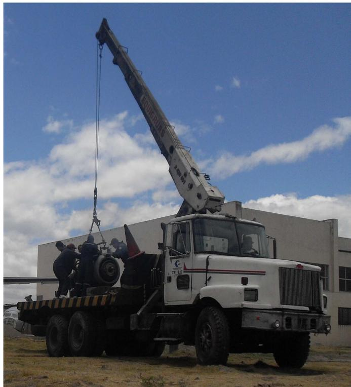
**Figura 2.16:** Grúa telescópica sobre camión
