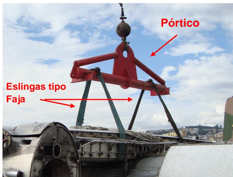
**Figura 3.34:** Sujeción del ala con el pórtico y las eslingas
