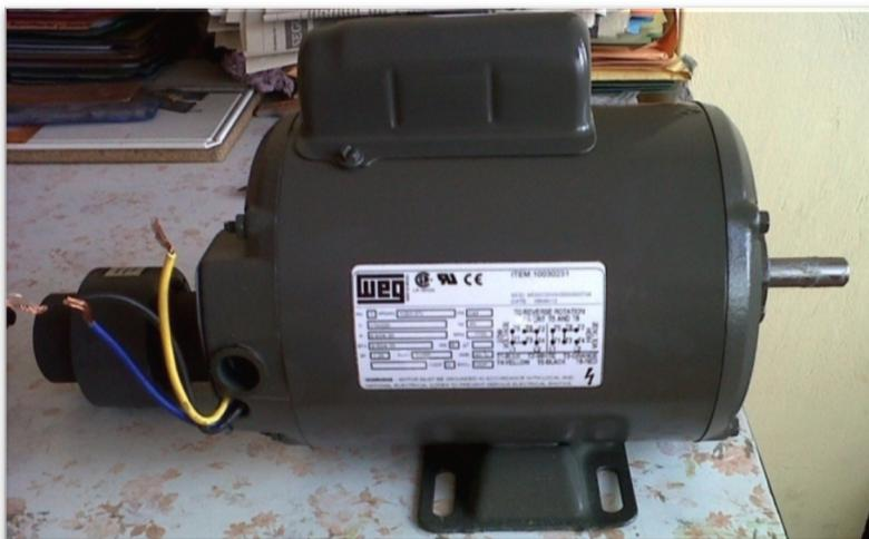
**Figura 3.5. Motor monofásico**
