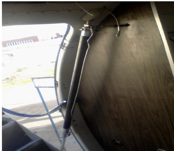
**Figura B.6.** Cilindro hidráulico de simple efecto
