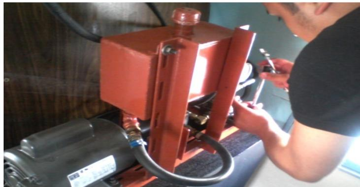
**Figura 3.17.** Accionamiento de la palanca de mando
