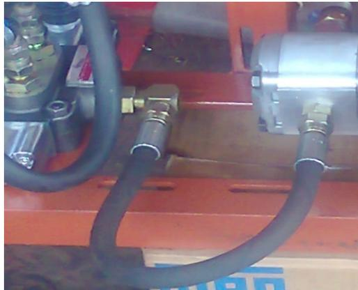
**Figura 3.14.** Unión de la bomba hidráulica con la válvula direccional
