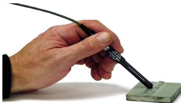
Figura 19 Inspección por corrientes Foucault.
