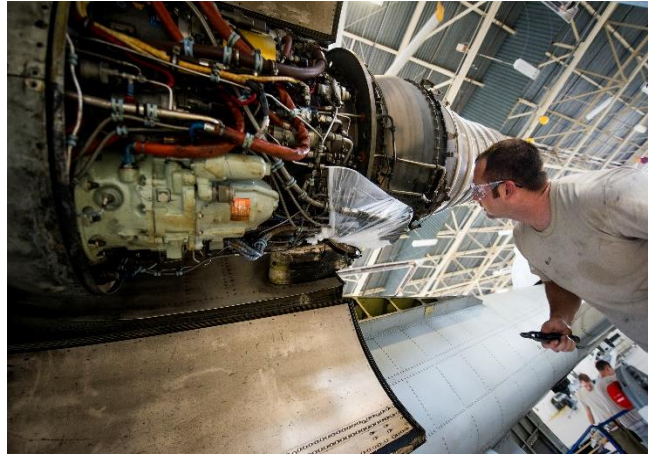
Figura 22 Inspección visual de un motor Fuente: (Aerodecals, 2015)
