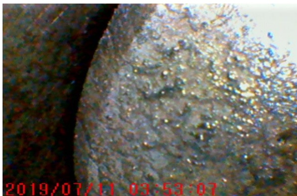
Figura 36 Inspección asiento de válvula de admisión
