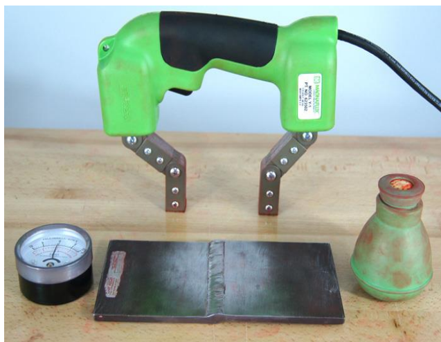
Figura 18 Inspección por partículas magnéticas Fuente: (ECNDT, 2015)
