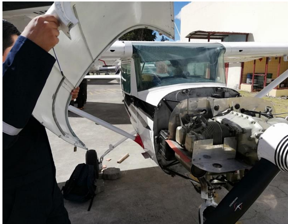
Figura 30 Remoción cubierta superior
