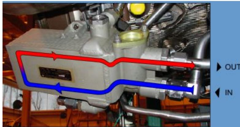
**Figura 23 INTERCAMBIADOR DE CALOR**
