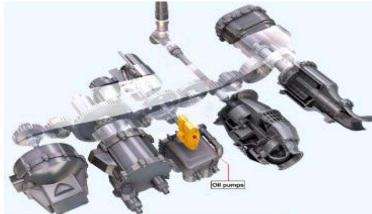
**Figura 11 BOMBA DE PRESIÓN EN LA GEAR BOX**
