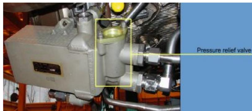
**Figura 24 VÁLVULA DE DESCARGA DE PRESIÓN DEL INTERCAMBIADOR DE CALOR**
