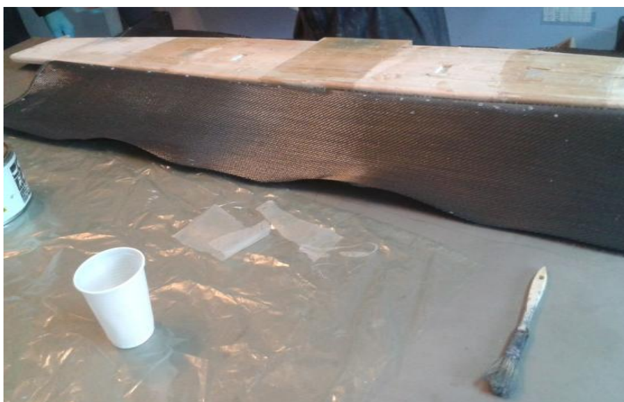
Figura 3.19. Aplicación de la mezcla resina/endurecedor
