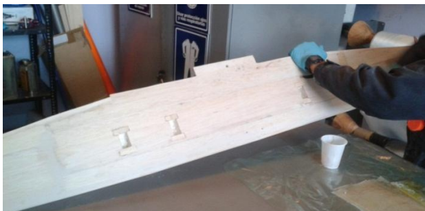
Figura 3.14. Preparación superficial del ala
