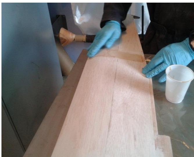
Figura 3.18. Colocación del tejido híbrido
