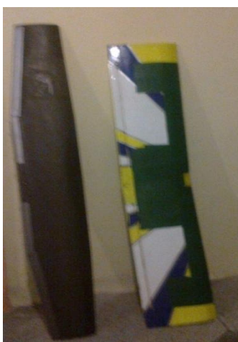
Figura 3.29. Ala en fibra de Carbono y Ala convencional para análisis
