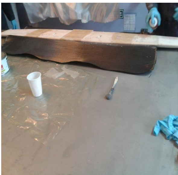
Figura 3.15. Aplicación del agente desmoldante
