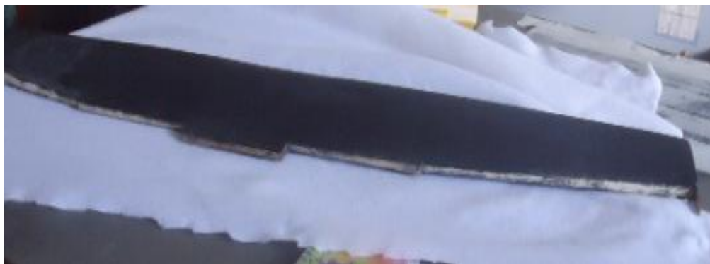
Figura 3.24. Ala terminada la etapa de curado
