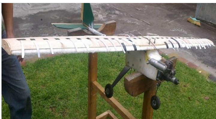
Figura 3.10. Primeras pruebas de sustentación en Tierra
