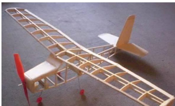
Figura 2.6. Aplicación de la balsa
