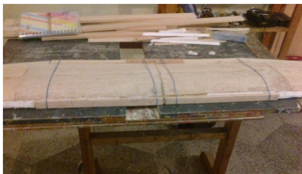
Figura 3.9. Aplicación del material de refuerzo
