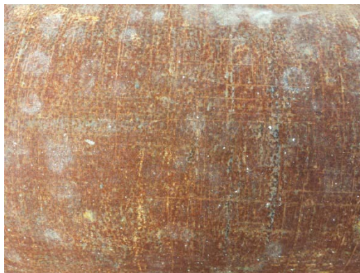
Figura 2.10. Grado de herrumbre C
