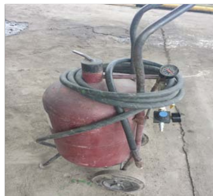
Figura 2.2. Sandblasting por presión
