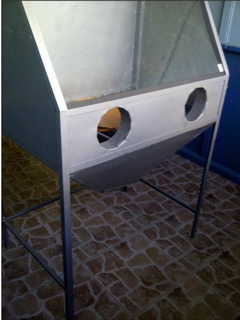
Figura 3.21. Cabina sandblasting pintada
