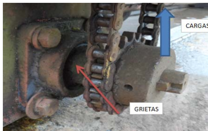
Figura 2.18 Corrosión por fatiga
