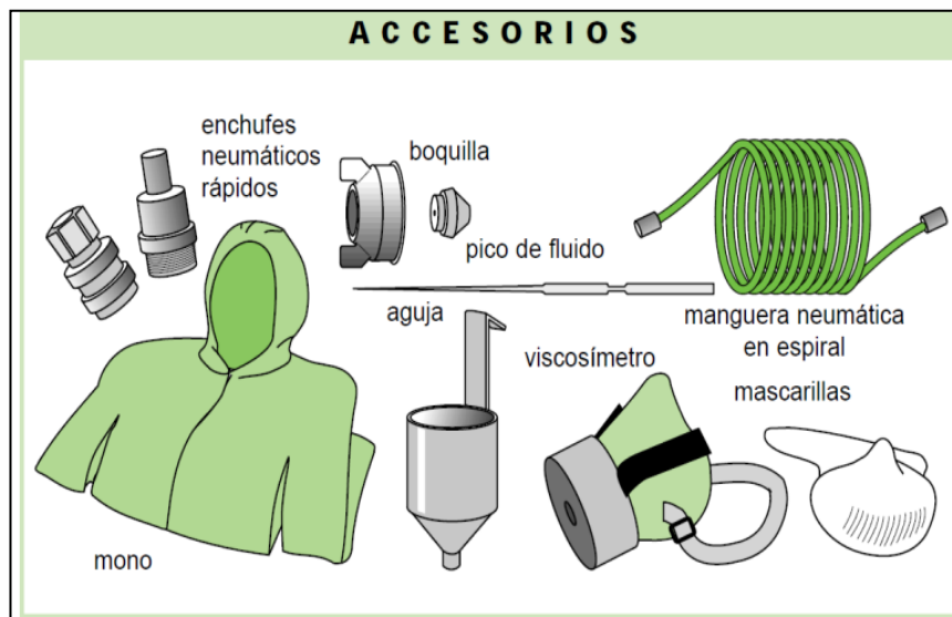
Figura 2.32. Accesorios de la pistola neumática
