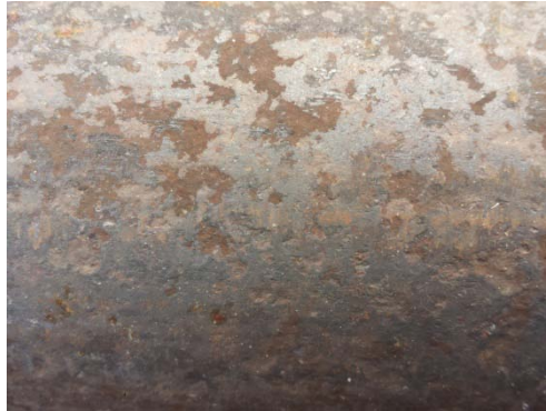
Figura 2.9. Grado de herrumbre B
