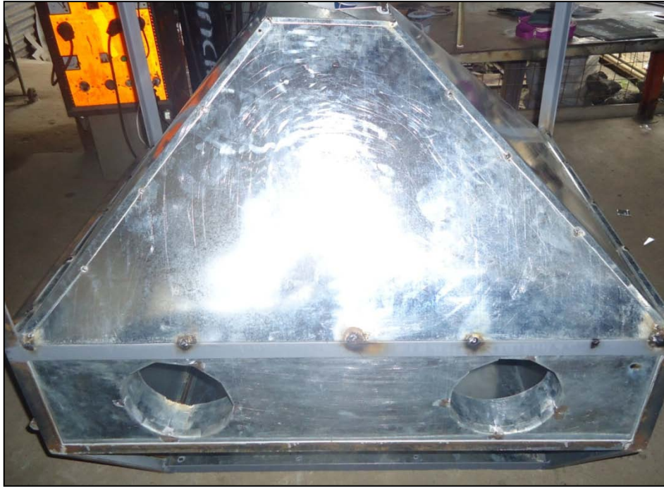
Figura 3.18. Construcción del depósito de granalla Fuente: Investigación de campo
