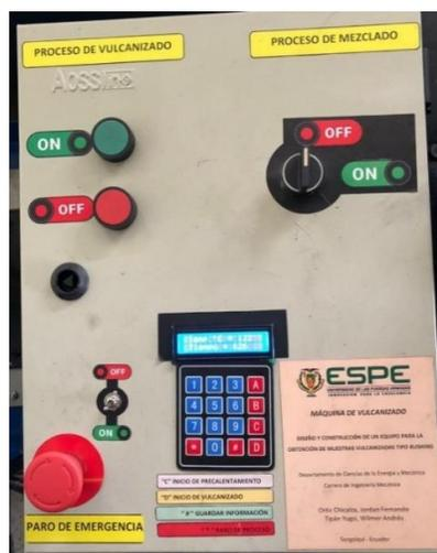
Nota: En la presente figura se muestra cómo se montó y distribuyó los componentes de protección como control en el gabinete.
