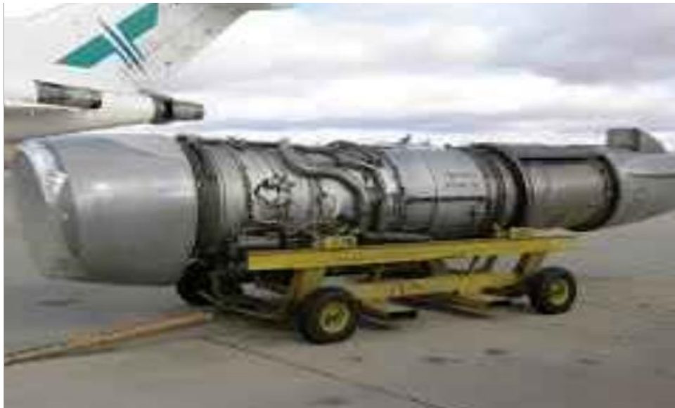
Figura 2.7: Cama de transporte de alto tráfico para el motor JT8-D
