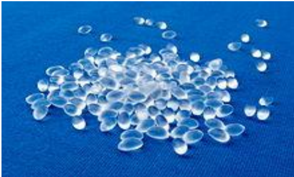
Figura 2.26: Granza o pellets de poliuretano termoplástico (TPU)
