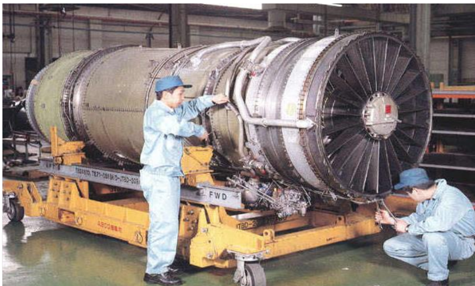
Figura 2.6: Estructura tipo cama para transporte del motor JT8-D
