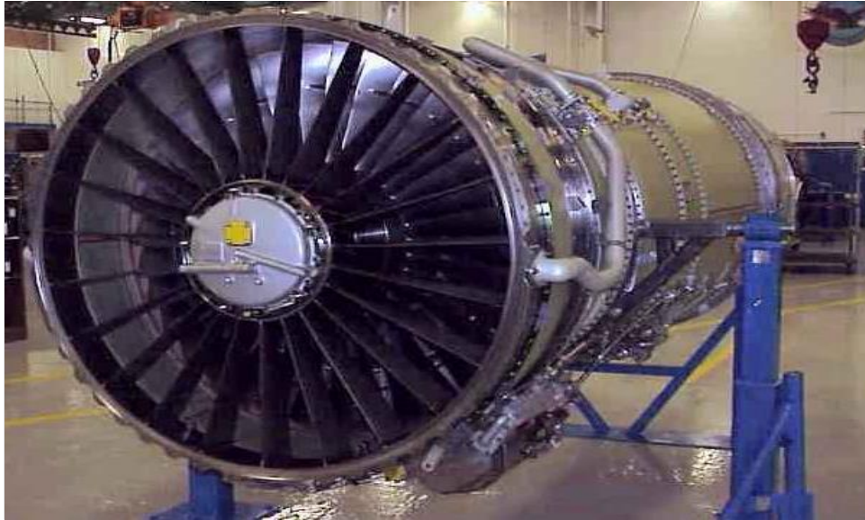
Figura 2.8: Soporte para el motor JT8-D de configuración estática didáctica
