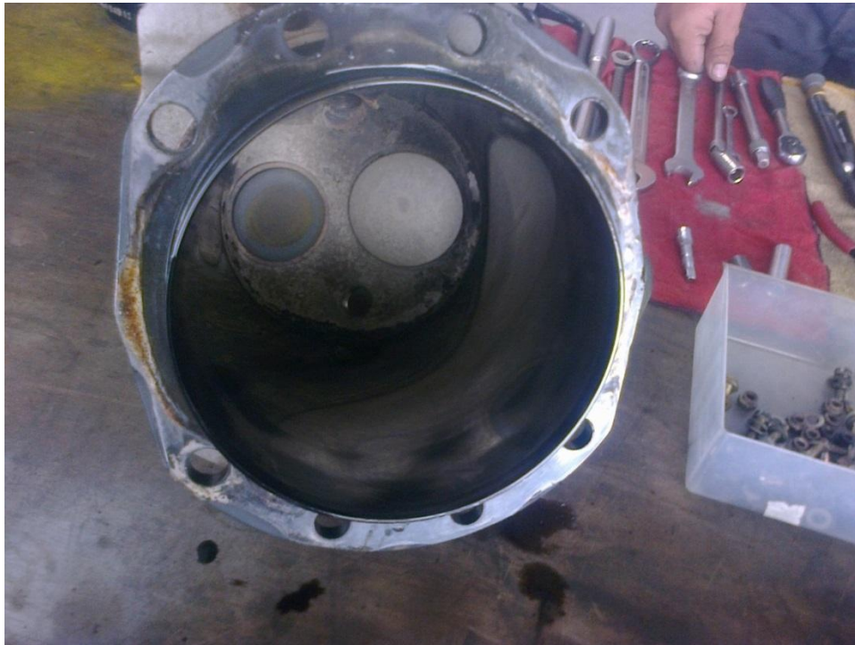
Figura 3.23. Inspección visual del interior del cuerpo del cilindro.
