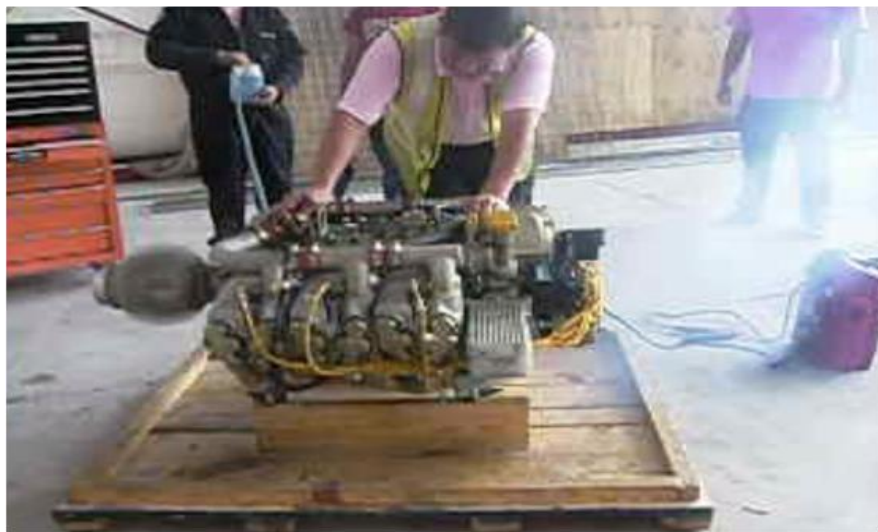
Figura 3.50. Proceso de encendido del motor TC IO-360 D
