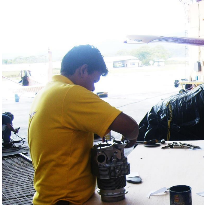
Figura 3.17. Limpieza del cilindro del motor TC IO 360 D.
