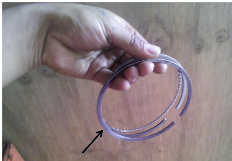
Figura 3.15. Rines extraídos del pistón del motor TC IO-360 D
