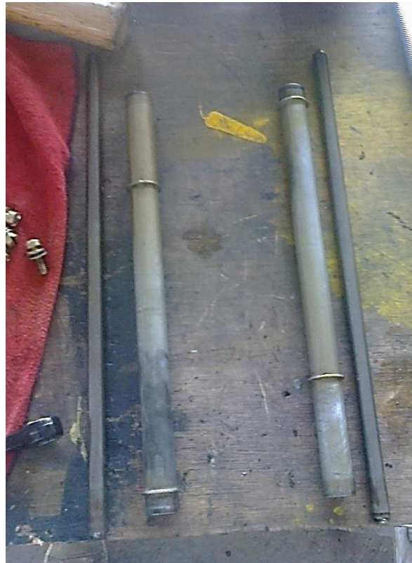
Figura 3.21. Varillas propulsoras y tubos protectores limpios.
