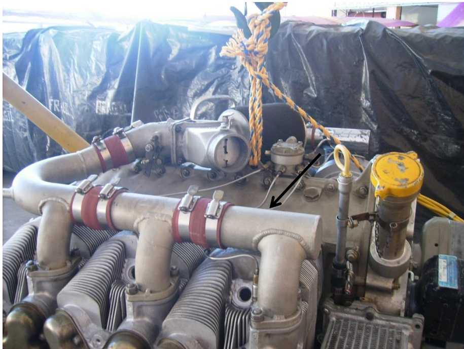
Figura 3.37. Tubos de admisión montados en el motor.
