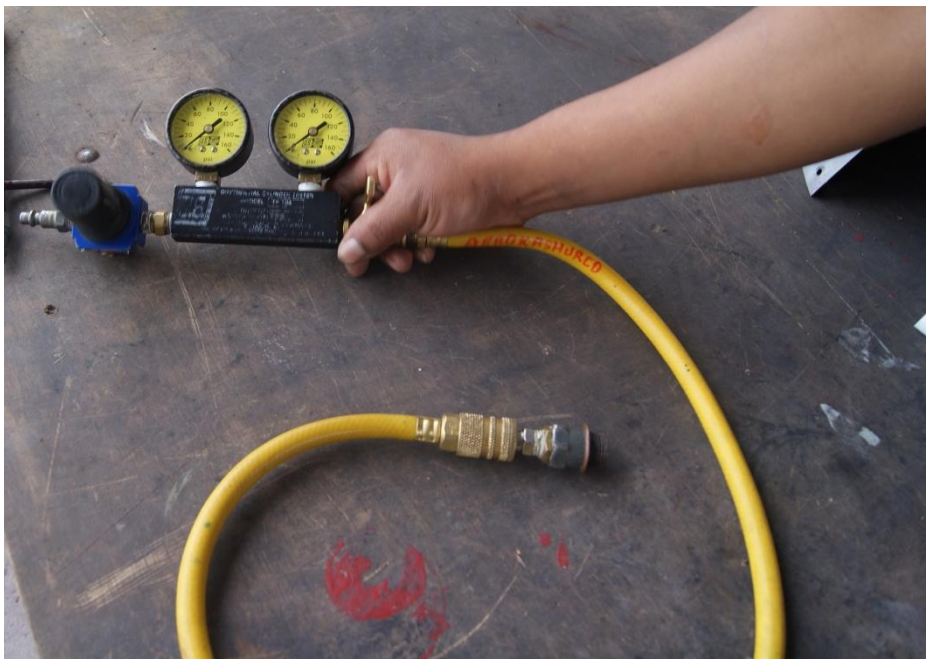
Figura 3.38. Medidor de presión diferencial.
