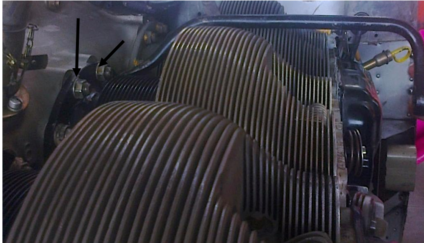
Figura 3.10. Remoción de tuercas de la base del cilindro del motor TC IO-360 D
