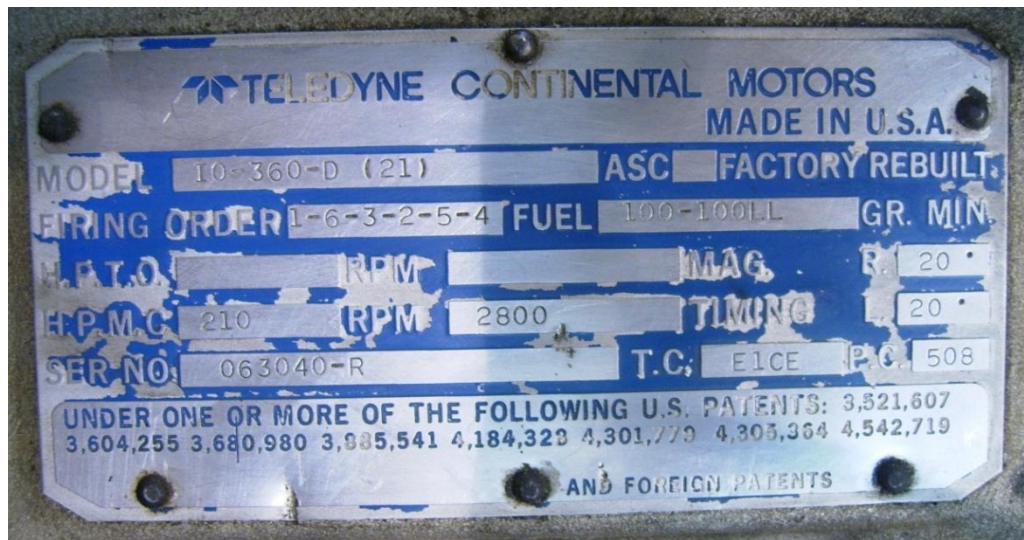
Figura 3.1. Placa de identificación en el motor TC IO-360 D
