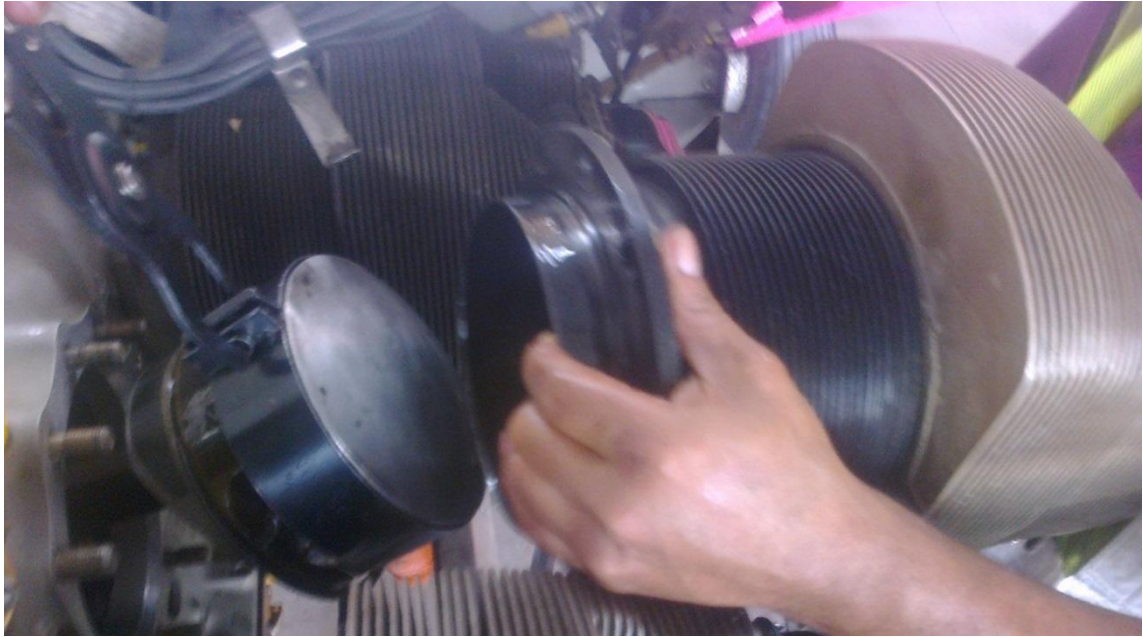
Figura 3.33. Colocación del cilindro.
