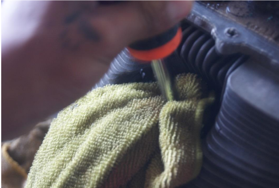
Figura 3.42. Colocación de la franela para encontrar el PMS.
