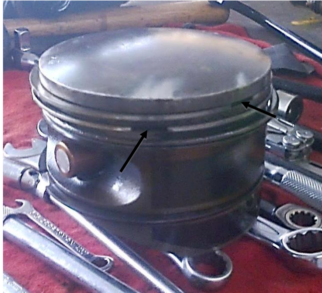
Figura 3.29. Posición en la que deben estar las aberturas de los rines.
