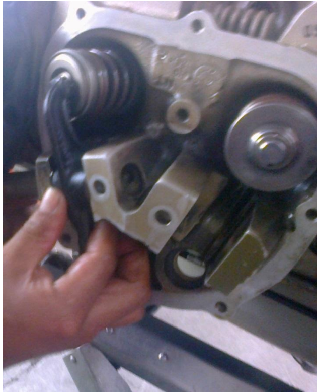
Figura 3.35. Colocación de balancines.
