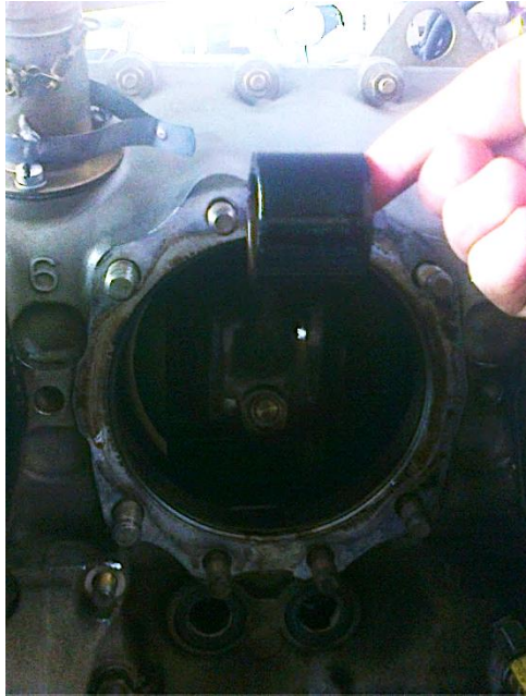
Figura 3.27. Posición totalmente afuera del brazo de biela.
