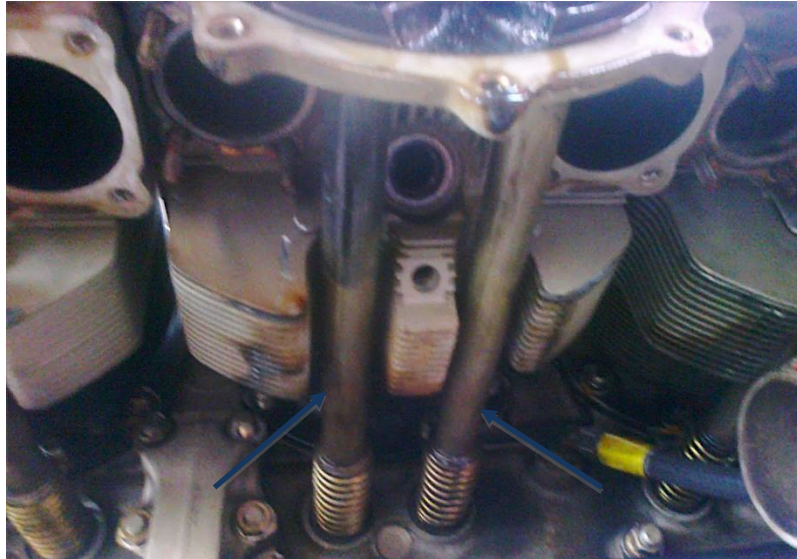
Figura 3.6. Tubos protectores y varillas propulsoras del motor TC IO-360 D
