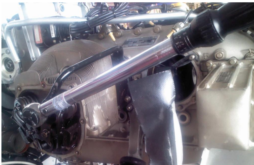
Figura 3.36. Torque de los cilindros.
