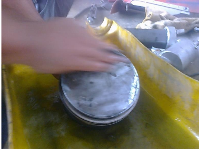
Figura 3.18. Mantenimiento y limpieza del pistón.
