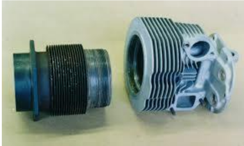
Figura 2.13. Cabeza y cuerpo del cilindro.
