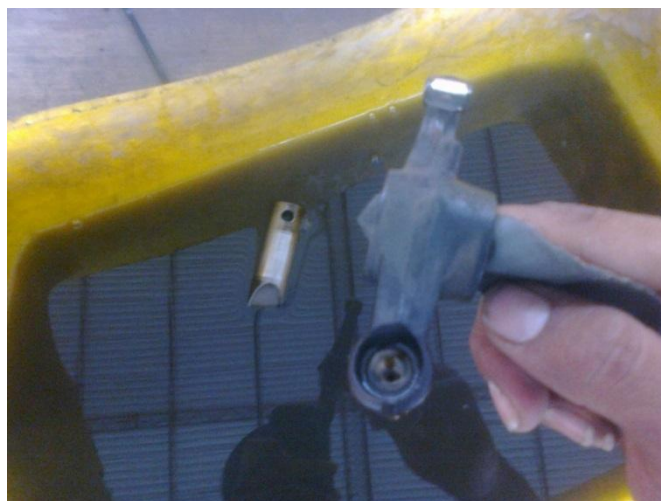
Figura 3.19. Limpieza de los balancines.
