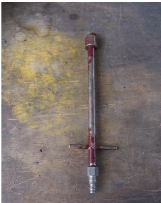
Figura 3.39. Acople para realizar la medición de la compresión de cilindros.
