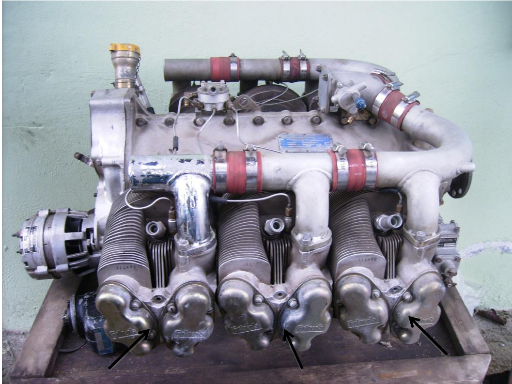
Figura 3.2. Cilindros del motor TC IO-360 D
