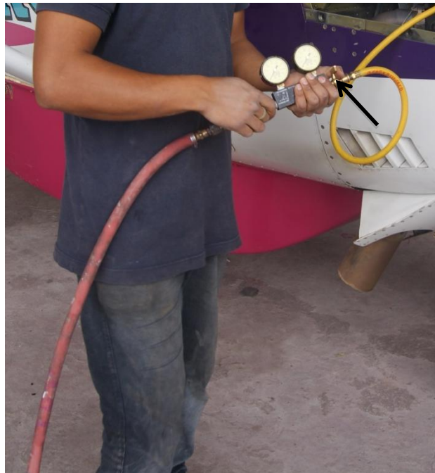
Figura 3.45. Cierre de la válvula de paso de aire.
