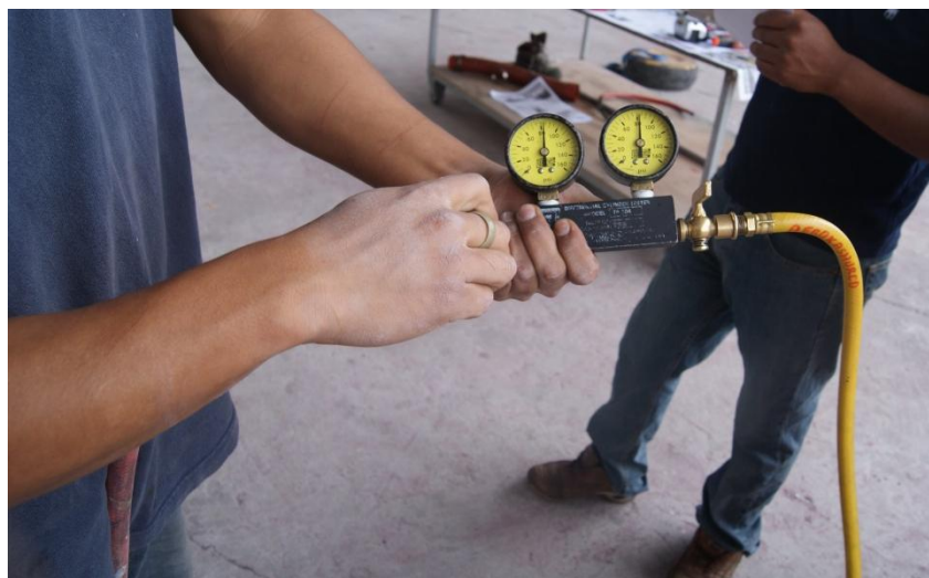
Figura 3.44. Resultado final de la medida de la compresión de cilindros.
