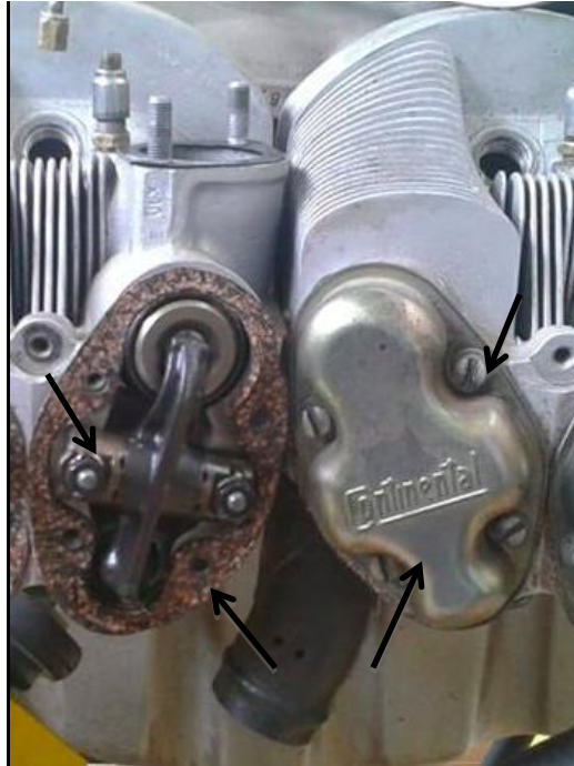
Figura 3.8. Cobertores de los balancines removidos del motor TC IO-360 D
