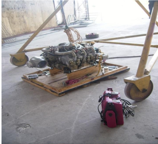
Figura 3.40. Motor TC IO 360 D puesto en funcionamiento.
