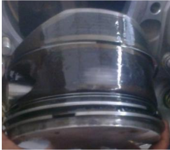
Figura 3.12. Desmontaje del pistón del motor TC IO-360 D
