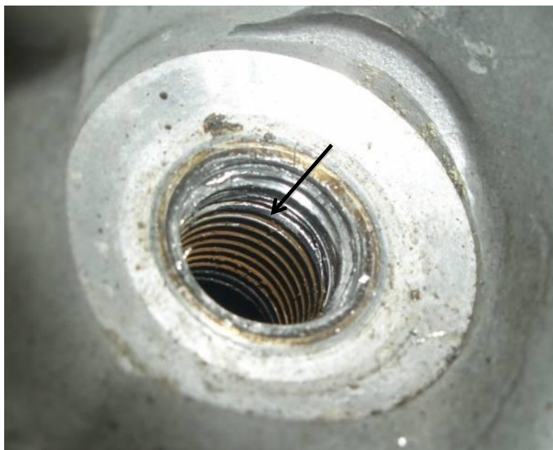
Figura 2.15. Injertos Heli-coil en la cabeza del cilindro.
