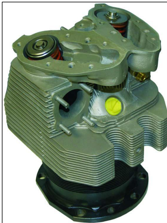
Figura 2.12. Cilindro del motor TC IO 360 D.
