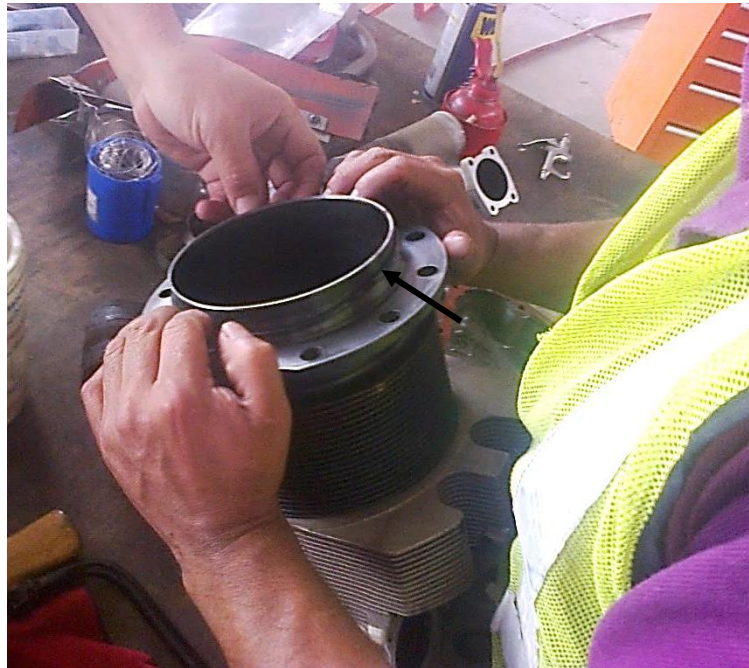
Figura 3.14. Extracción del “O” ring del cilindro del motor TC IO-360 D
