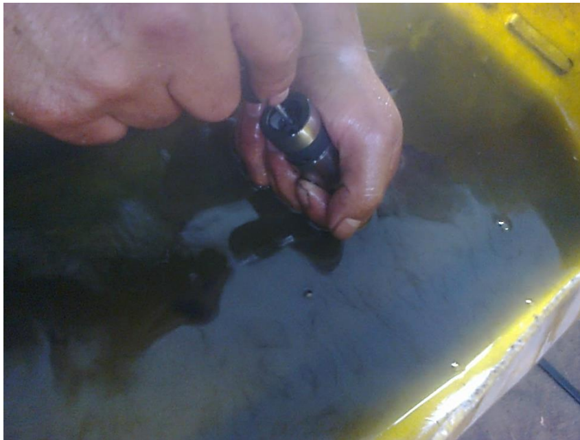
Figura 3.20. Eliminación de aceite del interior del taqué.
