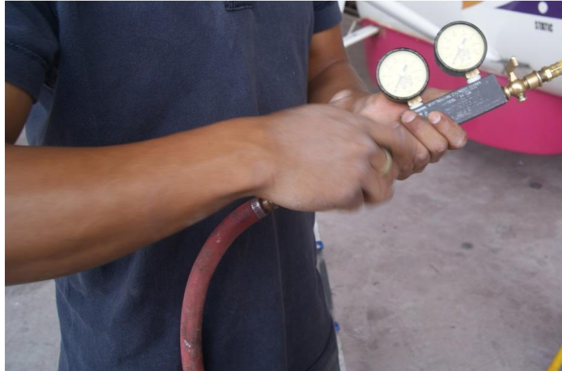
Figura 3.43. Medida de la compresión de los cilindros.
