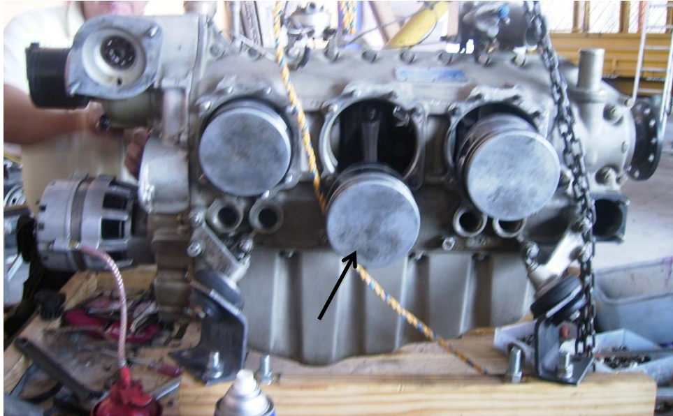
Figura 3.4. Pistones del motor TC IO-360 D
