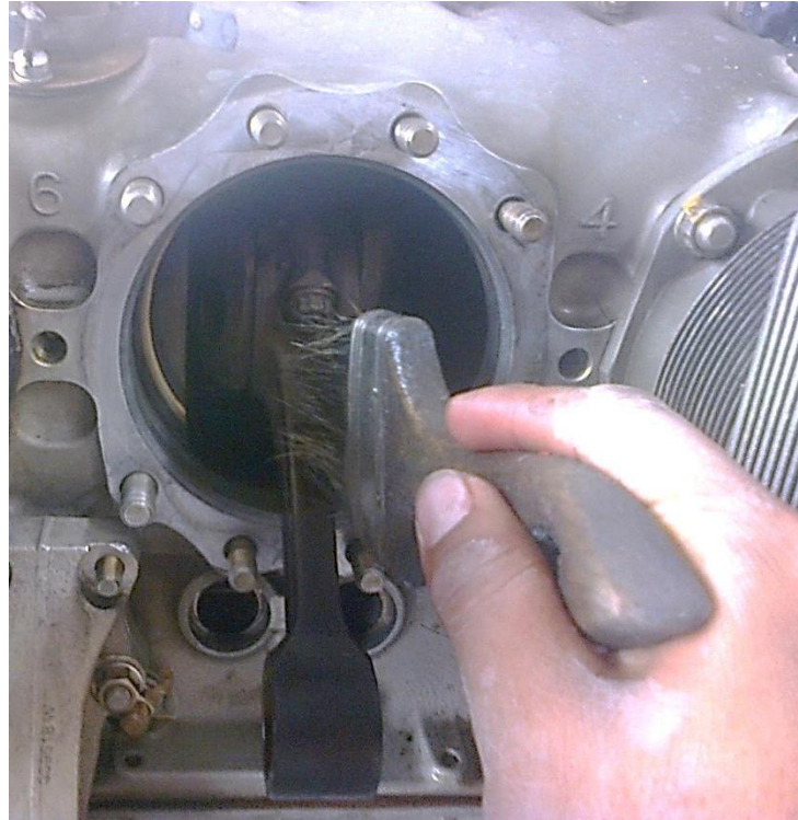
Figura 3.22. Limpieza de los alojamientos de los cilindros.
