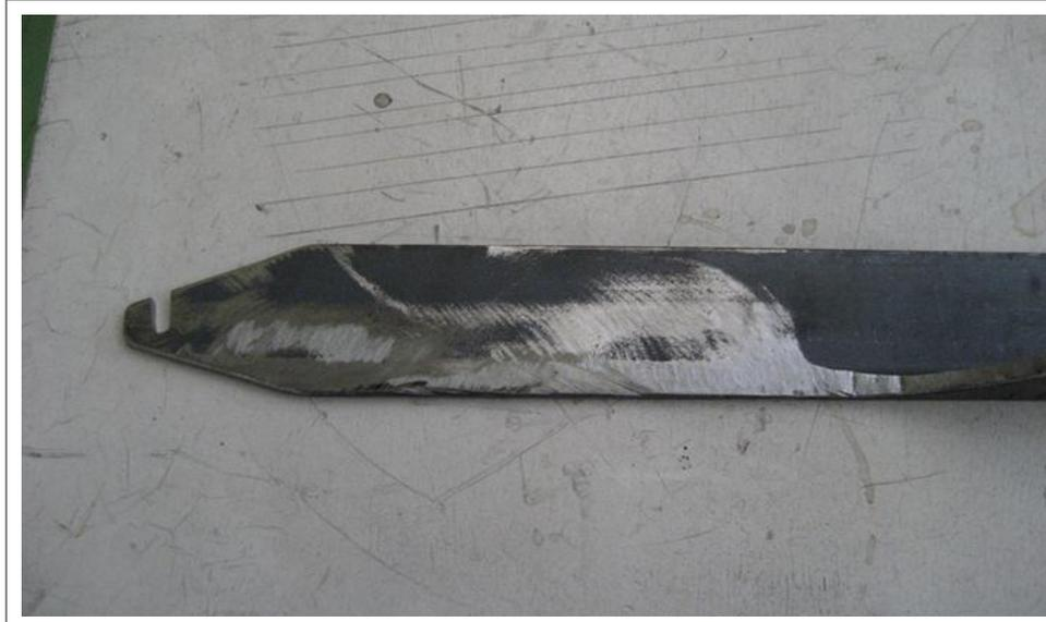
**Figura 3.16.** Acabado de las cuchillas
