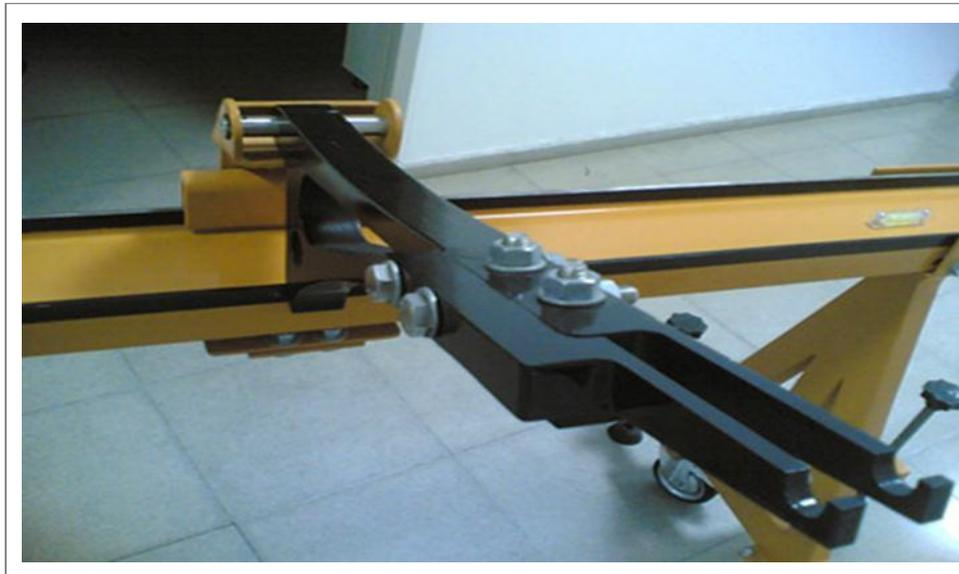
**Figura 2.19.** Balanceador de controles de vuelo de cuchilla doble
