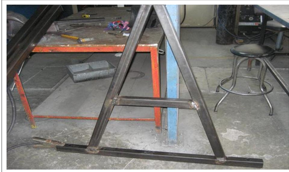
**Figura 3.11.** Proceso de suelda de la estructura
