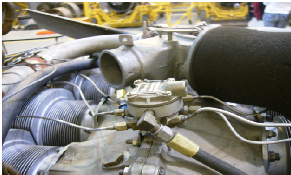
Figura 3.15. Partes del colector distribuidor de combustible
