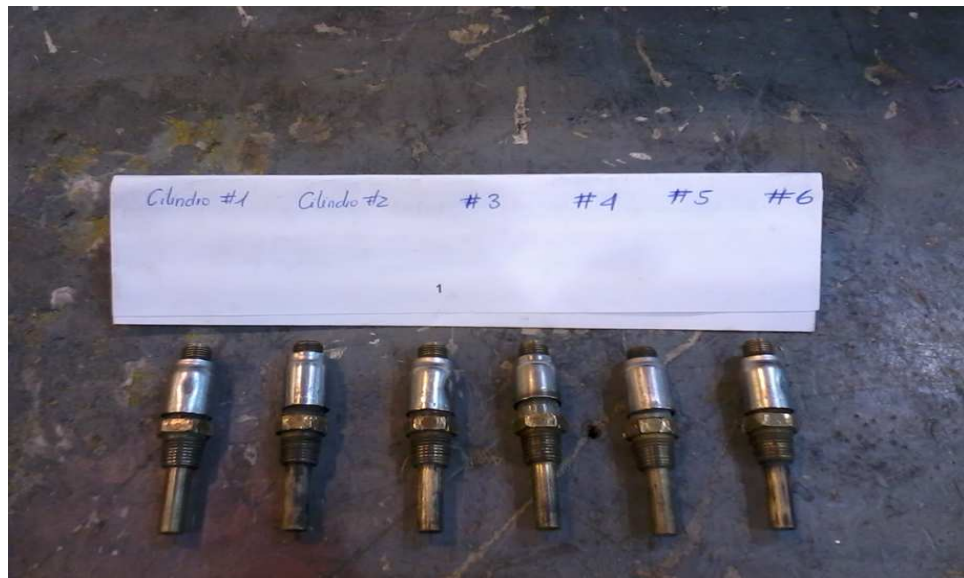
Figura 3.28. Orden de inyectores acorde al número de cilindro
