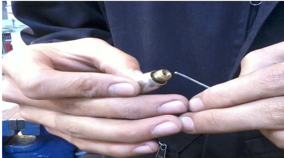
Figura 3.29. Comparación de pin calibrador e inyector
