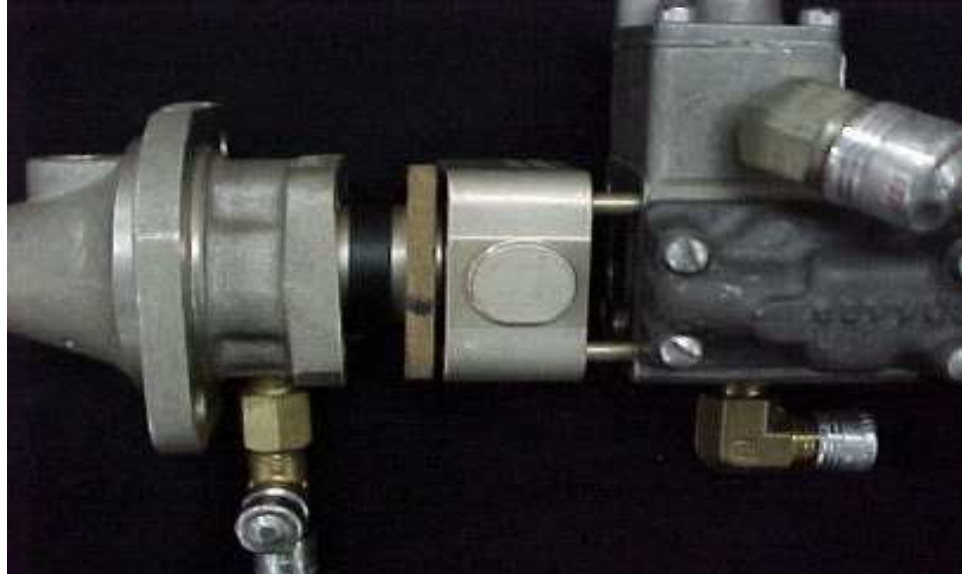
Figura 3.20. Sello de fugas en la bomba de combustible básica
