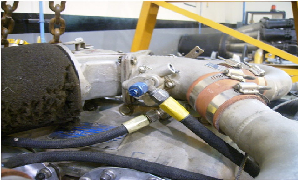
Figura 3.13. Partes de la unidad de control aire combustible
