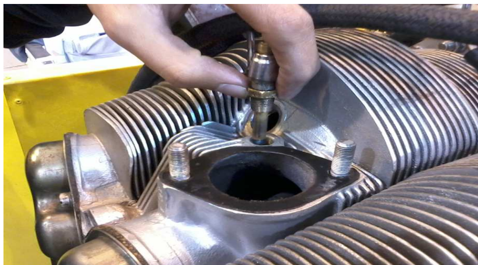
Figura 3.30. Instalación de inyectores acorde SB06-1A
