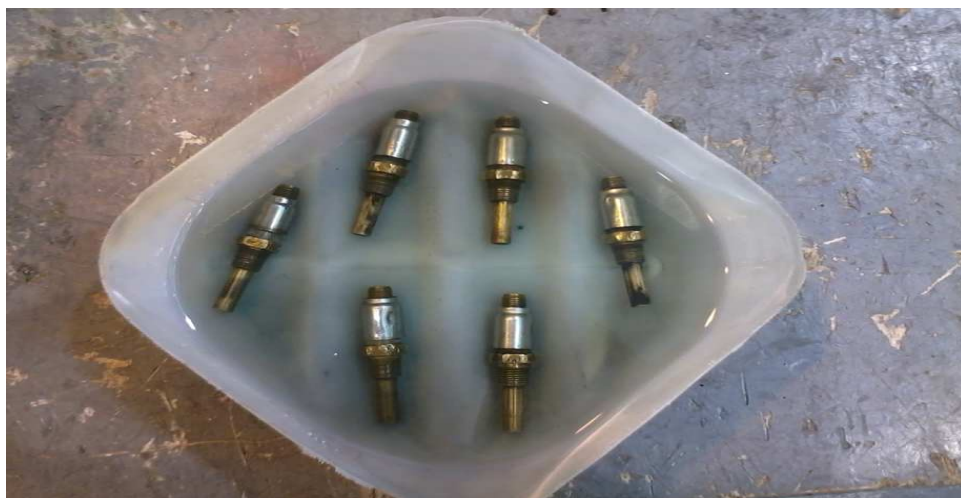
Figura 3.9. Proceso de inmersión en los inyectores
