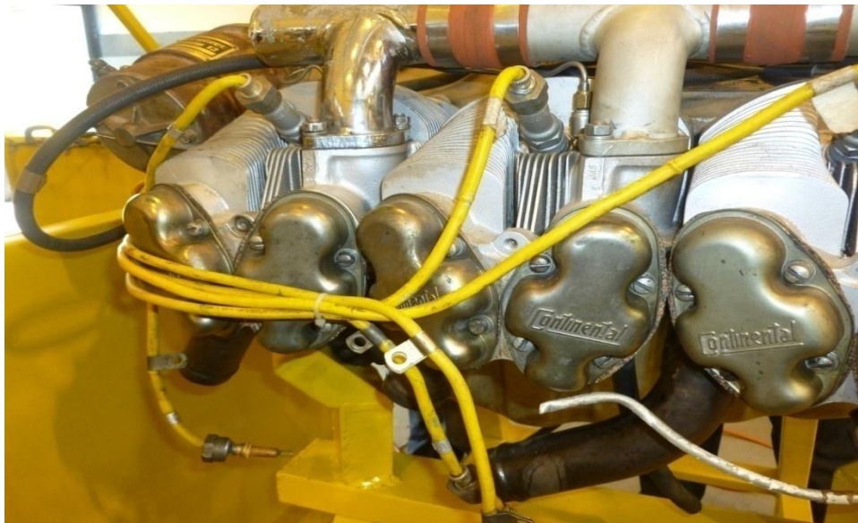
Figura 3.14 Habitación de Cables de Encendido
