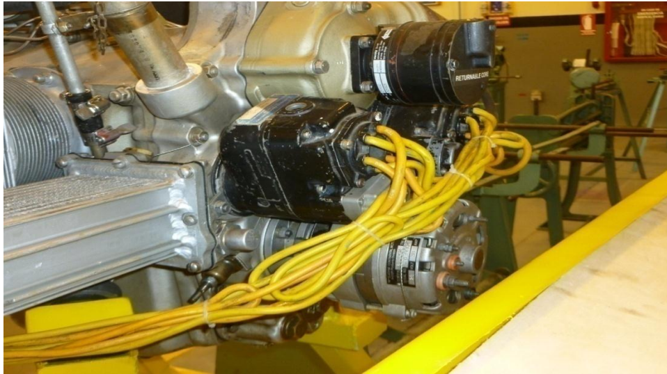
Figura 3.8 Cables de Encendido Limpios
