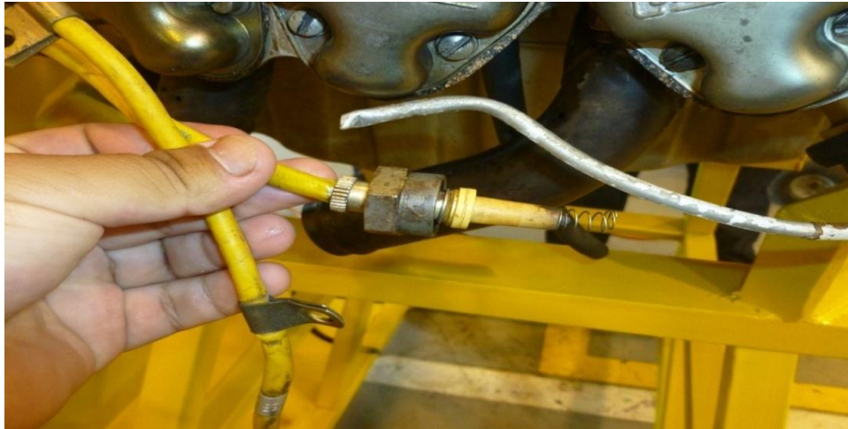
Figura 3.6 Limpieza de Terminales de Cables de Encendido
