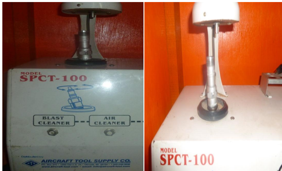
Figura 3.11 Limpieza en el Sandblaster Fuente: Investigación de Campo
