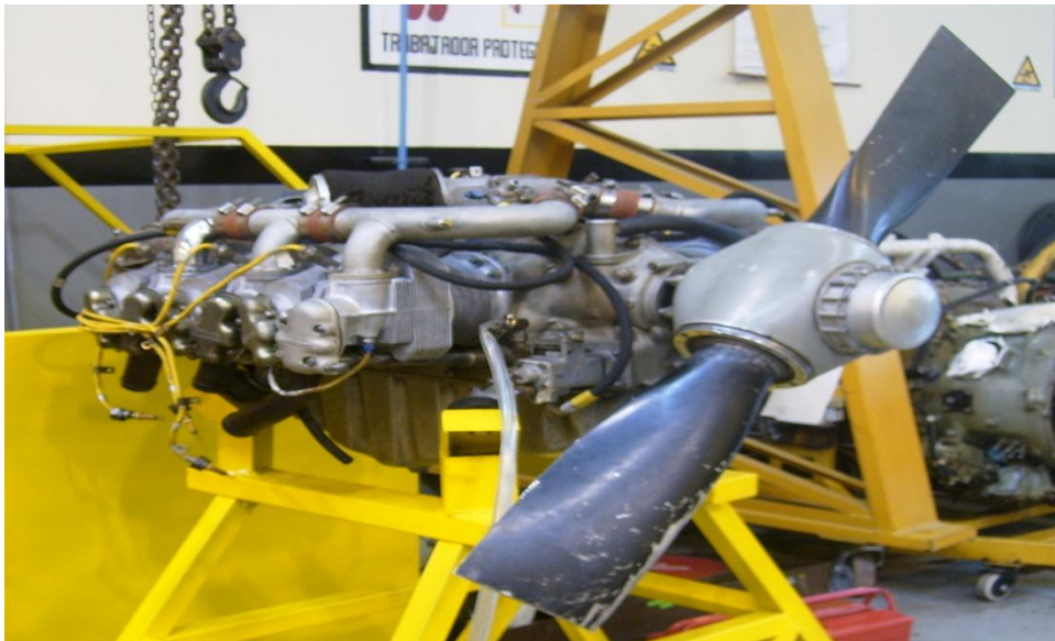
Figura 2.1 Motor Teledyne Continental IO – 360 – D21
