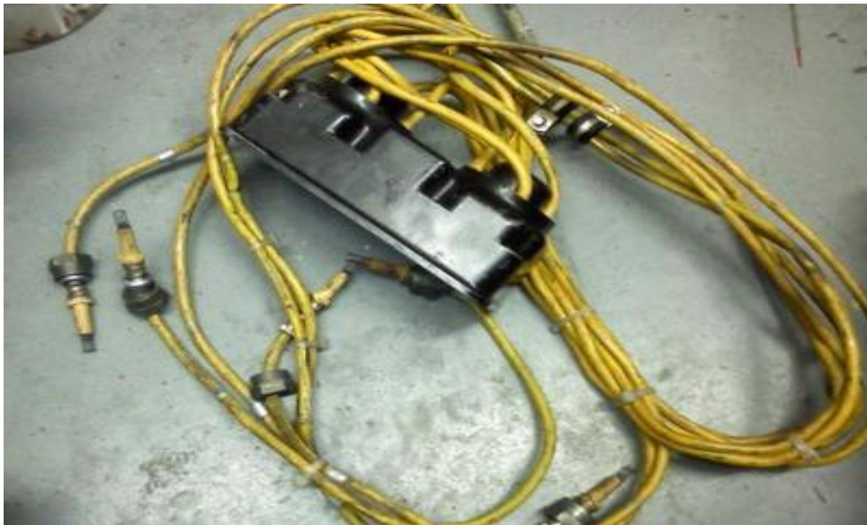
Figura 2.25 Cables de Encendido
