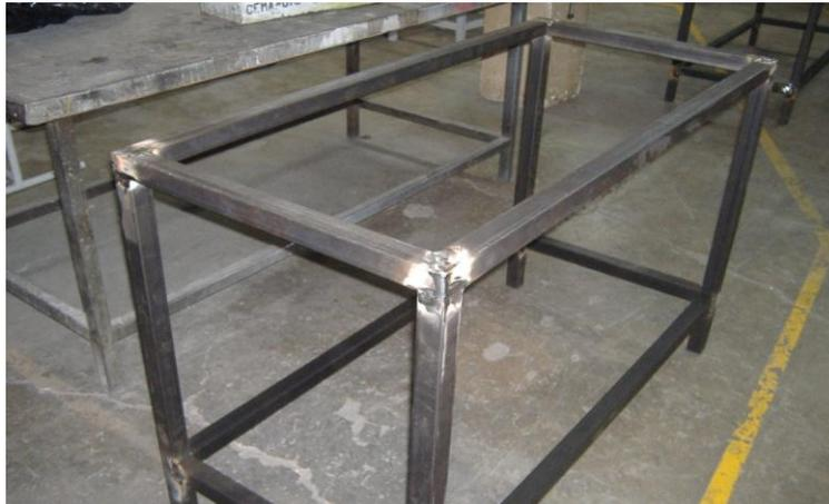
**Figura 3.4.** Estructura de la Mesa de Trabajo "B"
