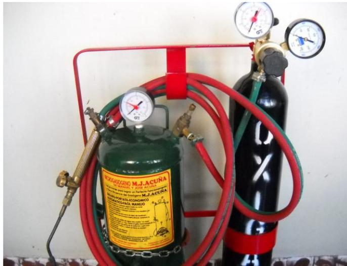
**Figura 2.14.** Soldadura a gas
