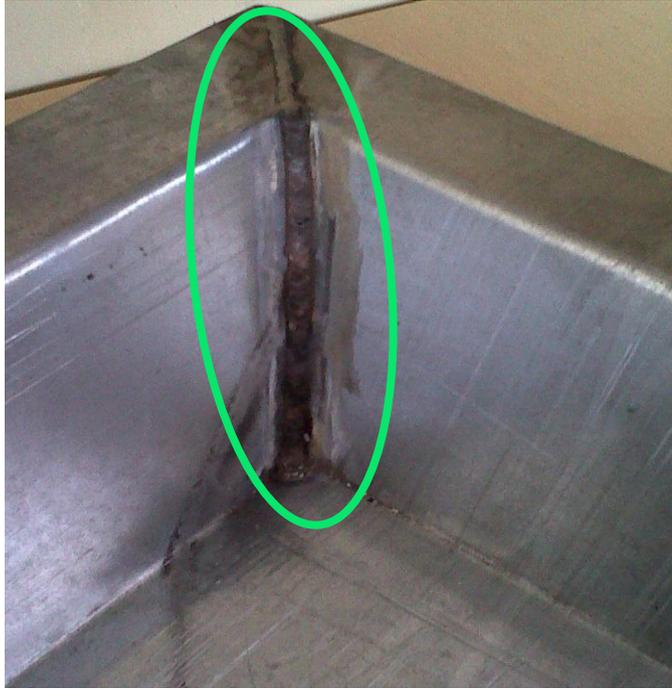
**Figura 3.7.** Suelta en las esquinas de la Bandeja
