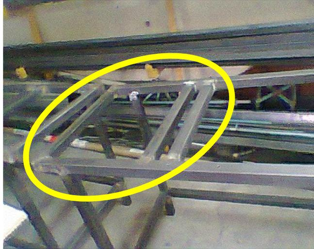
**Figura 3.6.** Estructura de Cajón Mesa de Trabajo “A”
