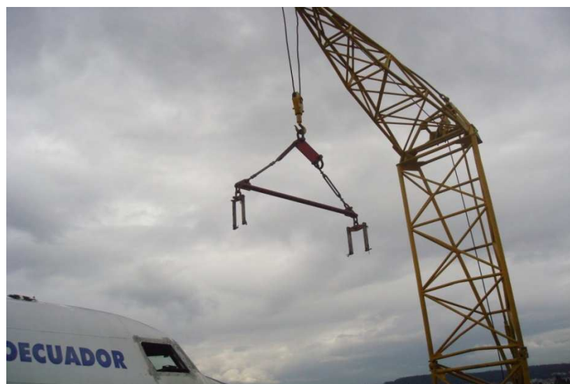
Figura 3.15: Eslinga sujeta al tecele Fuente: Investigación de campo Elaborado por: David Ramos
