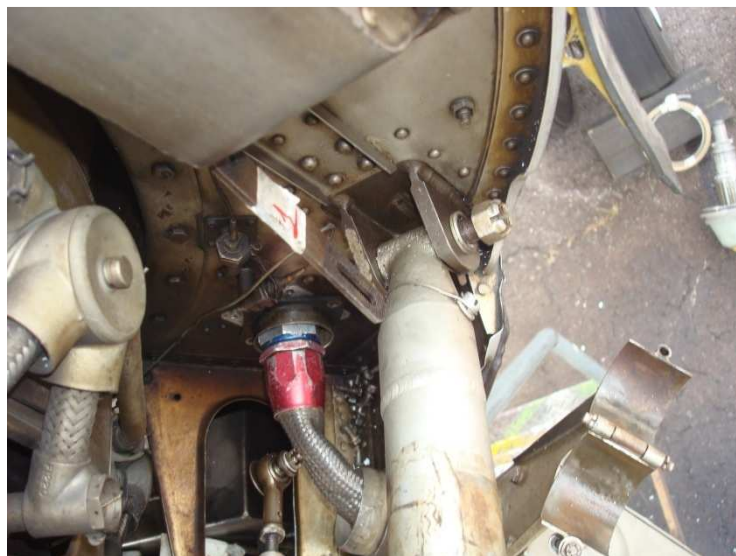
Figura 3.19: Pernos que sujetan al motor con el avión
