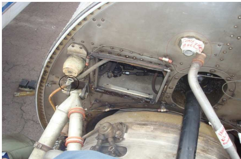
Figura 3.13: Desconexión de terminales a tierra
