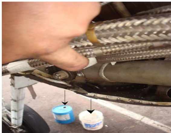
Figura 3.5: Drenado de líquidos del motor
