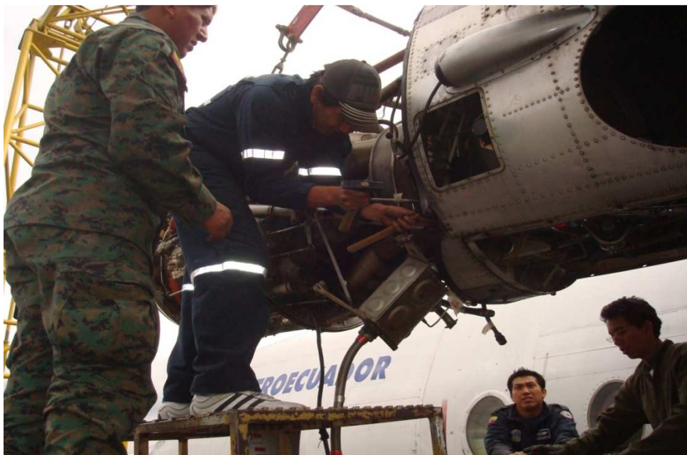
Figura 3.23: Retirado los pernos
