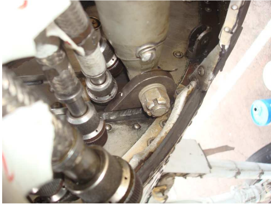
Figura 3.22: Pernos que sujetan al motor con el fuselaje
