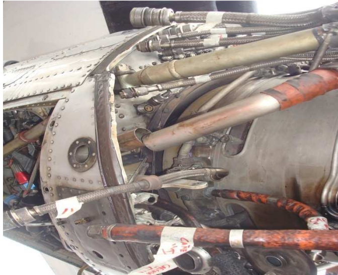
Figura 3.10: Desconexión de líneas Fuente: Investigación de campo Elaborado por: David Ramos
