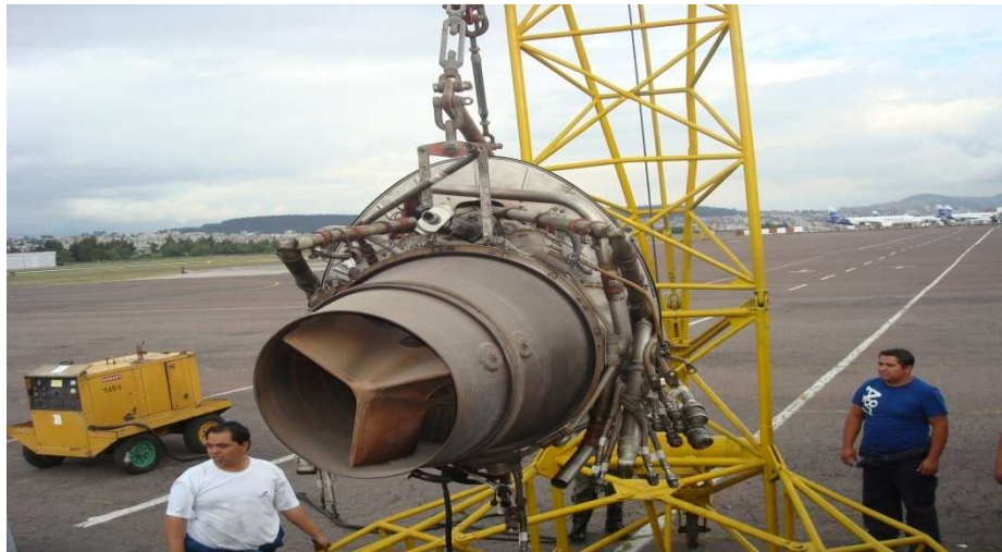
Figura 3.24: Descenso del motor utilizando eslinga y tecele Fuente: Investigación de campo. Elaborado por: David Ramos
