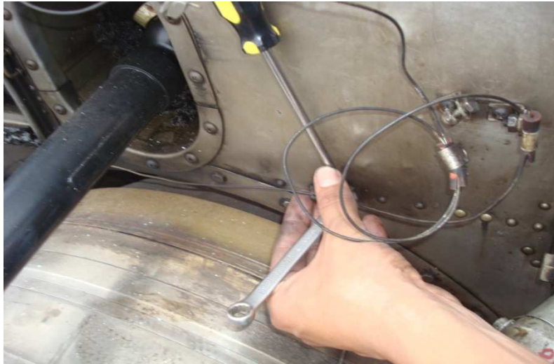
Figura 3.12: Desconexión del sistema de detección de fuego
