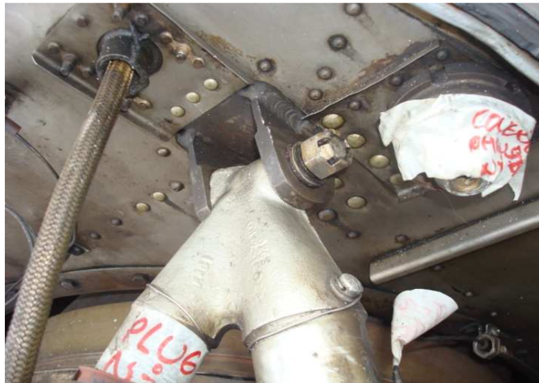
Figura 3.21: Pernos que sujetan al motor con el avión Fuente: Investigación de campo Elaborado por: David Ramos
