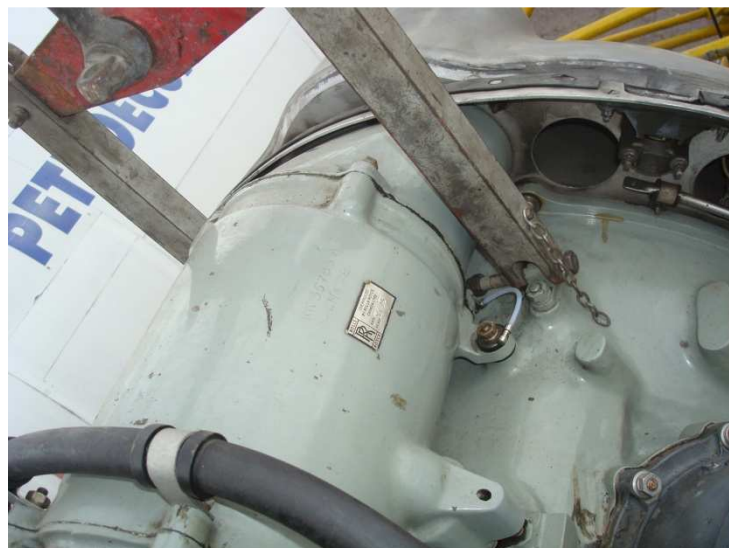
Figura 3.17: Colocación de los ganchos de la eslinga Fuente: Investigación de campo. Elaborado por: David Ramos.
