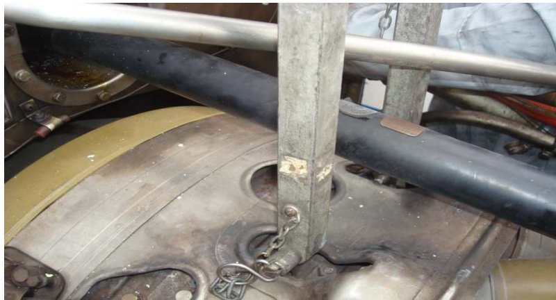
Figura 3.16: Colocación de los ganchos de la eslinga Fuente: Investigación de campo Elaborado por: David Ramos
