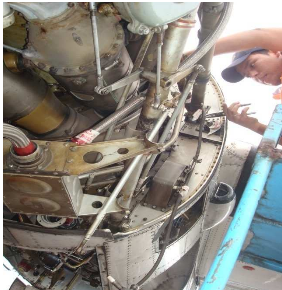
Figura 3.11: Desconexión del sistema ignición Fuente: Investigación de campo Elaborado por: David Ramos
