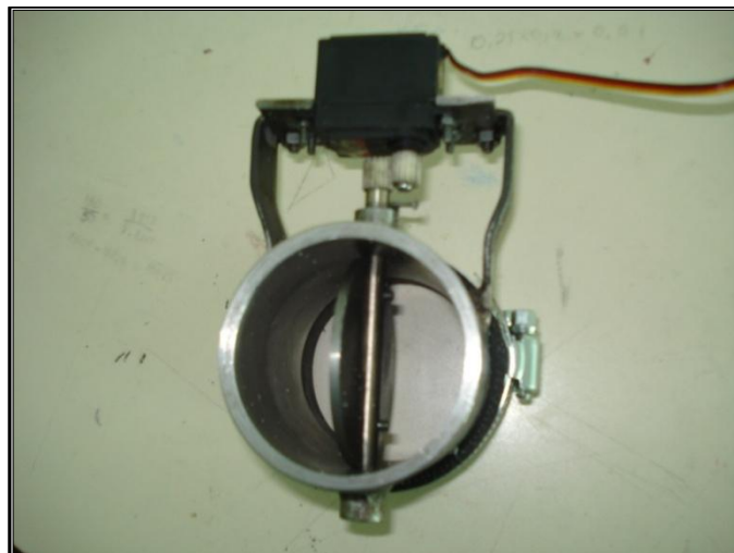
Figura 3.37.- Estrangulador acoplado con servomotor
