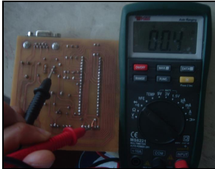
Figura 4.8.- Medición de continuidad sobre la placa
