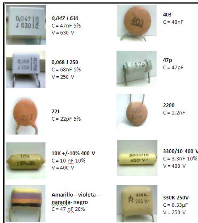
Figura 1.31.- Tipos de condensadores
