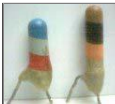
Figura 1.28.- Condensadores de poliéster tubular
