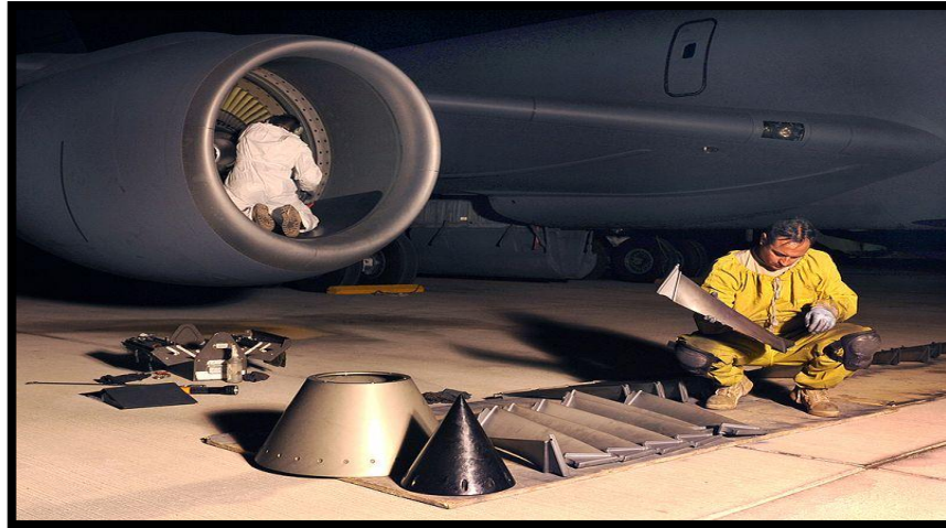
Figura 2.1. Inspección visual de álabes de compresor
