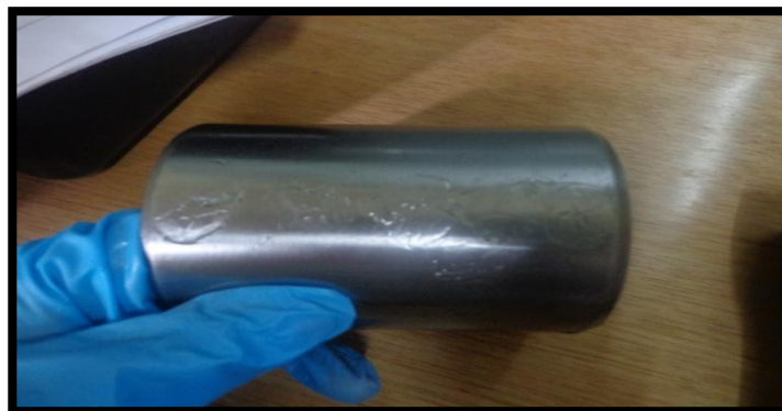
Figura 3.54. Preparación de la superficie del bloque P/N: NDTUT-RB-03.
