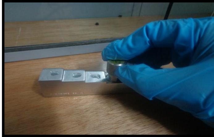
Figura 3.33. Probeta en contacto con el bloque de referencia de aluminio.
