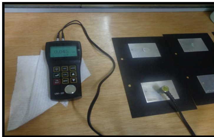
Figura 3.43. Medición de espesores intermedios
