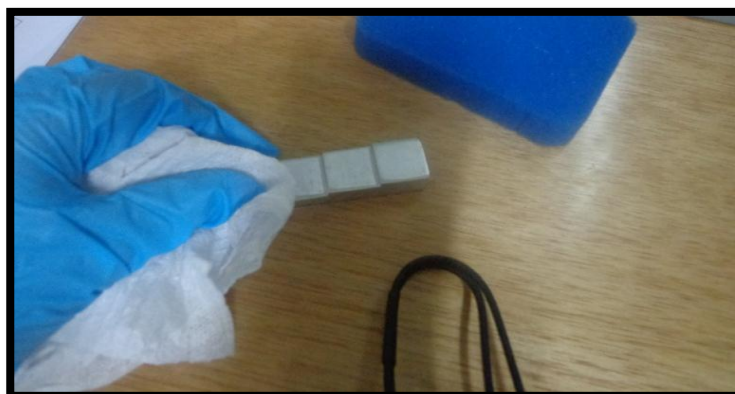
Figura 3.21. Limpieza de bloque P/N: NDTUT-RB-01 para ser examinado
