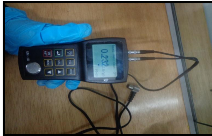
Figura 3.22. Ajuste de velocidad de sonido
