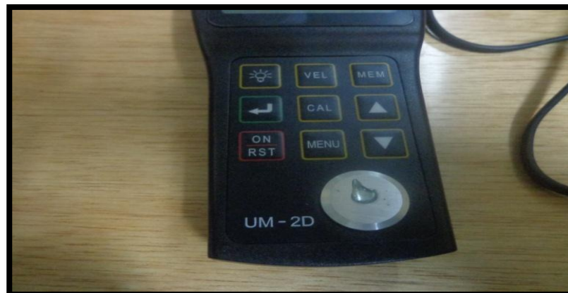
Figura 3.23. Gota de acoplante en el bloque de calibración
