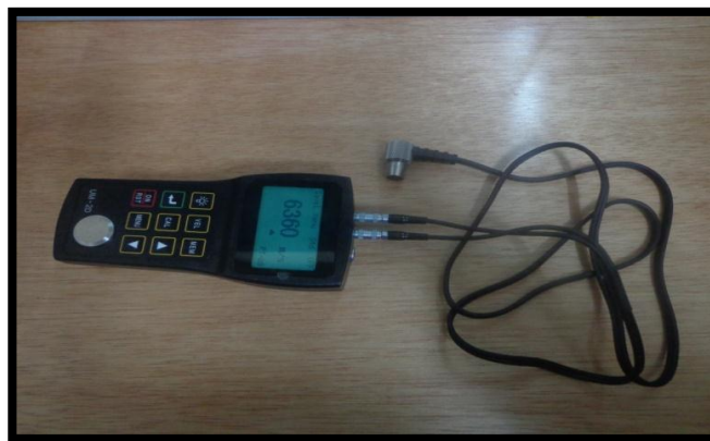
Figura 3.11. Encendido del equipo de medición de espesores
