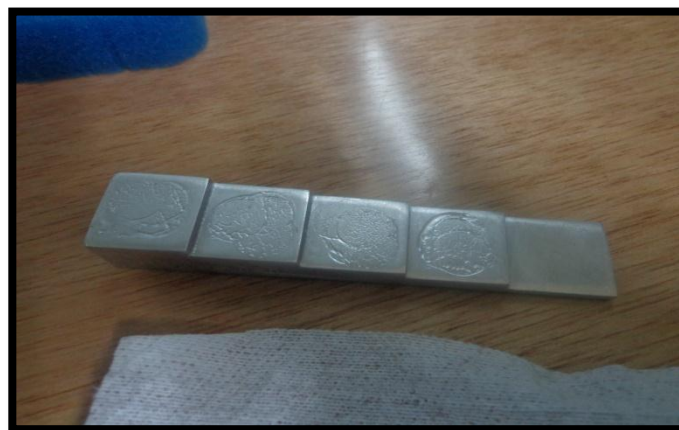
Figura 3.29. Limpieza del bloque de referencia después de la inspección.
