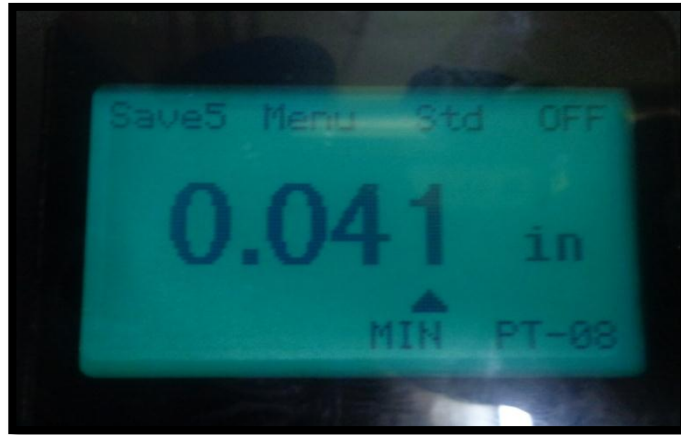
Figura 3.51. Captura del espesor mínimo de las cuatro medidas anteriores.
