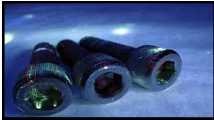
Figura 2.3. Pernos inspeccionados por líquidos penetrantes
