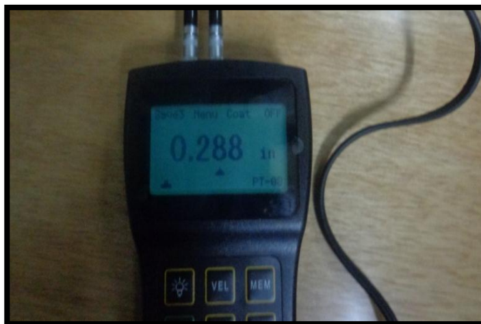
Figura 3.63. Medición del tercer escalón del bloque #1 (con recubrimiento).
