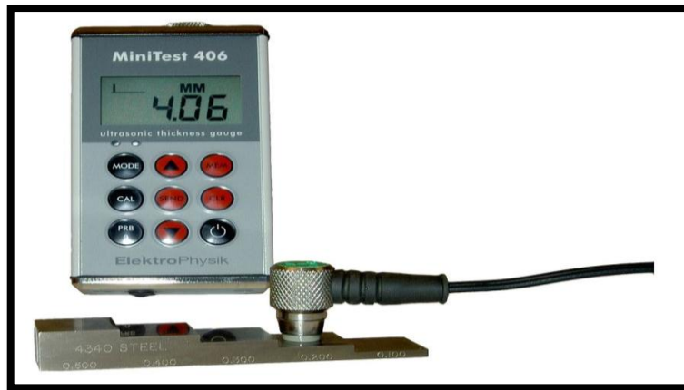
Figura 2.19. Calibración del equipo medidor de espesores
