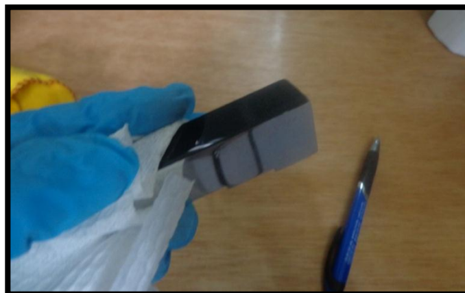
Figura 3.36. Limpieza final del Bloque de referencia de aluminio.
