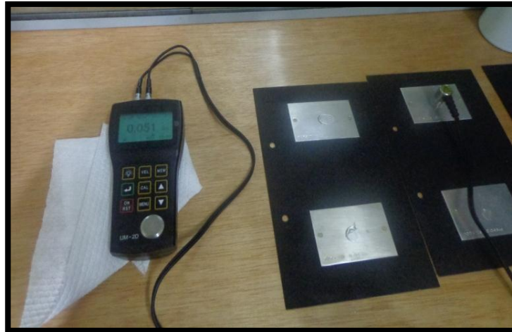
Figura 3.49. Medición del espesor #3
