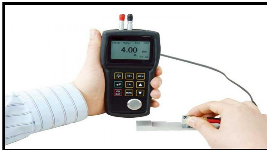
Figura 2.18. Equipo medidor de espesores
