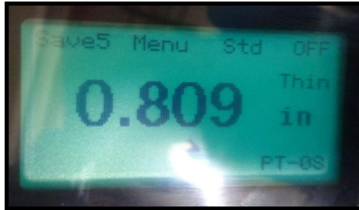
Figura 3.40. Calibración del espesor menor
