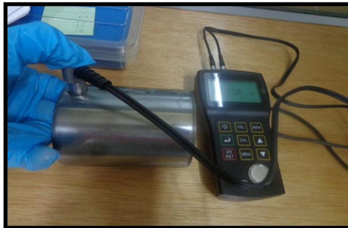
Figura 3.56. Medición de espesores de tubo con escalones internos.
