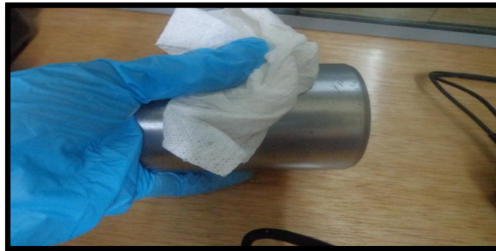
Figura 3.57. Limpieza del bloque de referencia #3.
