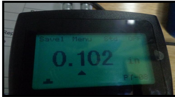
Figura 3.28. Medición del espesor del primer escalón del bloque NDTUT-RB-01.
