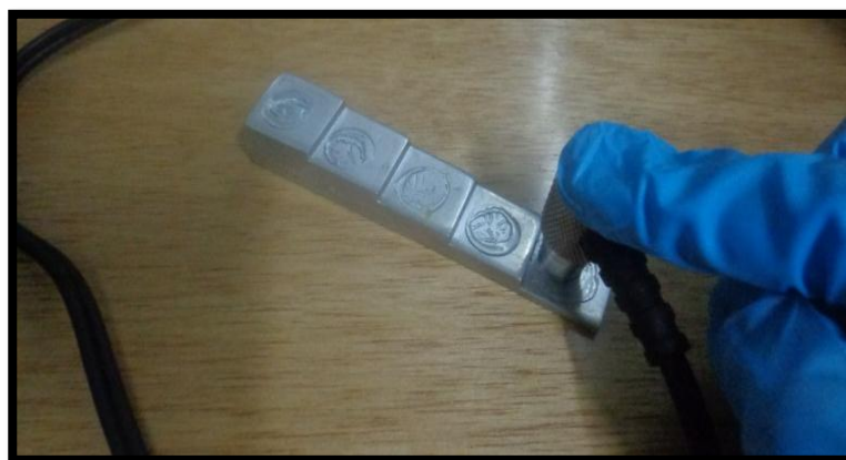
Figura 3.27. Probeta PT-08 en contacto con la superficie del bloque NDTUT-RB-01.
