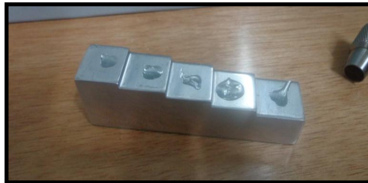
Figura 3.32. Bloque de referencia de aluminio con acoplante.
