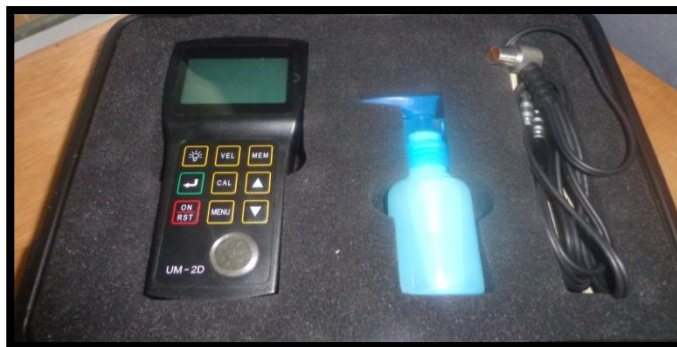
Figura 3.10. Equipo de medición de espesores y acoplante
