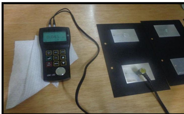
Figura 3.48. Medición del espesor #2
