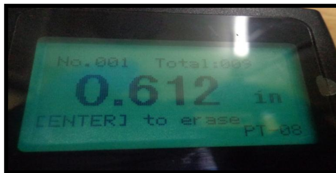
Figura 3.69. Lectura de datos almacenados del primer escalón del bloque #2.
