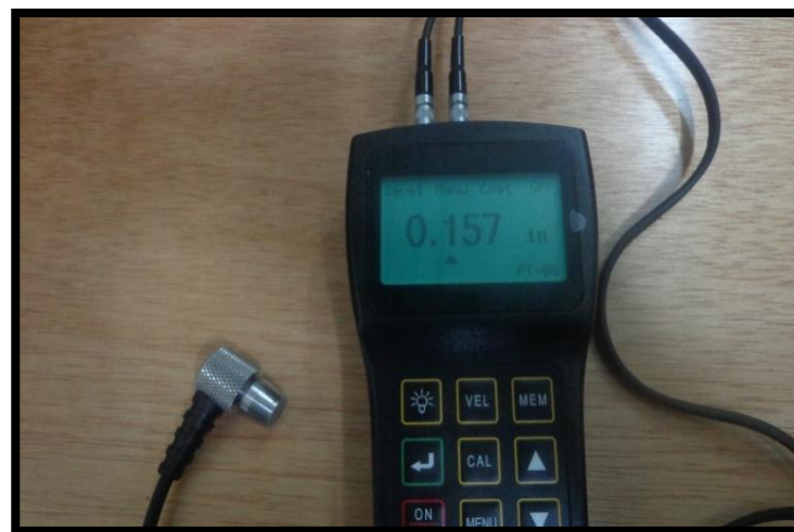
Figura 3.25. Probeta sin contacto con el bloque de calibración
