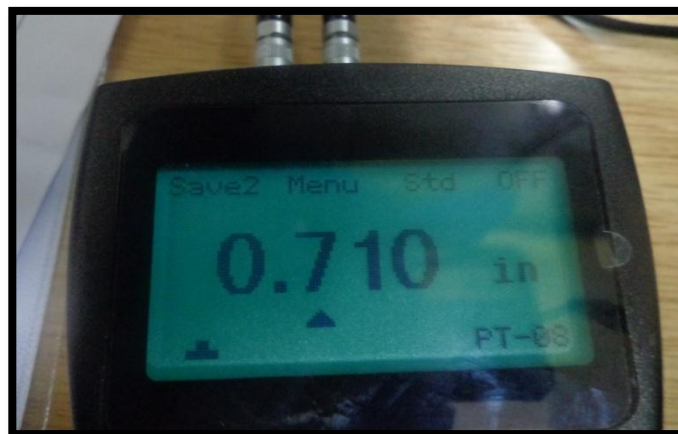
Figura 3.34. Espesor medido del segundo escalón del bloque de referencia.
