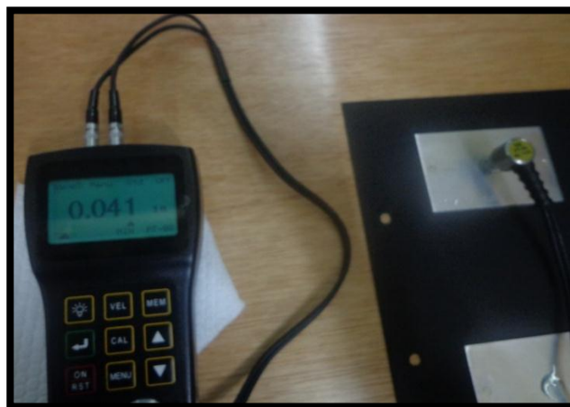
Figura 3.47. Medición del espesor #1 (menor)
