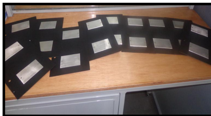
Figura 3.46. Preparación de láminas 2024 T3 para su inspección
