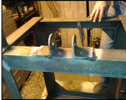
Figura 3.27: Soldado de punto de sujeción para barra de traslado del montante
