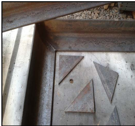
Figura 3.18: Medición, trazado y corte del material
