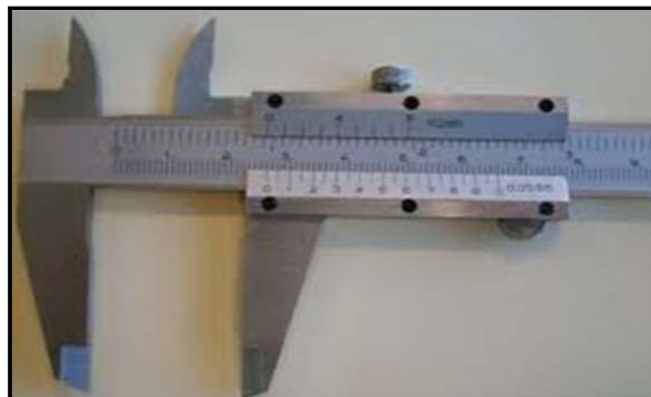
Figura 2.31: Calibrador pie de rey
