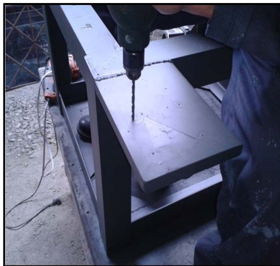
Figura 3.26: Taladrado para sujeción de ruedas
