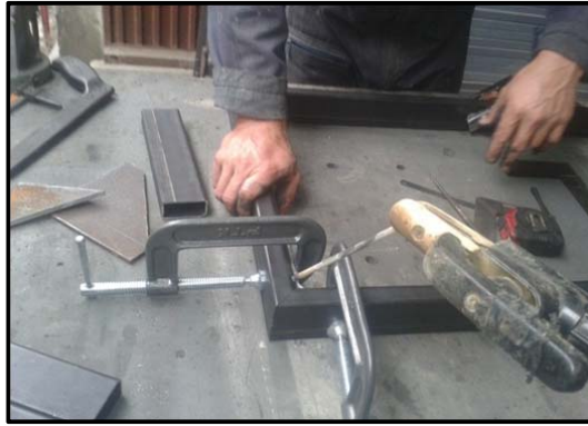
Figura 3.30: Soldado de la base rectangular
