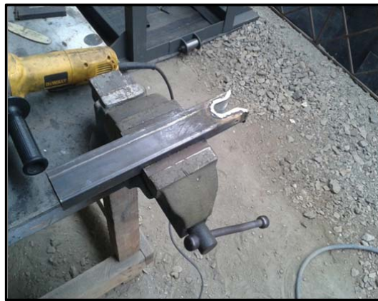
Figura 3.35: Muesca “U” del soporte frontal
