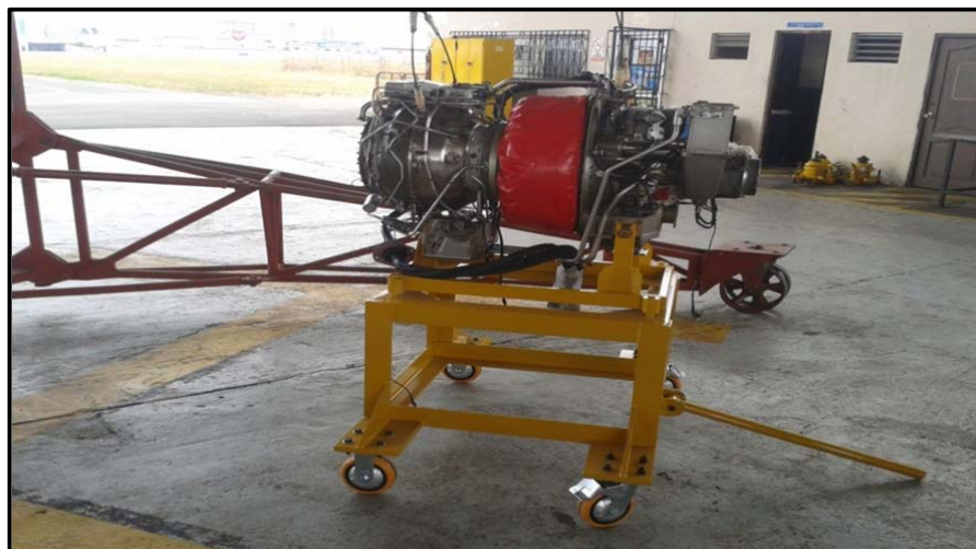
Figura 3.44: Montante con el motor Turbomeca TM 333 2B2
