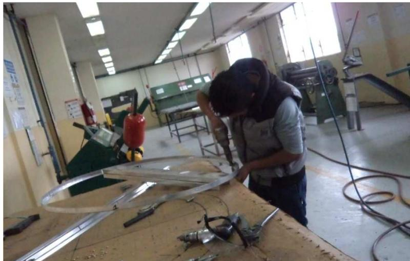
**Figura 3.34** Remachado de los circunferenciales con los floor beam
