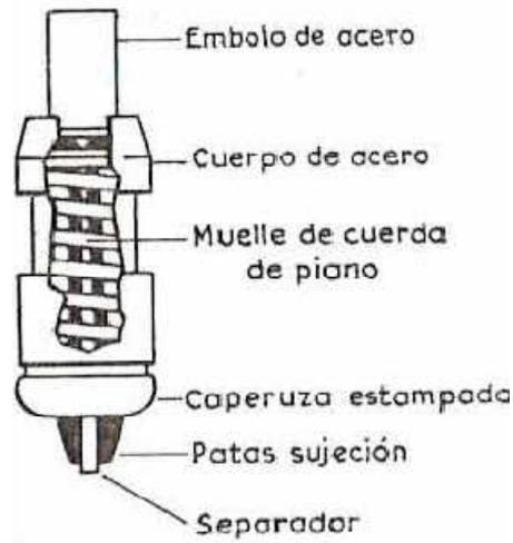
**Figura 2.20** Elementos del sujetador Wedglock
