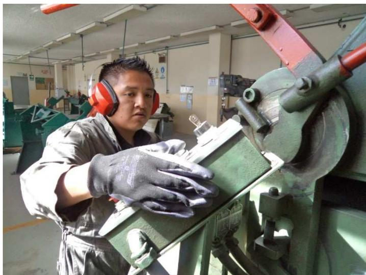
**Figura 3.10** Activación máquina dobladora
