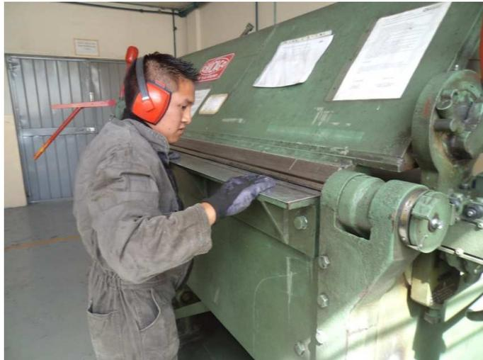
**Figura 3.6** Doblado Floor beam
