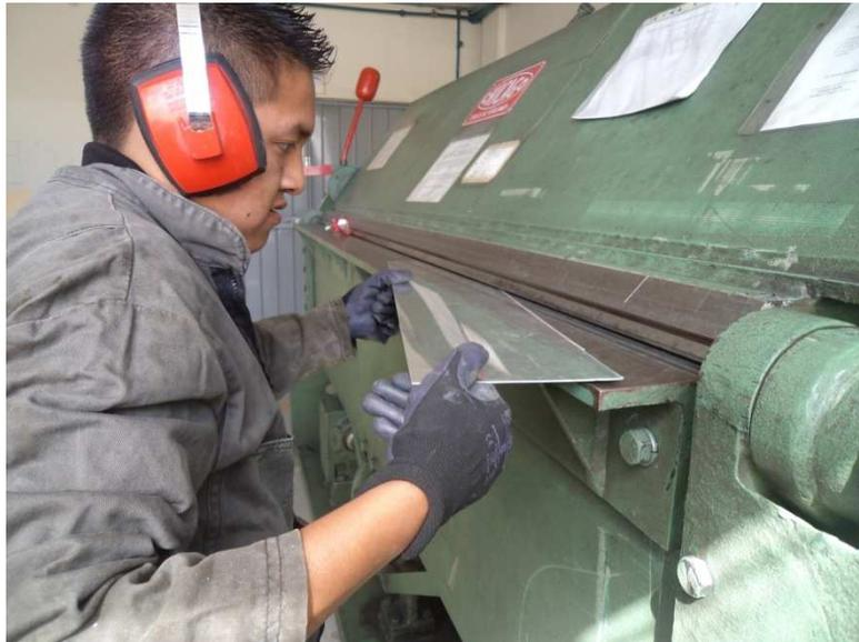
**Figura 3.8** Doblado Floor beam
