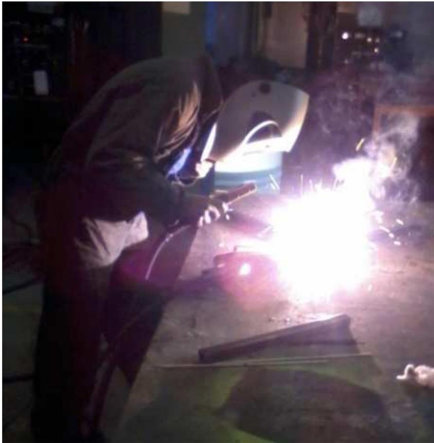
**Figura 3.51** Soldadura de las partes del soporte
