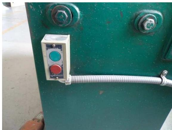
**Figura 3.4** Botones de control de la cortadora
