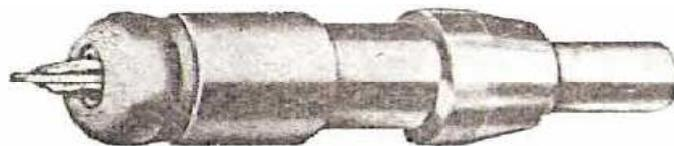
**Figura 2.19** Sujetador Wedglock para planchas metálicas
