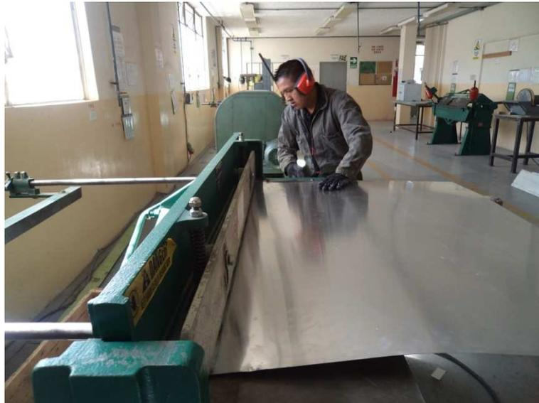
**Figura 3.24** Cortado de la lámina
