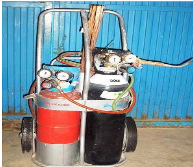
Figura 2.2. Coche para transportar cilindros de distintos gases
