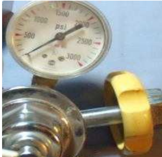
Figura 2.9. Manómetro indicador de presión tanque
