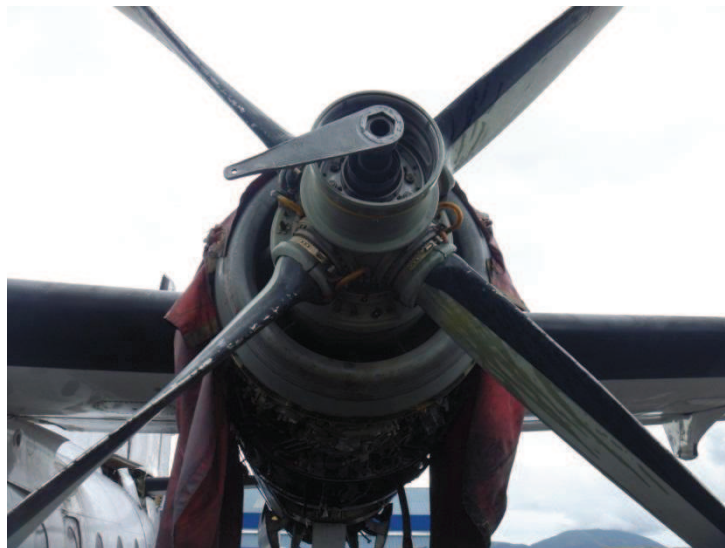
Figura 3.36 Remoción de la tuerca de retención de la hélice. Fuente: Investigación de campo.
