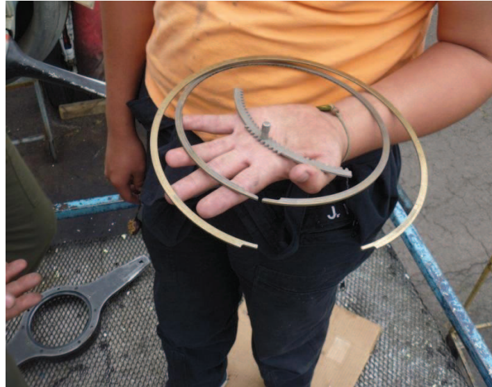
Figura 3.29 Seguros de la tuerca de Retención del Pitch Lock. Fuente: Investigación de campo.
