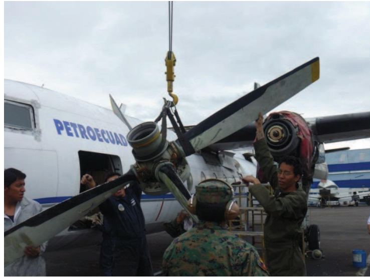
Figura 3.41 Izamiento de la hélice. Fuente: Investigación de campo.
