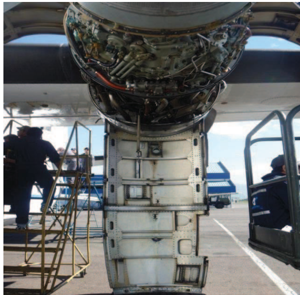
Figura 3.21 Remoción de las compuertas de acceso al motor. Fuente: Investigación de campo.
