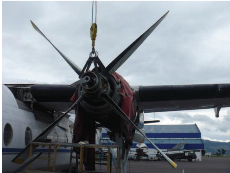
Figura 3.37 Remoción de la tuerca de retención de la hélice. Fuente: Investigación de campo.
