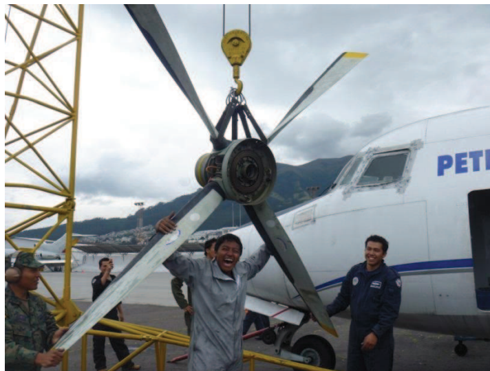
Figura 3.40 Izamiento de la Hélice. Fuente: Investigación de campo.
