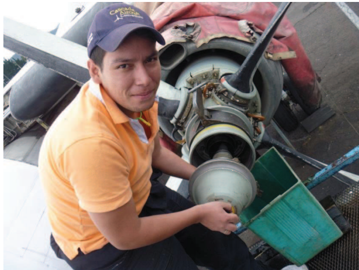
Figura 3.34 Desmontaje del pitch lock. Fuente: Investigación de campo.
