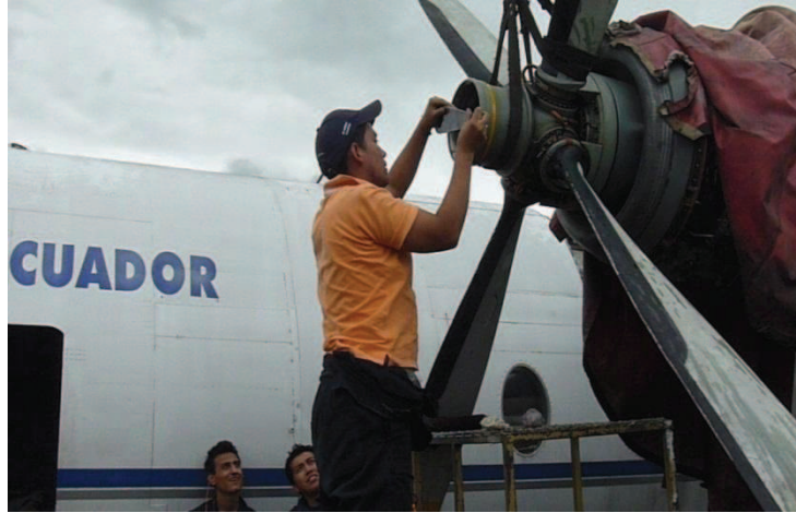
Figura 3.39 Remoción de la tuerca de retención de la hélice. Fuente: Investigación de campo.
