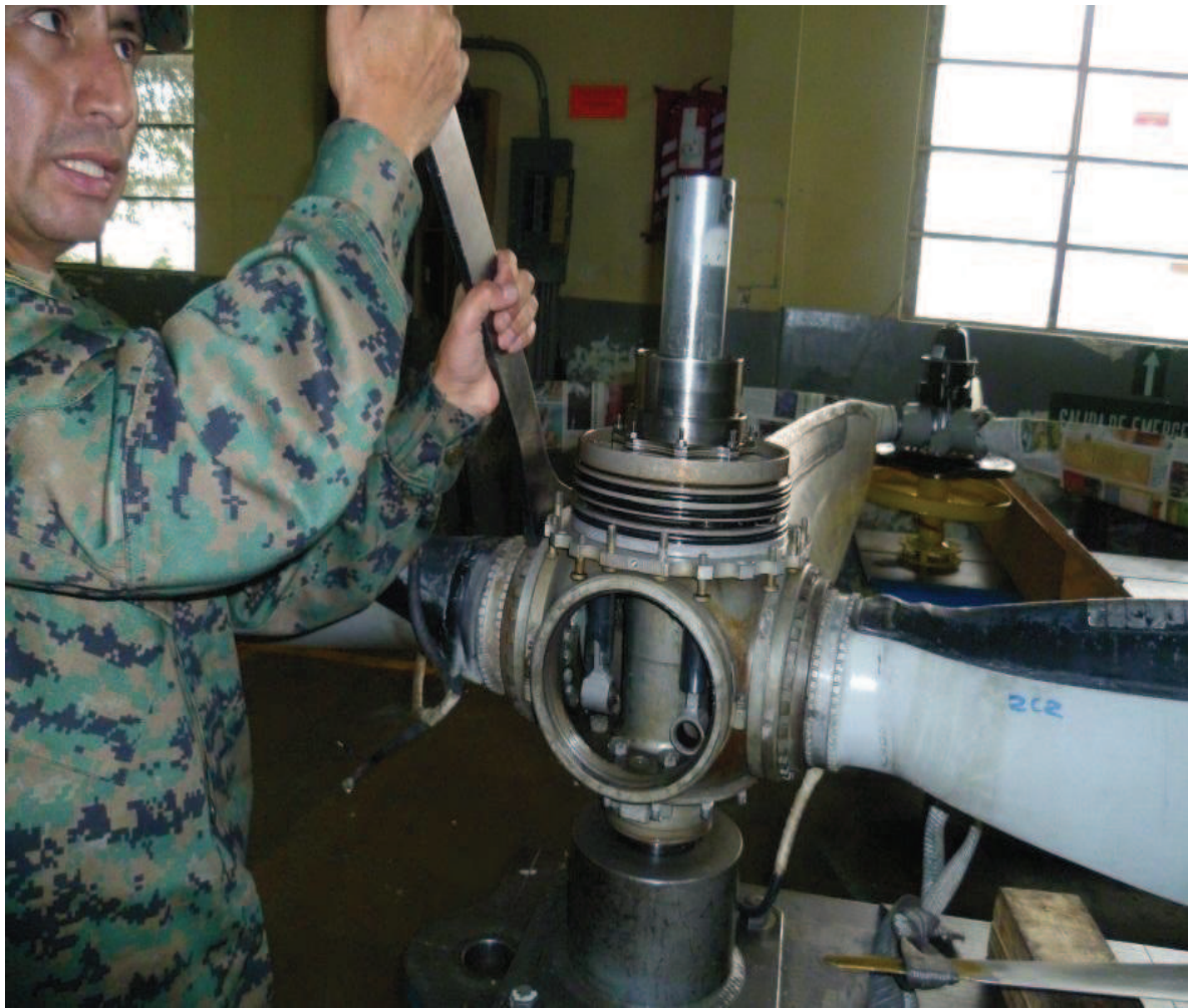
Banco y herramienta para el desmontaje de la helice.
