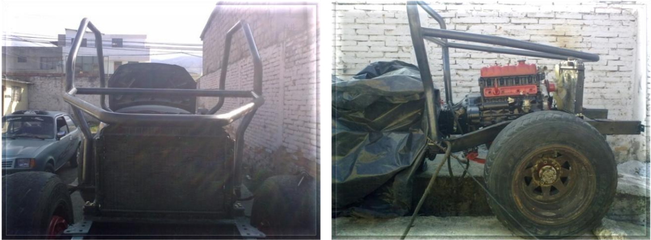
Fig. 4.18 (a) Tubo soporte del capot vista frontal (b) Tubo soporte del capot vista lateral
