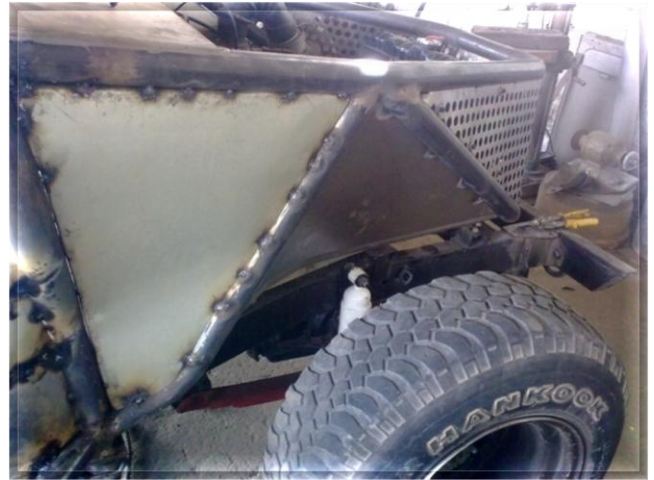
Fig. 4.36 (a) Piezas laterales (b) Cubrimiento lateral del motor
