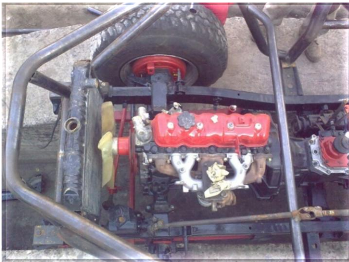
Fig. 4.26 (a) Vista superior del motor con la estructura tubular (b) Estructura ensamblada en el chasis con los elementos
