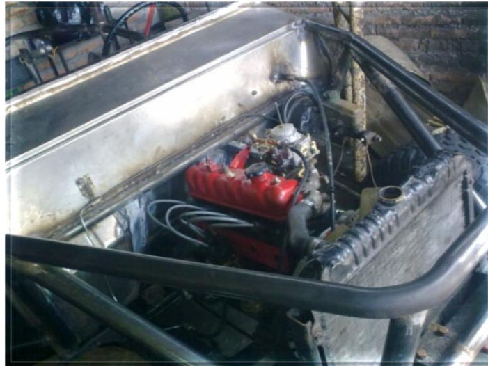
Fig. 3.6 Motor armado en chasis y estructura tubular
