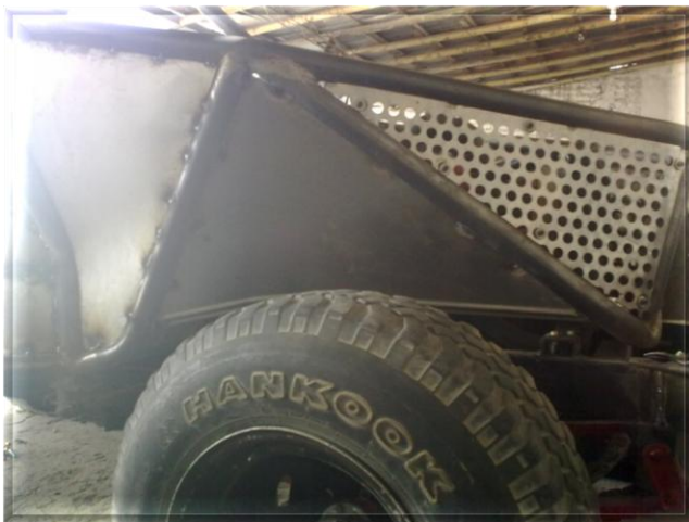
Fig. 4.37 (a) Piezas frontales (b) Cubrimiento frontal del motor
