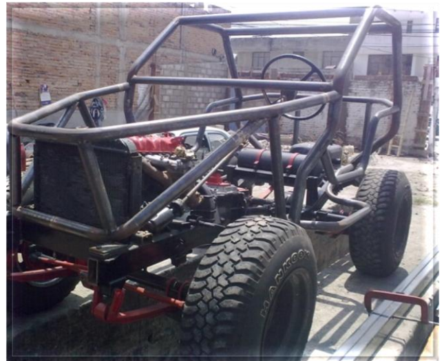
Fig. 4.25 (a) Parte lateral del chasis y estructura tubular (b) Frontal y protección del motor
