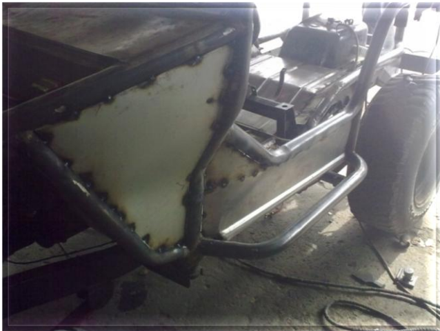
Fig. 4.36 (a) Piezas laterales (b) Cubrimiento lateral del motor
