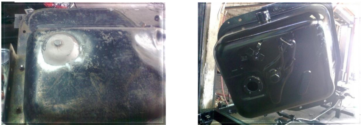
Fig. 4.27 (a) Tanque en la posición original (b) Tanque en la nueva posición sobre el chasis
