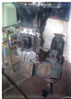
Fig. 3.8 (a) Desmontaje de caja de cambios (b) Inspección caja de cambios (c) Cambio de cauchos y retenes
