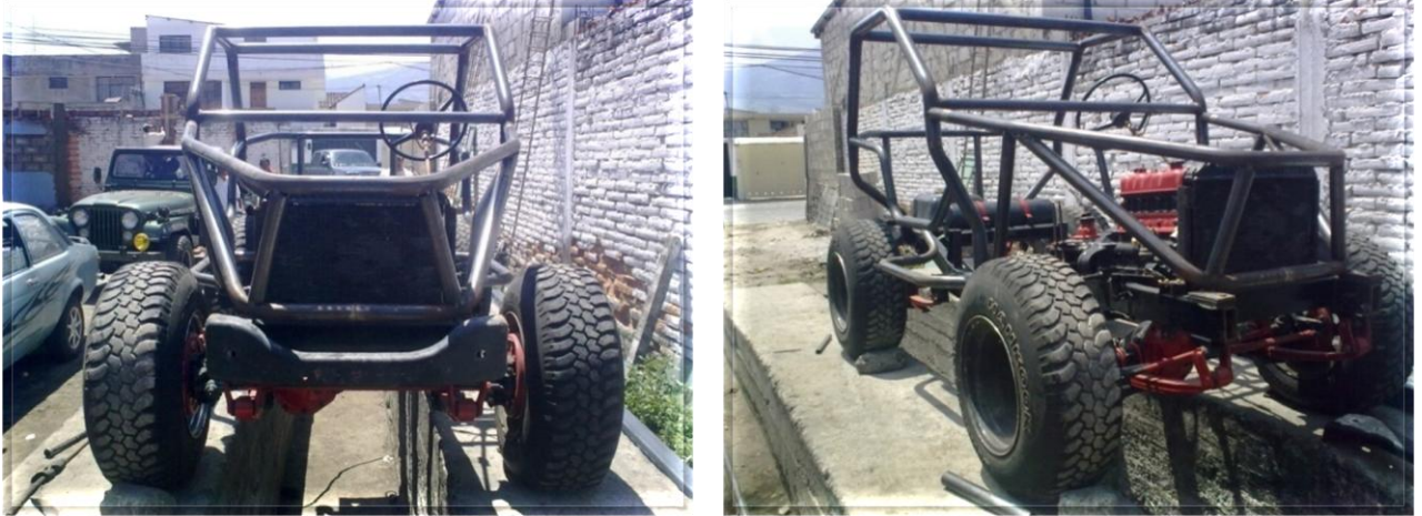
Fig. 4.20 (a) Frente y tubos medias puertas terminadas (b) Frente y tubos medias puertas terminadas
