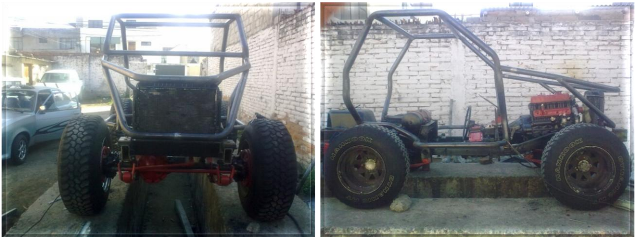
Fig. 4.19 (a) Tubos superiores, tubos laterales inferiores y tubo protección motor frente vista frontal (b) Tubos superiores, tubos laterales inferiores y tubo protección motor frente vista lateral
