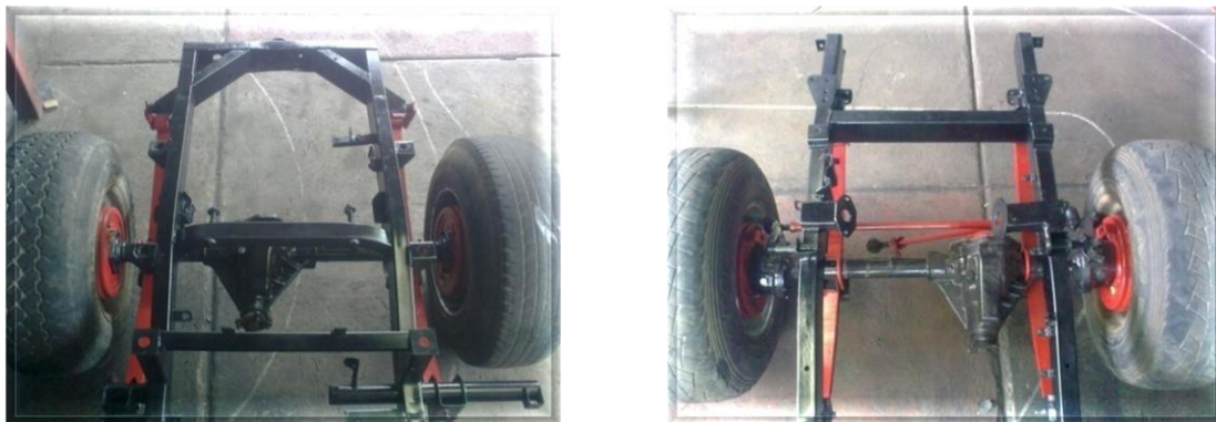
Fig. 3.14 (a) Transmisión trasera montada en el chasis (b) Transmisión delantera montada en el chasis
