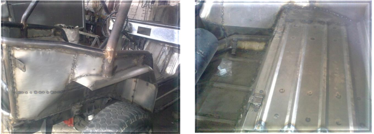
Fig. 4.38 (a) Piezas laterales traseras (b) Cubierta trasera del tanque de gasolina
