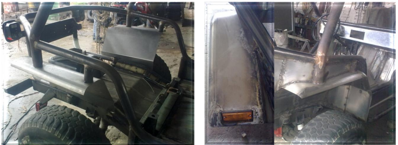
Fig. 4.41 (a) Guardafangos traseros cortados (b) Guardafangos traseros montados
