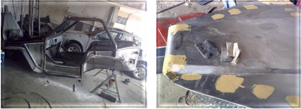
Fig. 4.48 (a) Carrocería completamente masillada (b) Capot masillado
