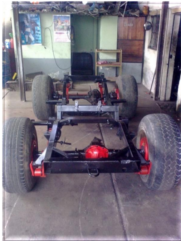
Fig. 3.16 Adaptación final de las Transmisiones en el chasis
