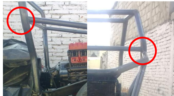
Fig. 4.4 (a) Método A de corte por aserrado (b) Método de corte utilizando en la estructura (aserrado)
