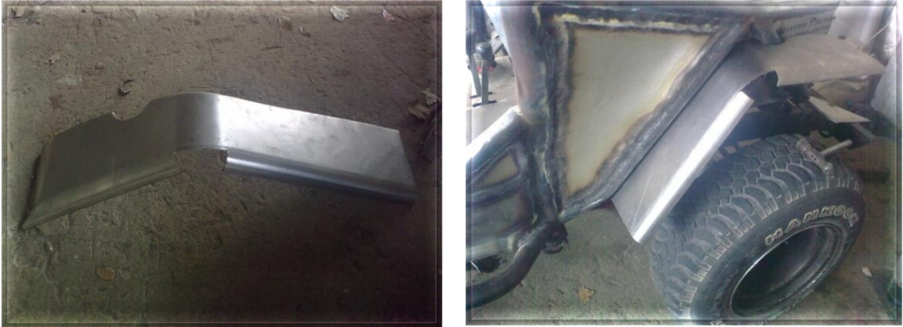
Fig. 4.40 (a) Guardafangos cortado y doblado (b) Guardafangos delanteros montados
