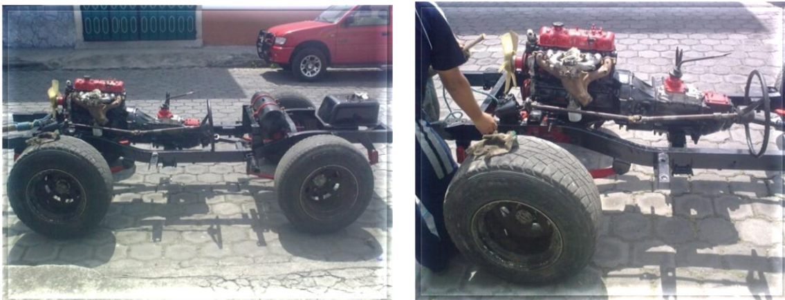
Fig. 4.23 (a) Motor y Transmisiones montadas (b) Caja de cambios montada
