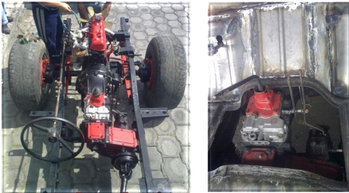
Fig. 3.10 (a) Caja de cambios montada en chasis (b) Caja de cambios montada en chasis y estructura
