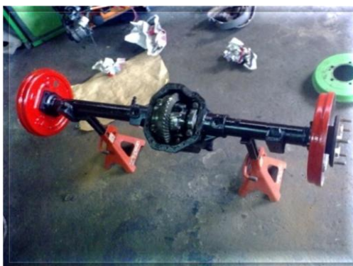
Fig. 3.12 Transmisión trasera destapada y revisada
