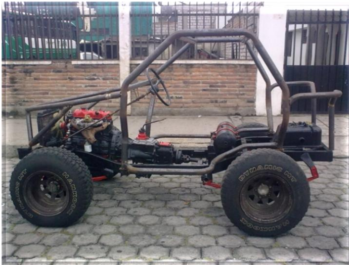
Fig. 4.25 (a) Parte lateral del chasis y estructura tubular (b) Frontal y protección del motor
