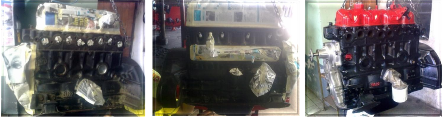
Fig. 3.4 (a) Etapa pre-pintura (b) Enmascarado del motor (c) Motor pintado Parte Lateral
