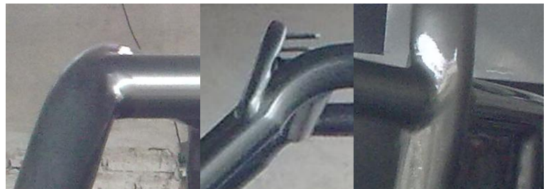
Fig. 4.11 (a) Soldadura vertical ascendente (Dibujo SolidWorks), (b) Soldadura vertical ascendente utilizada en la estructura
