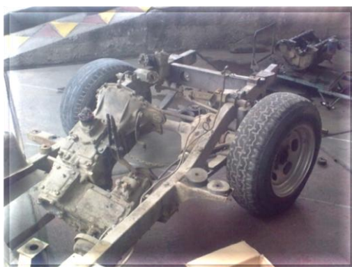
Fig. 3.8 (a) Desmontaje de caja de cambios (b) Inspección caja de cambios (c) Cambio de cauchos y retenes
