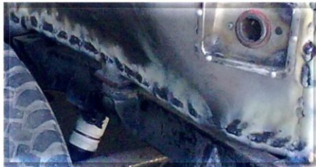
Fig. 4.33 Soldadura por puntos continuos
