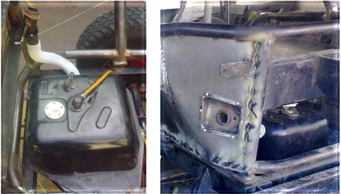
Fig. 4.29 (a) Tanque adaptado en chasis y la estructura tubular (b) Toma de carga de gasolina en la estructura
