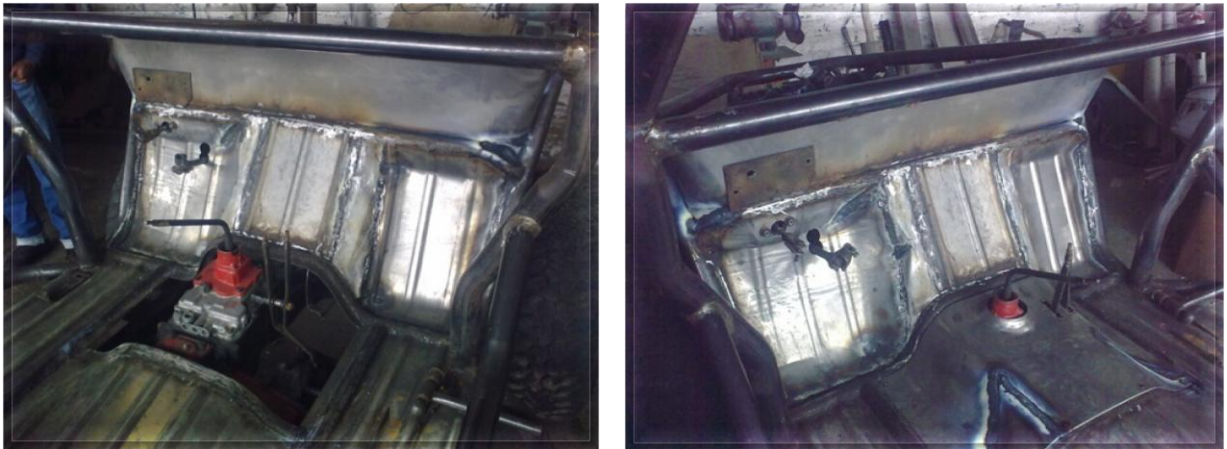
Fig. 4.30 (a) Piso fabricado (b) Tapa que cubre los mandos de la caja de cambios
