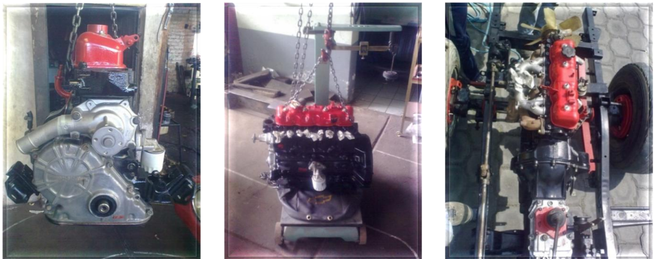
Fig. 3.5 (a) Motor pintado Parte Frontal (b) Pesaje del motor (c) Motor adaptado en chasis
