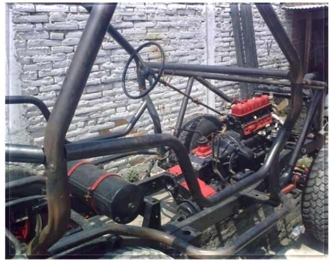
Fig. 4.26 (a) Vista superior del motor con la estructura tubular (b) Estructura ensamblada en el chasis con los elementos
