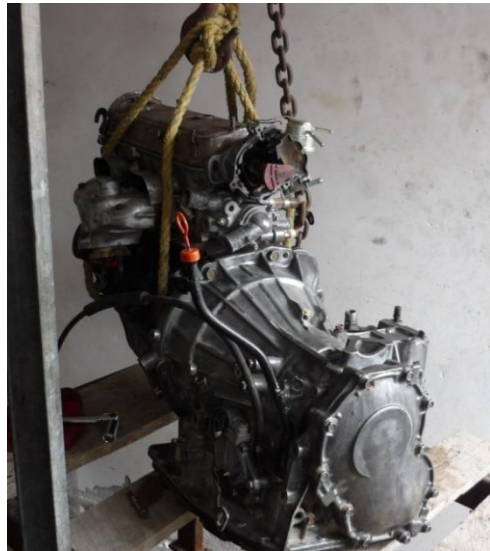
Figura 3.16 Preparación previa caja-motor.
