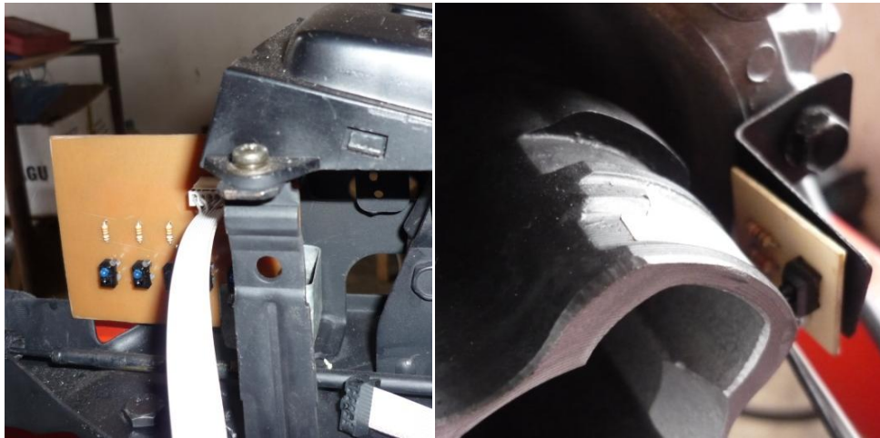
Figura 3.22 Colocación de sensores.
