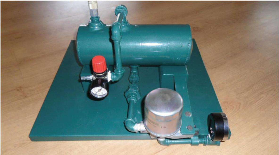
**Figura N° 28:** Comprobador de inyectores concluido (Frente)
