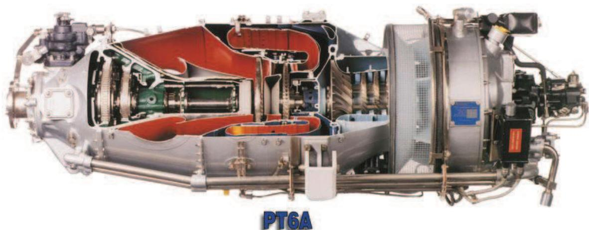
**Figura N° 3:** Motor seccionado PT6A
