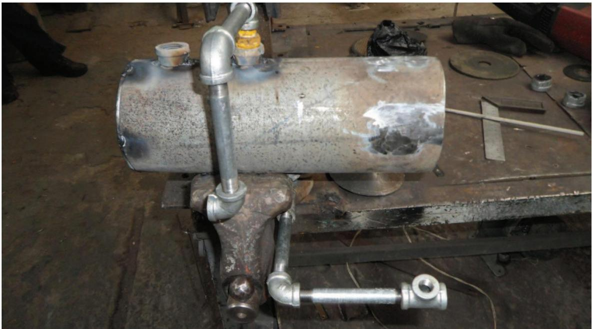
**Figura N° 26:** Conexiones de sistema neumático y de combustible.
