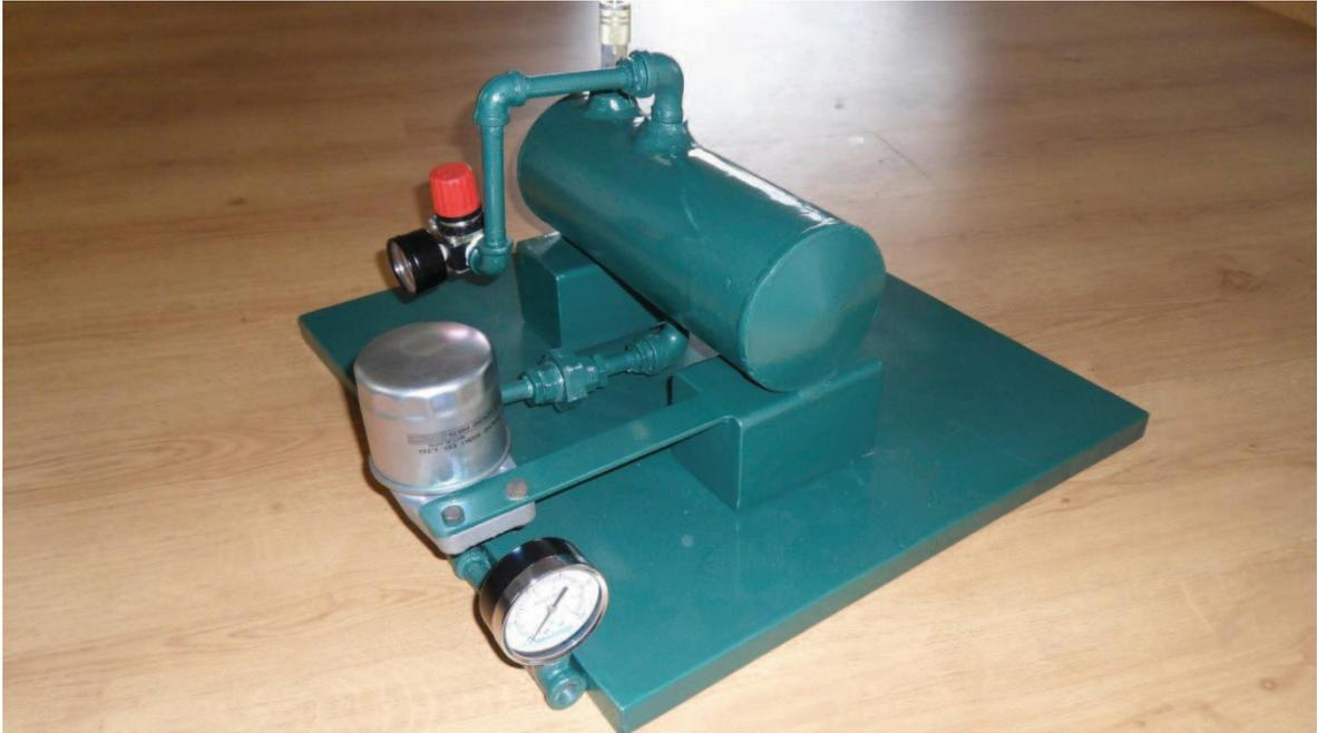
**Figura N° 29:** Comprobador de inyectores concluido (costado)
