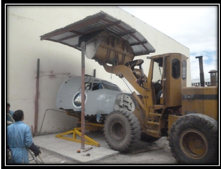
Levantamiento y ubicación de cabina y techo a través de una pala.
