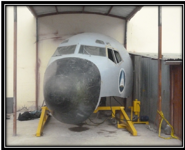
Estructura simuladora de los movimientos de una aeronave ejecutándose en las pruebas operacionales, y realizando los movimientos sin ningún inconveniente.
