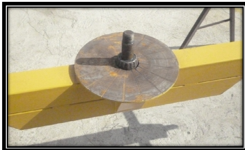
Figura 3.33. Eje sobre el que se monta el perfil cuadrado.
