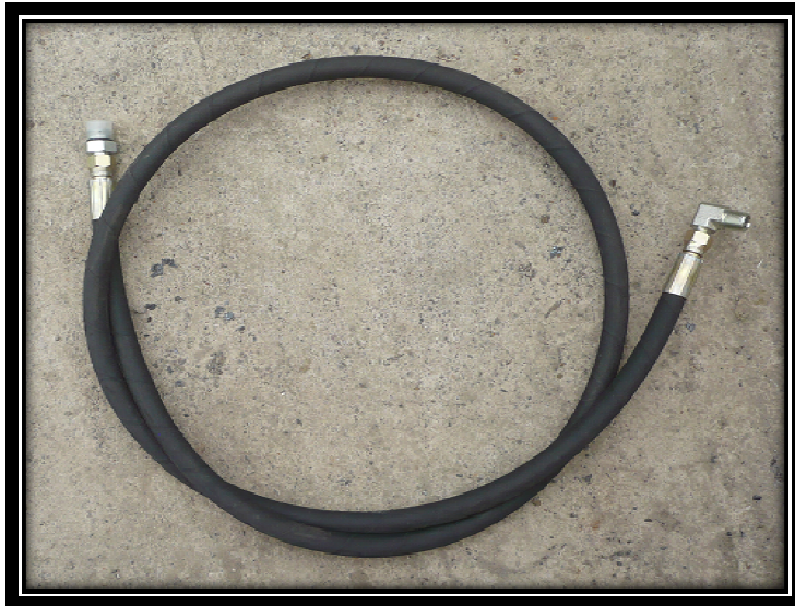
Figura 3.26. Cañería flexible de diámetro 3/8
