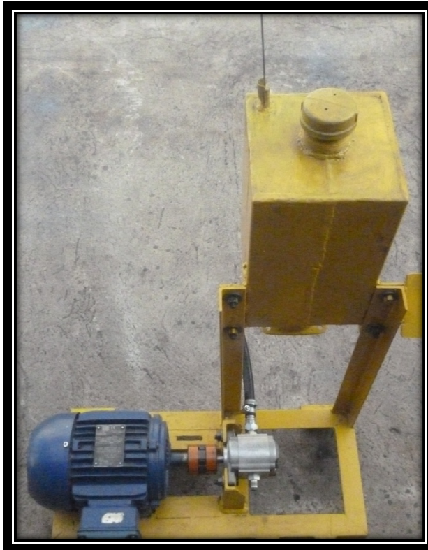
Figura 3.27. Depósito de aceite hidráulico
