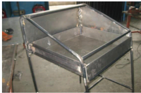
Figura 3.8 Proceso de construcción de la caja de herramientas Fuente: Investigación de campo.
