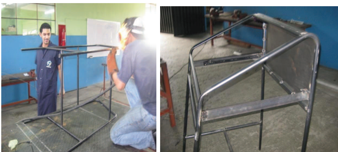
Figura 3.6 Proceso trazado y unión de la tapa trasera a la estructura metálica Fuente: Investigación de campo.
