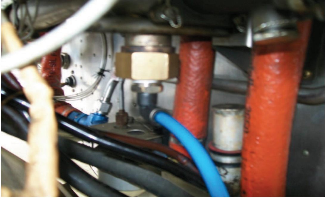
Figura 1.C Acoplamiento a la entrada de aire de sangrado Fuente: Investigación de campo
