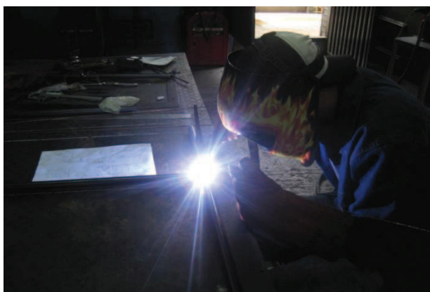
Figura 3.5 Proceso de soldadura aplicado a unir las partes de la estructura Fuente: Investigación de campo.
