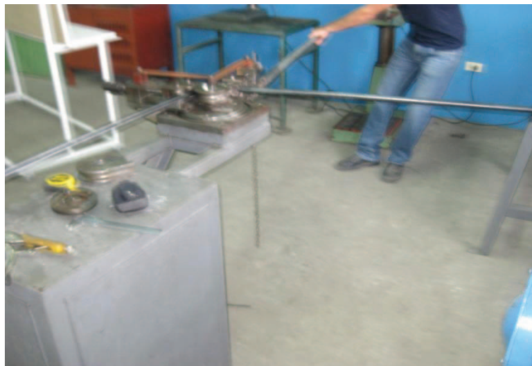
Figura 3.4 Proceso de doblado Fuente: Investigación de campo.
