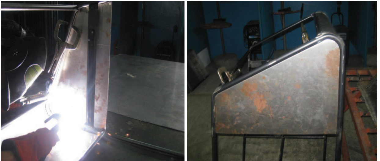
Figura 3.7 Proceso de soldadura y unión de la tapa lateral a la estructura metálica Fuente: Investigación de campo.
