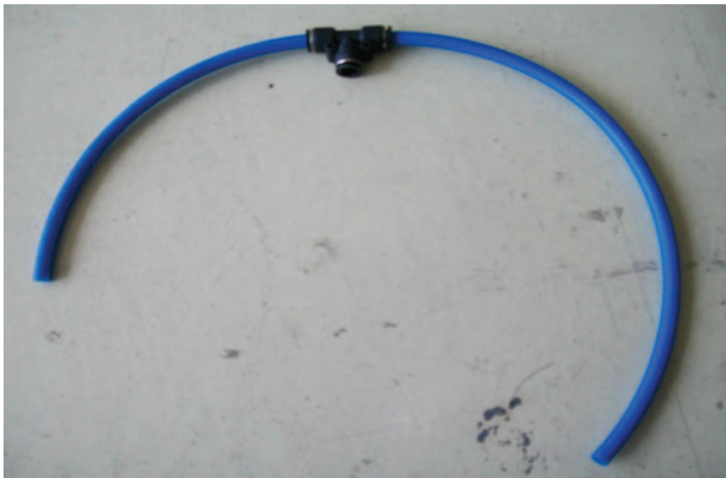
Figura 8.C Conjunto de manguera y unión tipo T para test del neumostato Fuente: Investigación de campo
