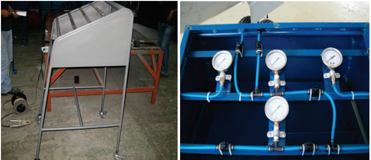
Figura 3.9 Proceso de pintura y ensamblaje completo del banco de pruebas Fuente: Investigación de campo.
