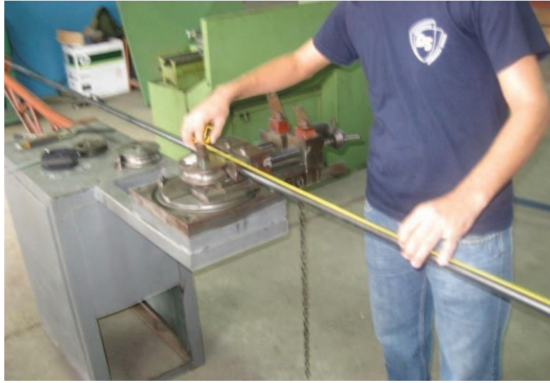
Figura 3.3 Medición del tubo para cortarlo y luego doblarlo Fuente: Investigación de campo.
