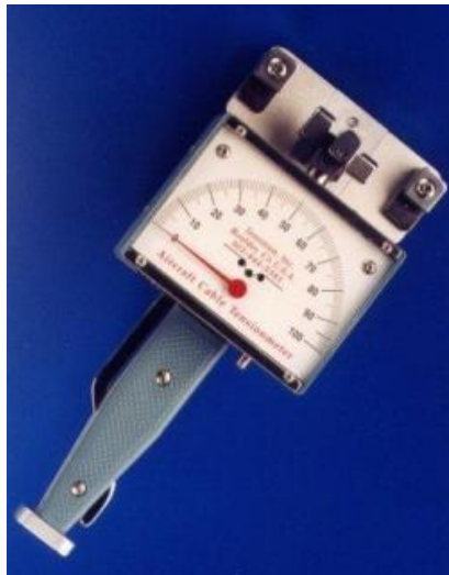
FIG. 3.2 TENSÍOMETRO TENSITRON ACM-200
