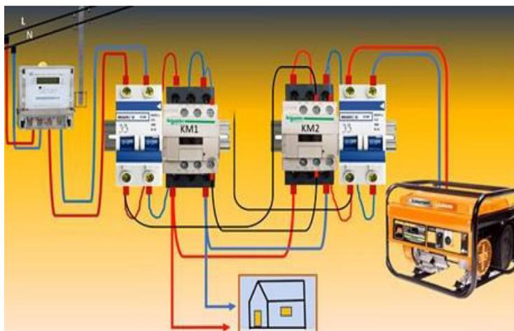
*Nota.* En la figura 1, se muestra la información acerca del diagrama de transferencia automática de energía. Tomado de (Cruz D. S., 2020).
