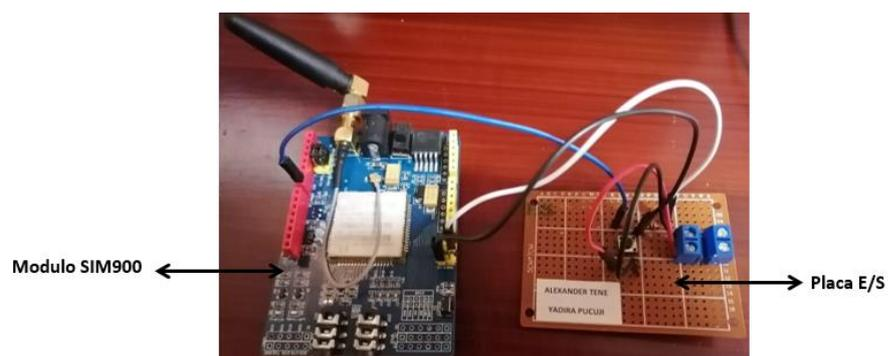
*Nota.* En esta imagen se muestran las conexiones del módulo SIM900 a la placa prueba de Entrada y Salida.
