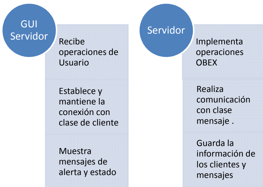
Figura 5.13. Esquema de las clases de trabajo del servidor en la aplicación de mensajería.
