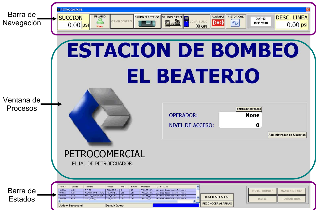
Figura. 2.10. Ambientes de la HMI
