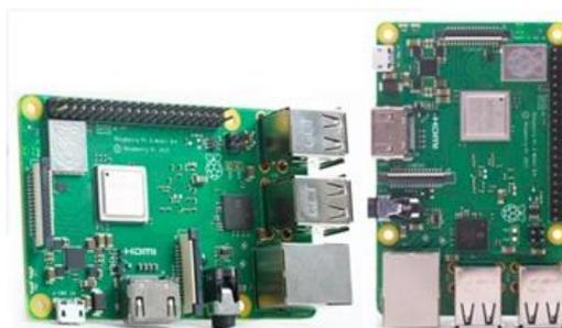
*Nota.* En el siguiente gráfico se puede observar la entrada de la cámara los puertos USB pines analógicos y digitales entrada de audio como la entrada del HMI.
