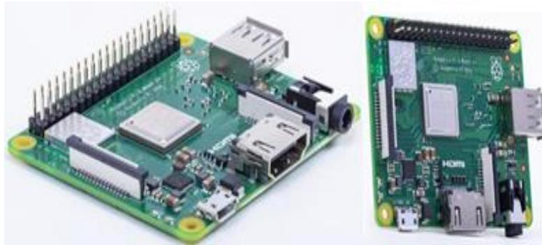
*Nota.* En la siguiente imagen se observa los puertos de entrada y salida que cuenta la Raspberry Pi 3 Modelo A.
