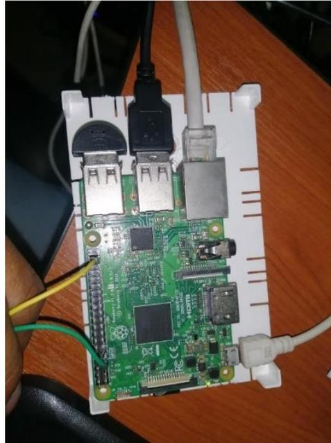
*Nota.* Ya instalada la Raspberry Pi en la carcasa de plástico sujeta con silicona.
