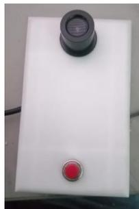
*Nota.* La carcasa está en base de plástico que es flexible para poder hacer orificios e instalar los componentes necesarios.
