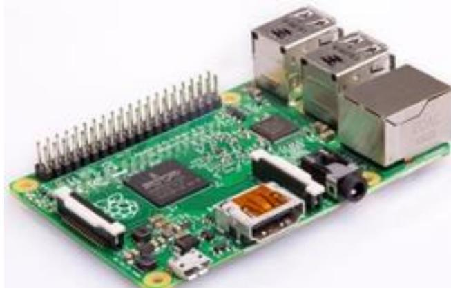
*Nota.* En el gráfico se puede observar la placa de la Raspberry Pi 2 Modelo B con entradas USB, también sus pines de entradas y salidas.
