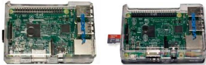
*Nota.* Instalado el sistema operativo en la tarjeta de memoria procedemos a introducir en la Raspberry Pi.
