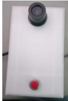
*Nota.* Una vez ya instalada la cámara con el pulsador en la carcasa está de conectar todos los componentes de la cámara como del pulsador.
