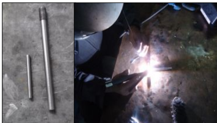
Figura 3.12. Proceso de construcción de la herramienta puller (PWC30128-02)
