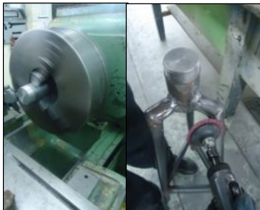
Figura 3.11. Proceso de acabado de la estructura base
