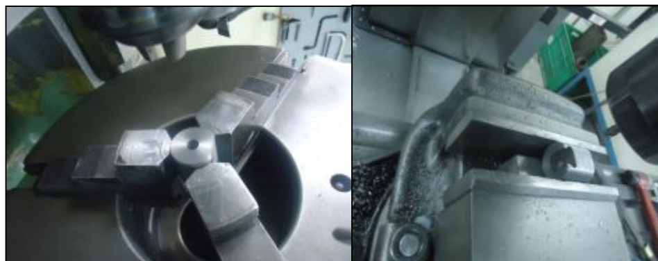
Figura 3.4. Fresado y acabado del cabezal dentado interno
