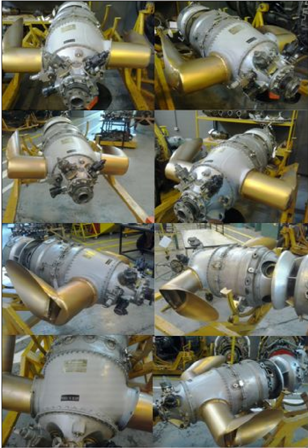
Figura 3.47 Motor PT6A-25 completo ubicado en el taller de motores de la UGT
