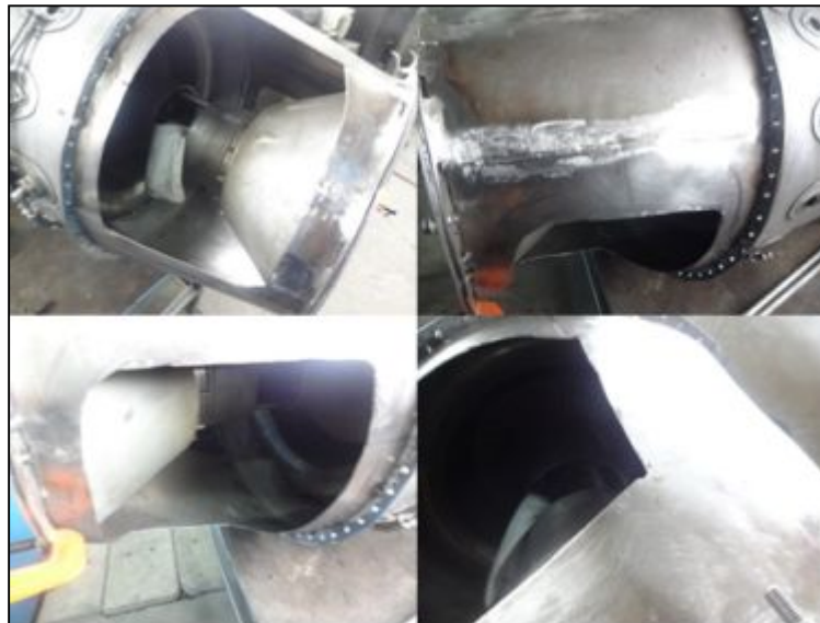
Figura 3.16 Orificios cortados en el case para los ductos
