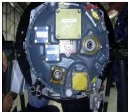
Figura 2.11 Cubierta de la caja de engranajes
