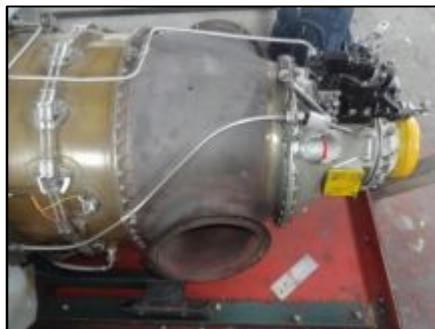
Figura 2.9 Conducto de escape
