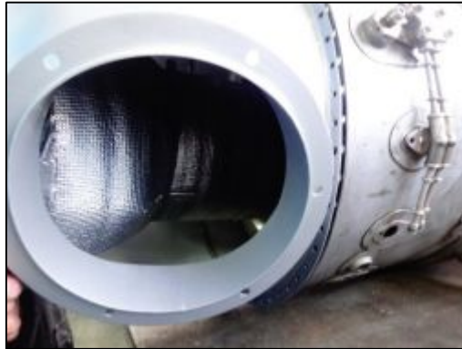
Figura 3.43 Montaje del Exhaust duct Case con la caja de reducción en el motor
