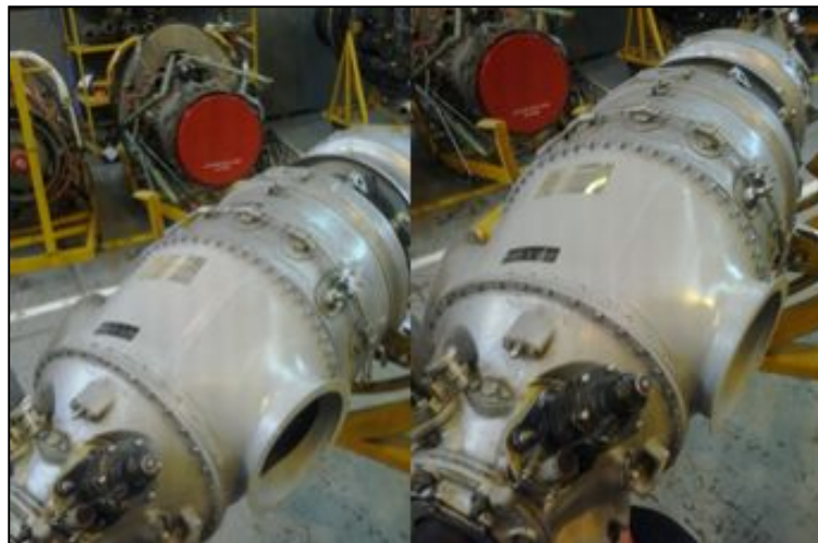
Figura 3.46 Implementación del Case de la sección de escape en el motor PT6A-25
