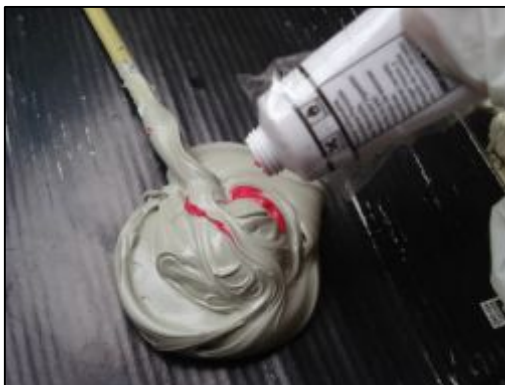
Figura 2.42 Mezcla de masilla y endurecedor
