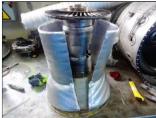
Figura 3.37 Instalación la Insulation blanket
