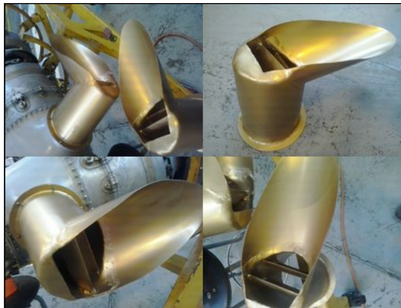
Figura 3.45 Ductos de escape
