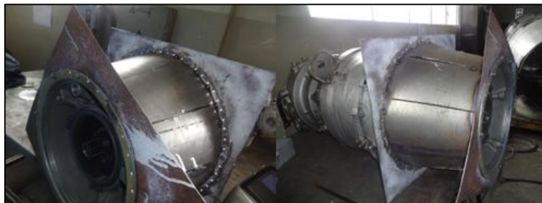
Figura 3.10 Ensamble de los anillos del case
