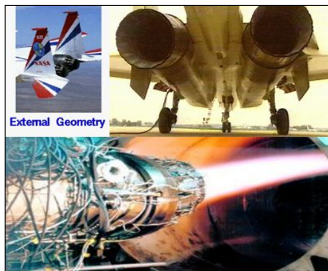
Figura 2.18 Tobera de geometría variable
