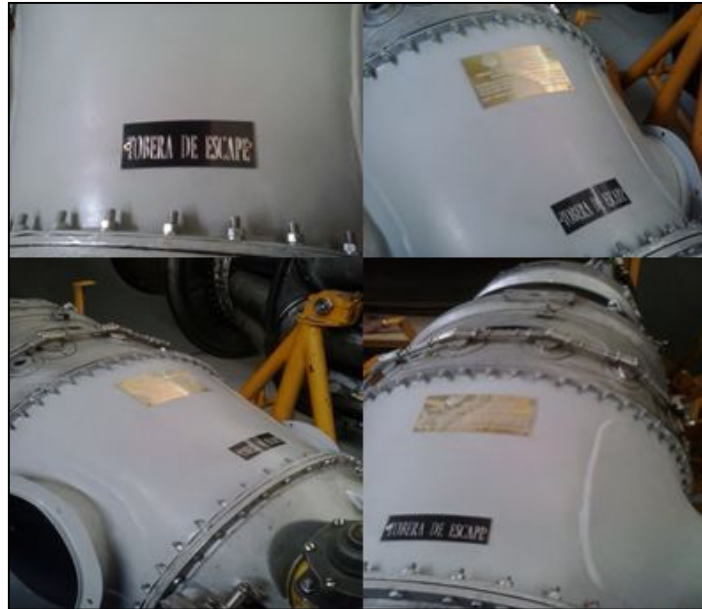
Figura 3.44 Colocación de pernos e instalación del Exhaust duct Case en el motor
