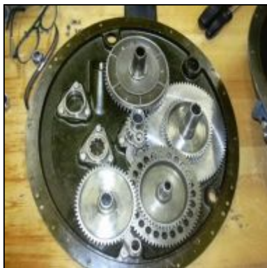
Figura 2.12 Engranajes de la caja de reducción
