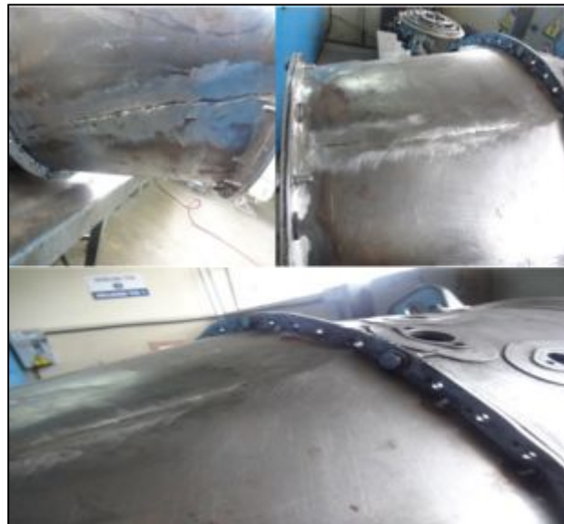
Figura 3.13 Anillo frontal y posterior cortados
