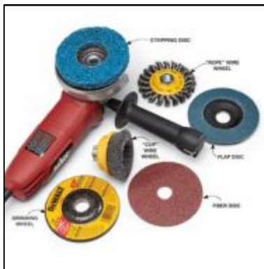
Figura 2.29 La amoladora y sus tipos de discos
