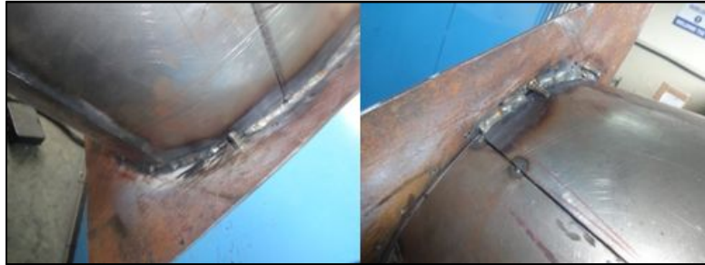
Figura 3.9 Ensamble de los anillos del case
