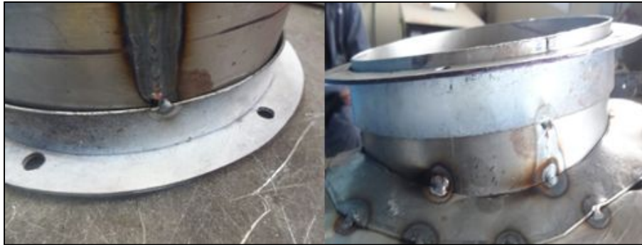
Figura 3.15 Ensamblaje de los anillos de los ductos en los ductos
