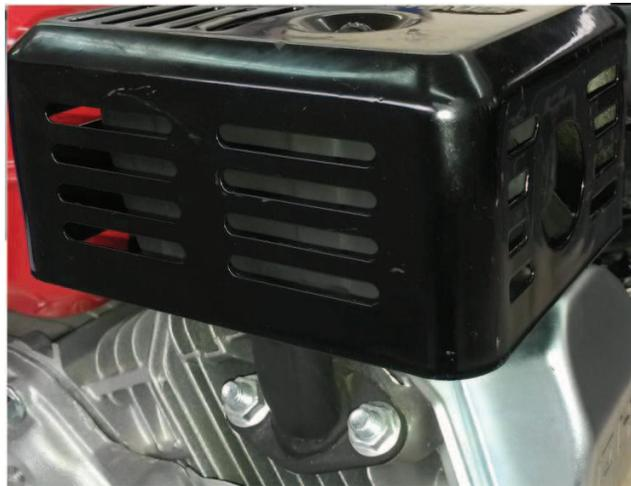
Figura 16. Instalación del silenciador
