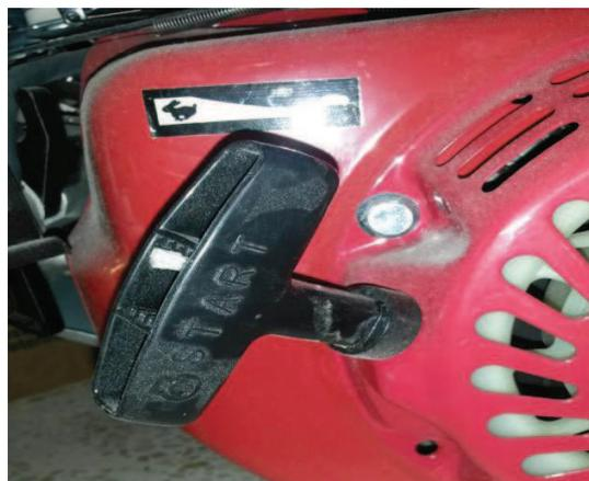
Figura 4. Manigueta de Encendido
