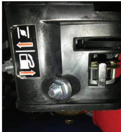
Figura 4. Válvula de paso y choque
