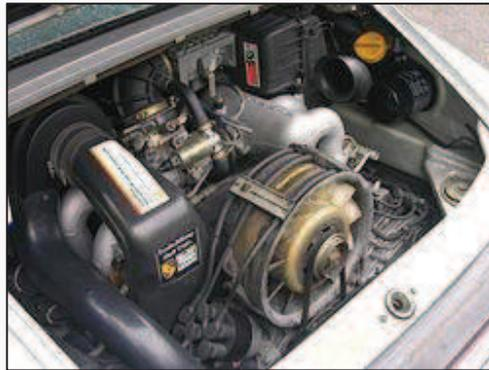
Figura 2.5. Ventilador del sistema de refrigeración
