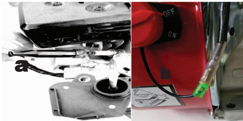
Figura 1. Desconexión de bujía / Cable del interruptor
