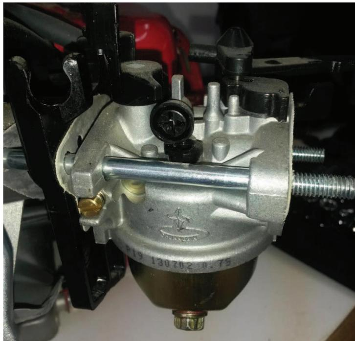
Figura 13. Instalación del carburador
