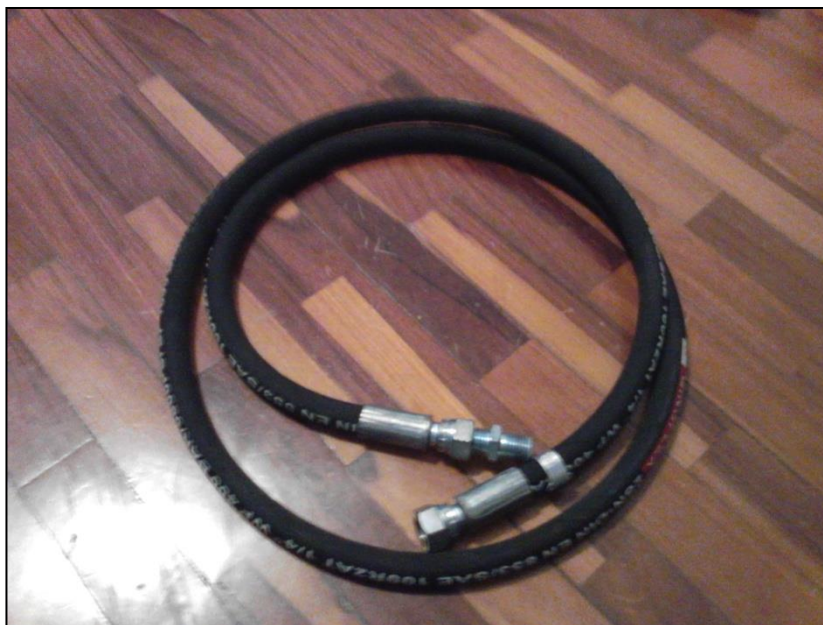
Figura 18. Manguera flexible del banco de prueba.
