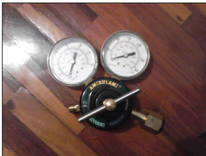
Figura 20. Regulador del banco de prueba.
