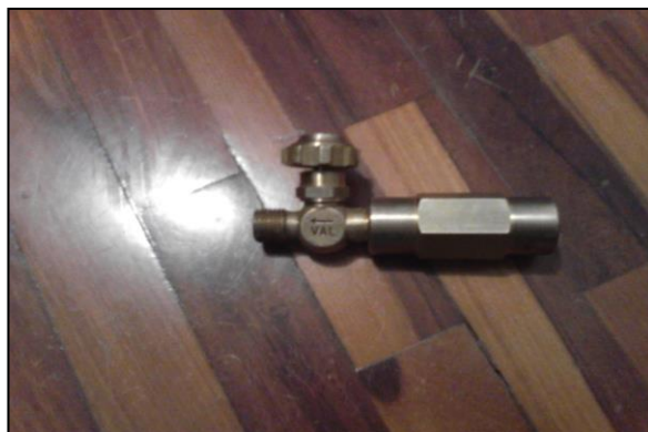
Figura 17. Válvula de corte del banco de prueba.
