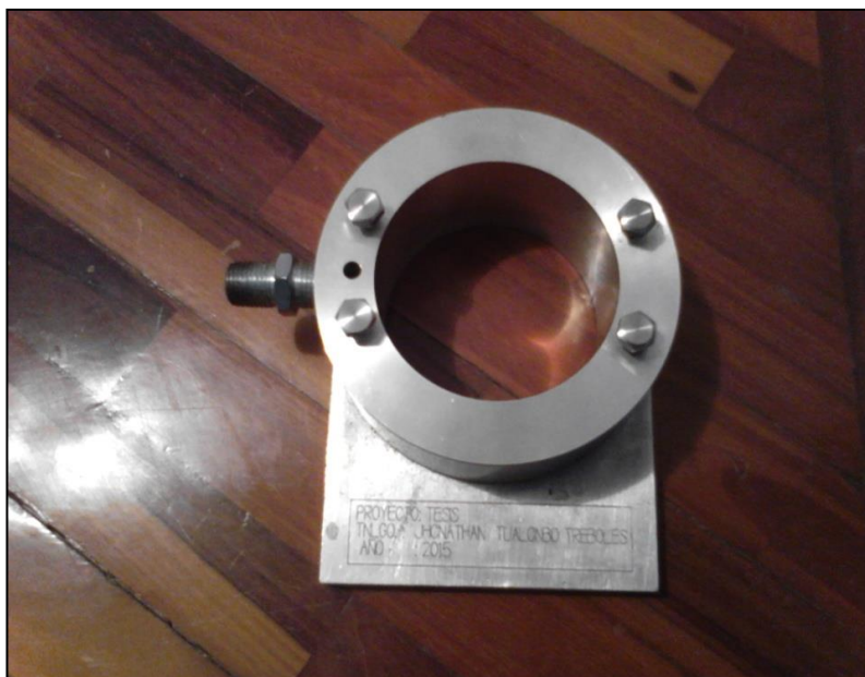
Figura 15. Soporte de la Bleed Valve
