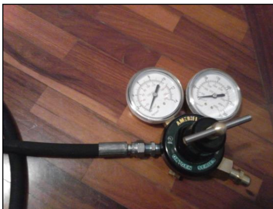
Figura 22. Instalación del regulador con la manguera de presión.
