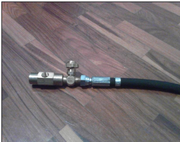
Figura 23. Instalación de la válvula de corte con la manguera de presión.
