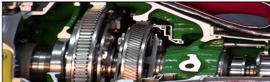
Figura 9. Caja de reducción turbina libre.
