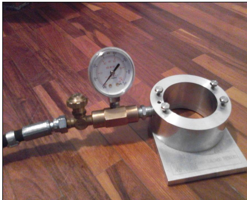
Figura 25. Instalación del manómetro con el soporte.
