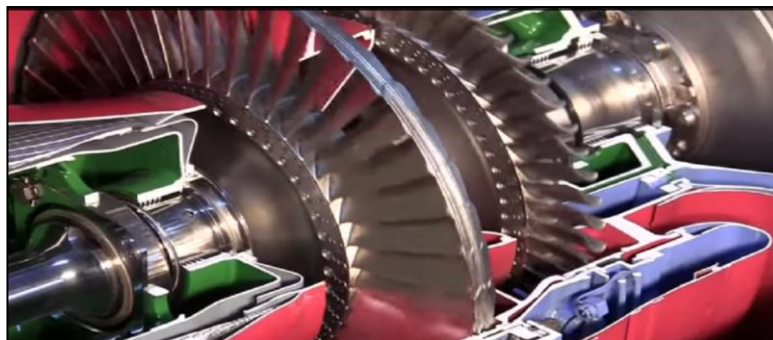
Figura 7. Turbina del compresor y de potencia
