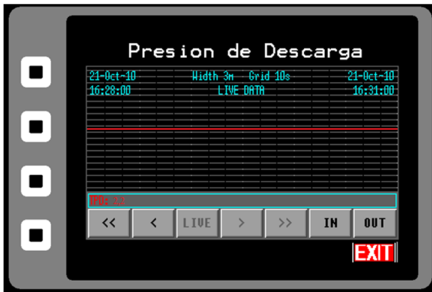
Figura 4.14: Registro de presión de descarga, operación individual
