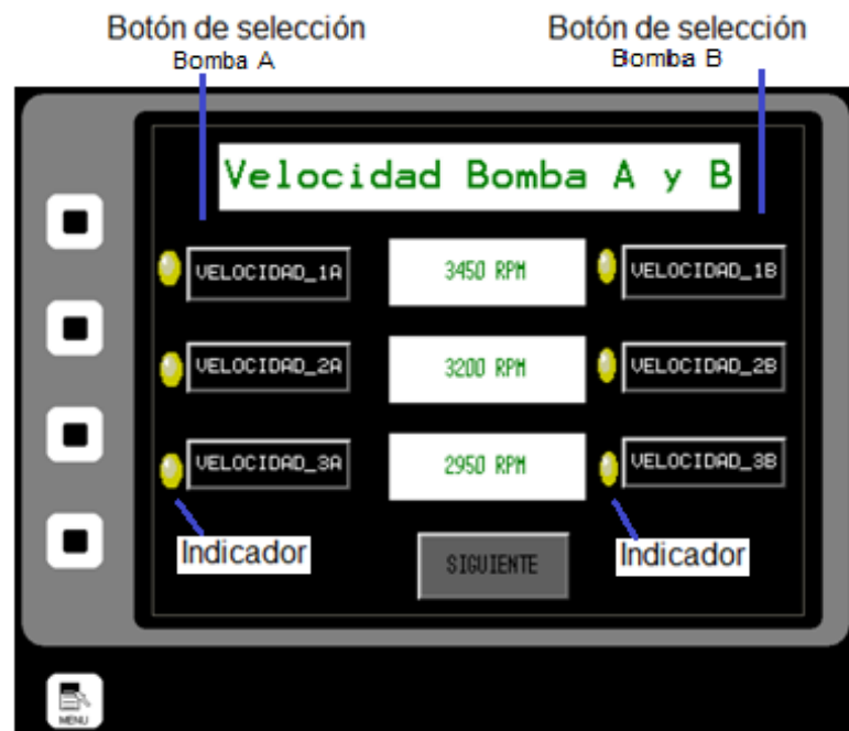
Figura 14. Selección de velocidad Bomba A y Bomba B.
